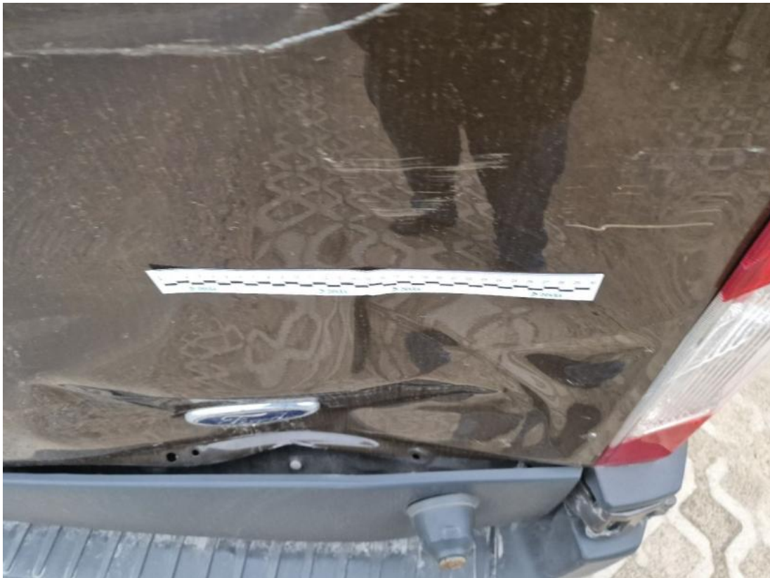
Fot. 49 Pokrywy bagażnika - Wgniecenie/odkształcenie 1
