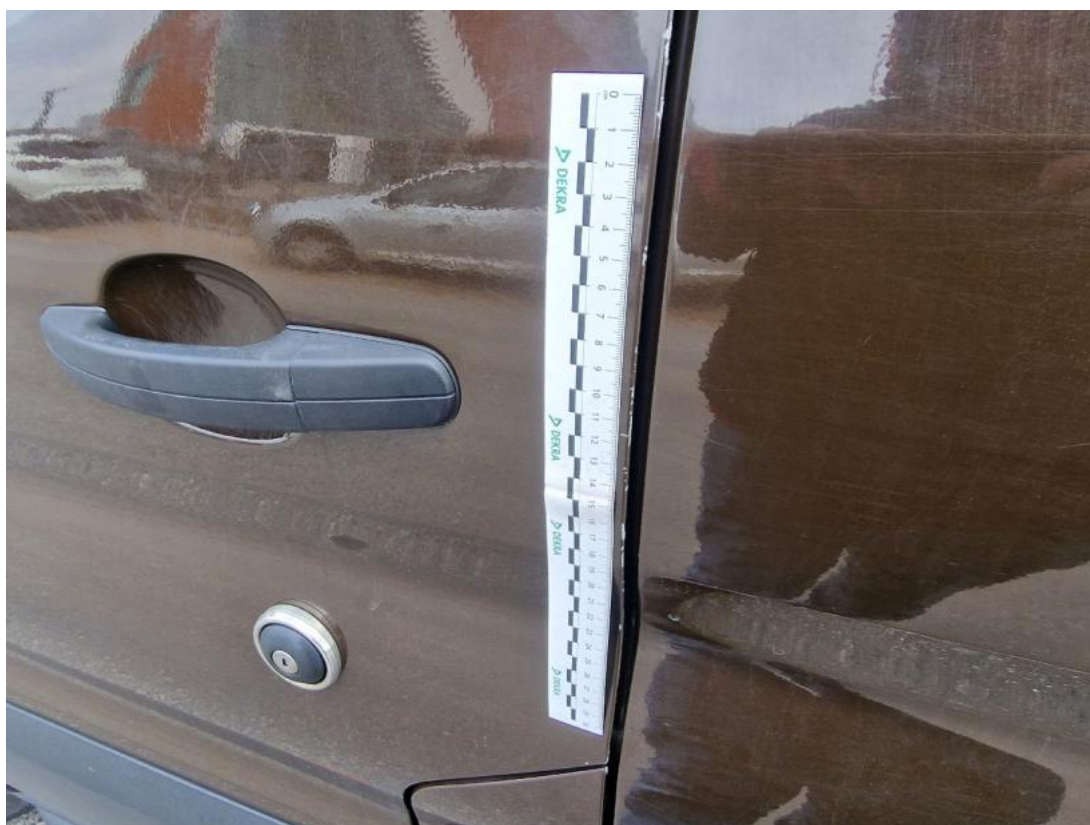
Fot. 61 Drzwi przed L - Rysa/odprysk 1
