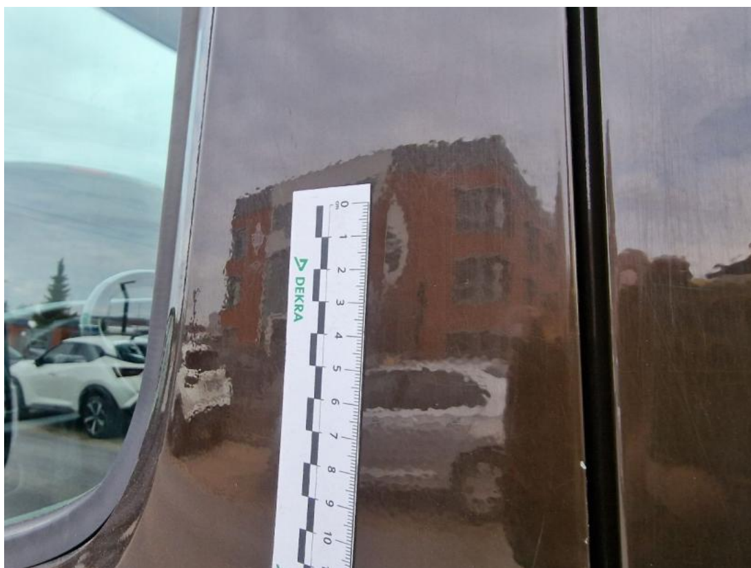
Fot. 62 Drzwi przed L - Wgniecenie/odkształcenie 1
