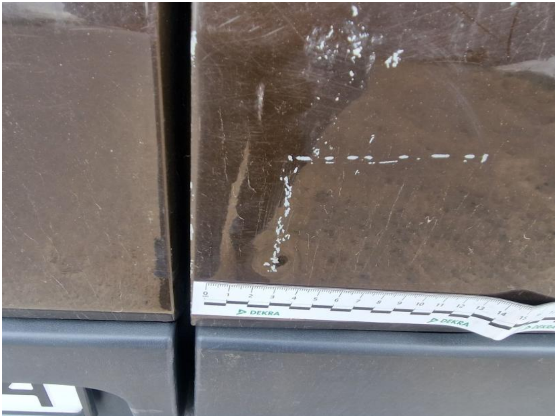
Fot. 53 Pokrywy bagażnika - Wgniecenie/odkształcenie 1
