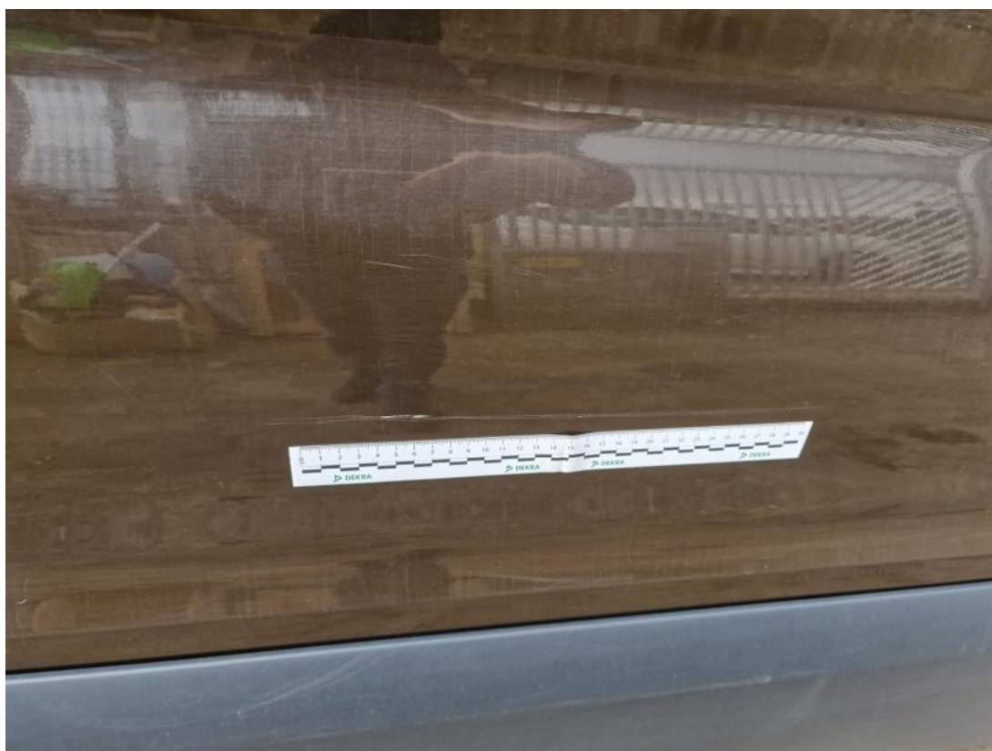
Fot. 42 Drzwi tylne P - Rysa/odprysk 1
