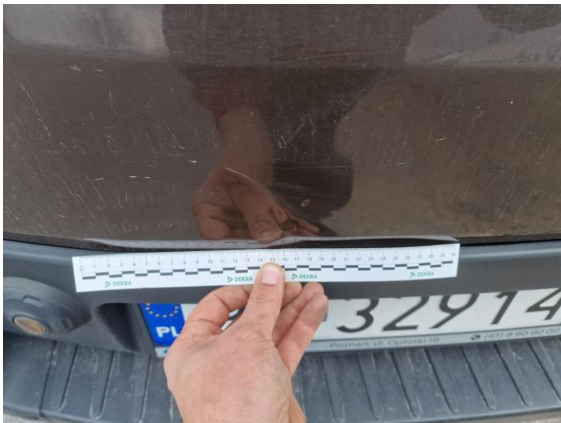
Fot. 55 Pokrywy bagażnika() - Wgniecenie/odkształcenie 3
