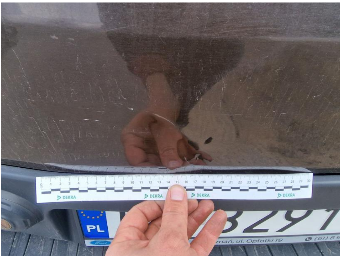
Fot. 54 Pokrywy bagażnika - Wgniecenie/odkształcenie 2
