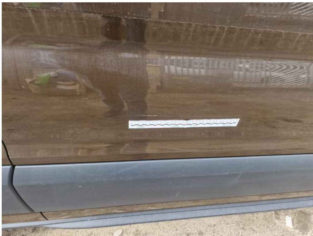
Fot. 45 Drzwi tylne P() - Wgniecenie/odkształcenie 3
