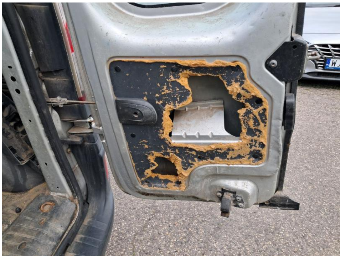
Fot. 83 Wykładzina pokrywy tylnej - Pęknięcie/rozerwanie 2
