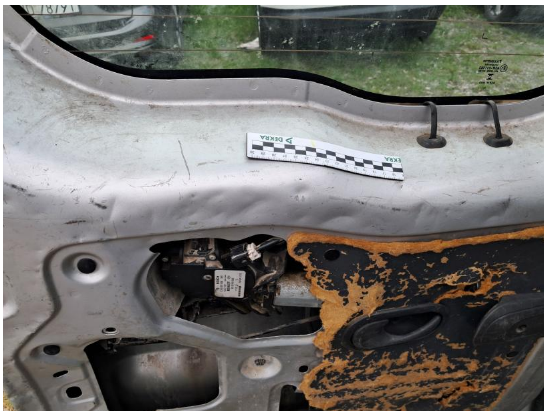
Fot. 84 Drzwi tyłu lewe - Wgniecenie/odkształcenie 1
