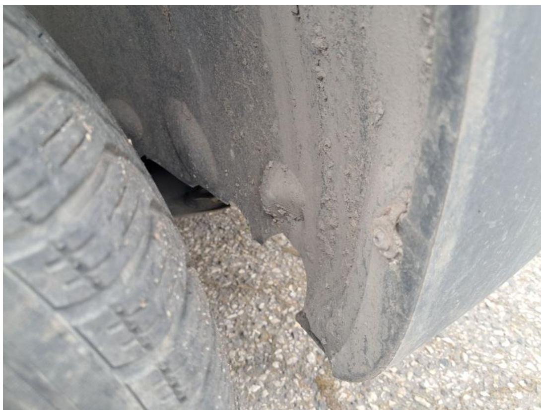
Fot. 42 Nadkole przednie P - Pęknięcie/rozerwanie 1
