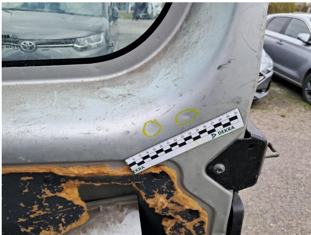
Fot. 85 Drzwi tyłu prawe - Wgniecenie/odkształcenie 1
