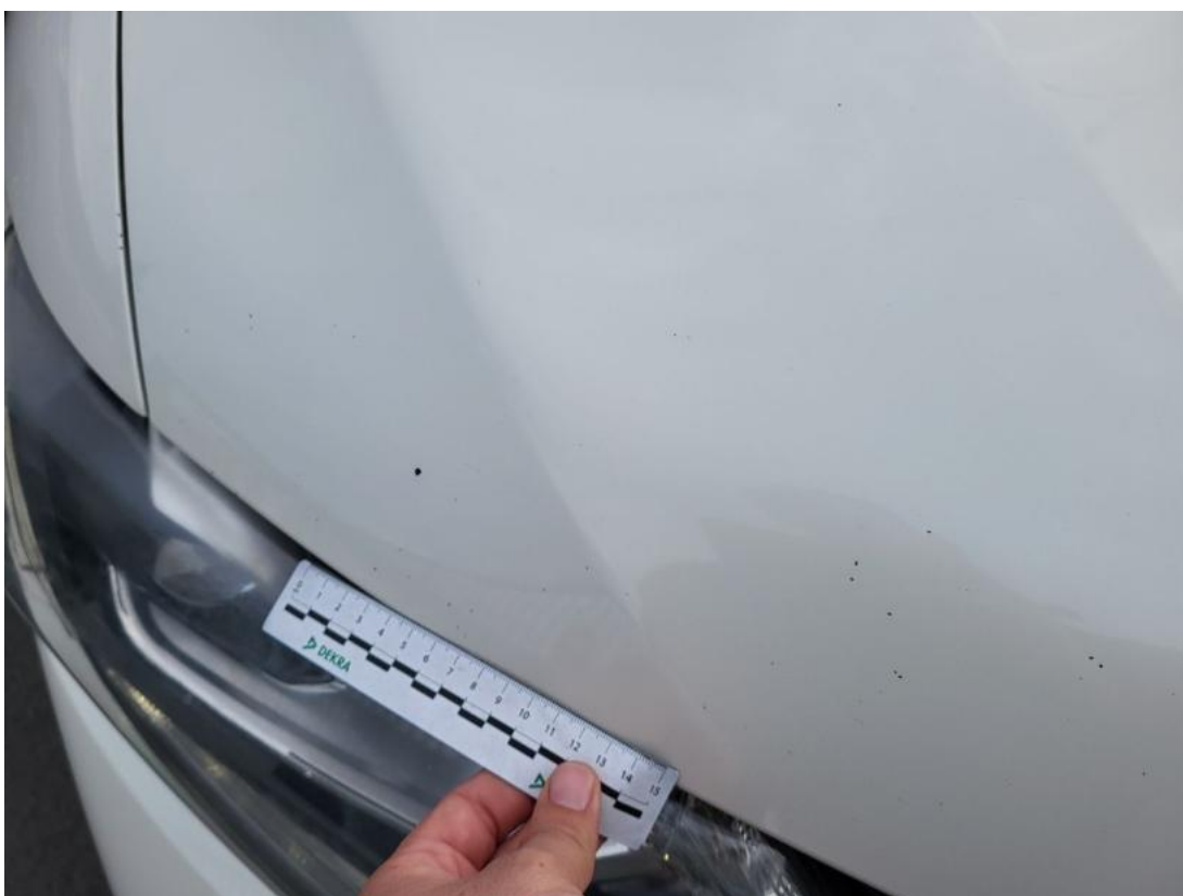
Fot. 38 Pokrywa komory silnika - Rysa/odprysk 2
