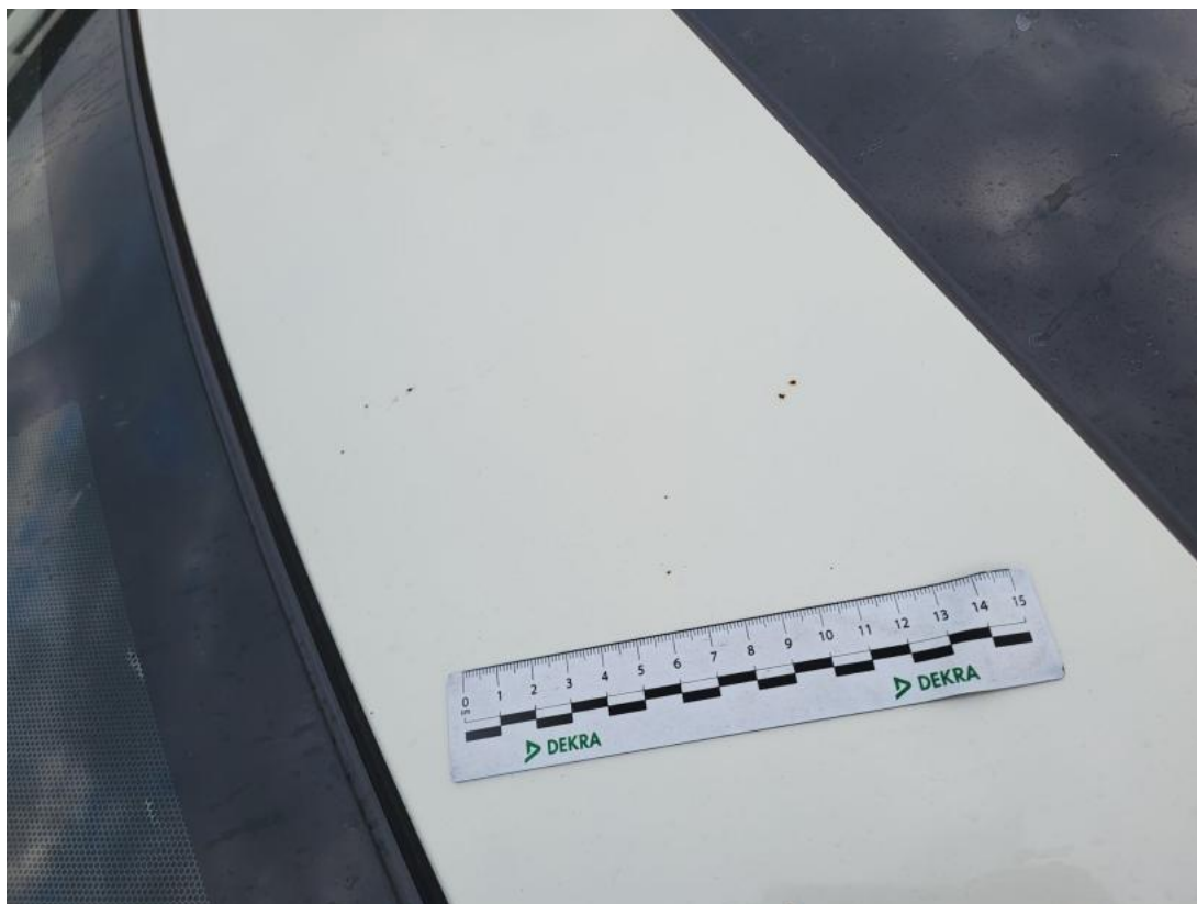
Fot. 45 Dach - Rysa/odprysk 1
