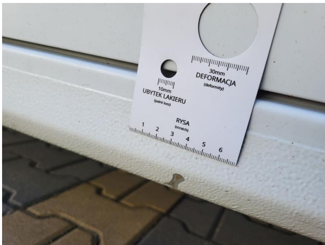
Fot. 46 Próg P() - Rysa/odprysk 3
