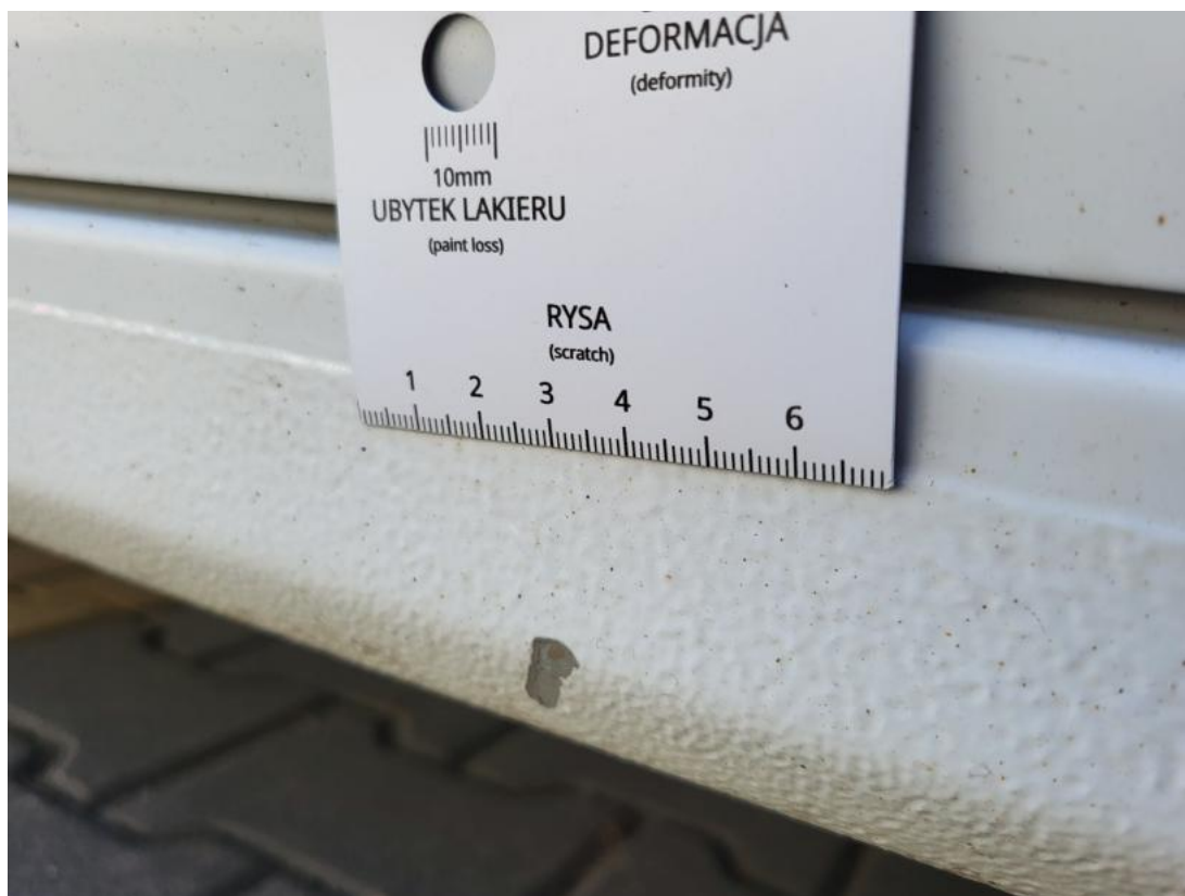
Fot. 45 Próg P - Rysa/odprysk 1
