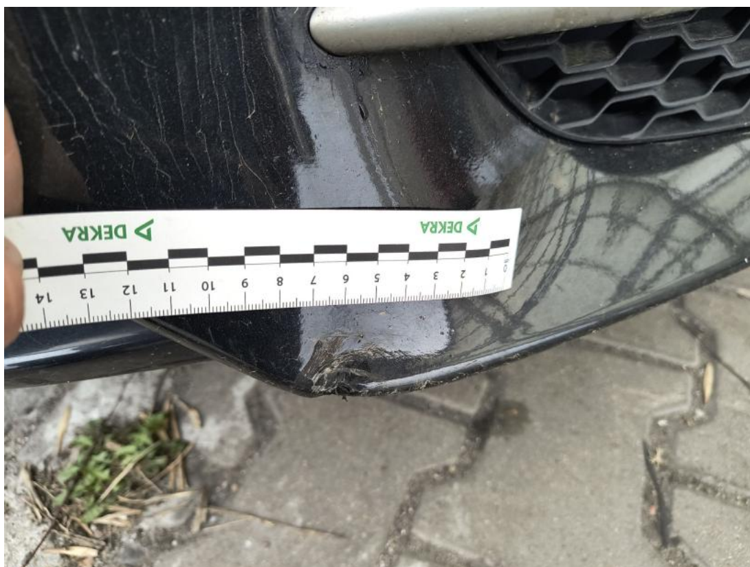
Fot. 38 Zderzak - Wgniecenie/odkształcenie 1
