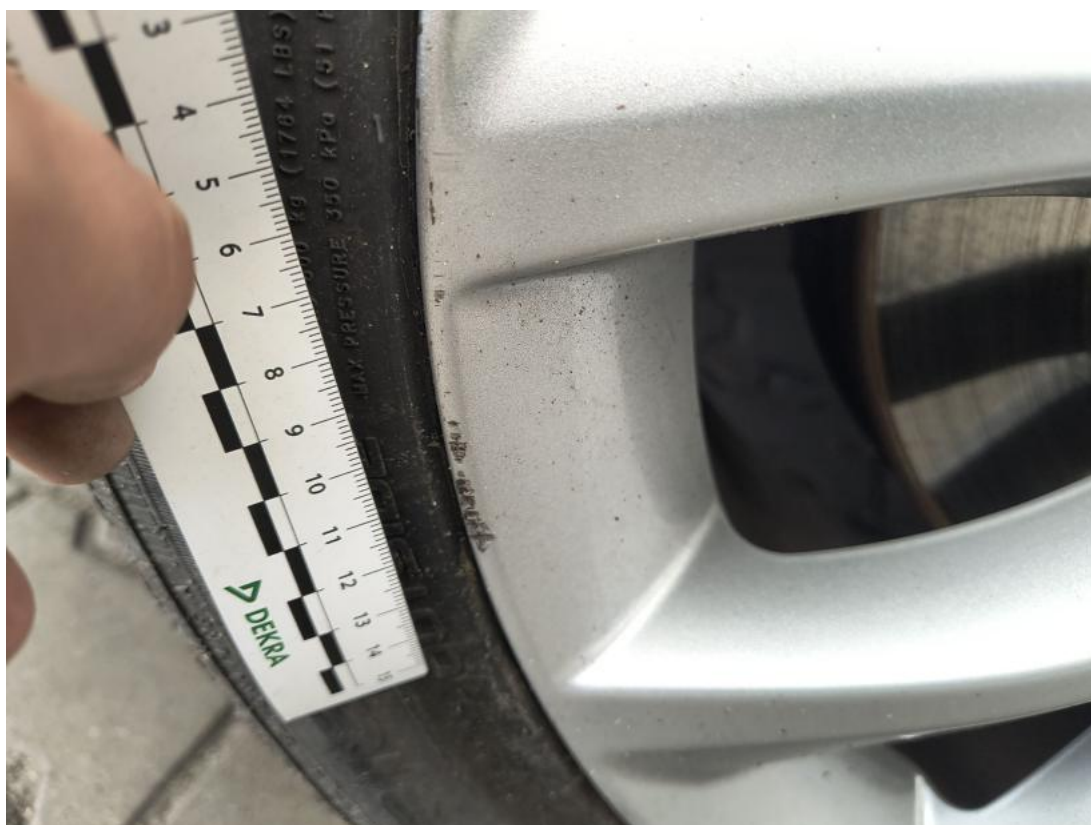
Fot. 48 Felga Aluminiowa przednia L - Rysa/odprysk 1
