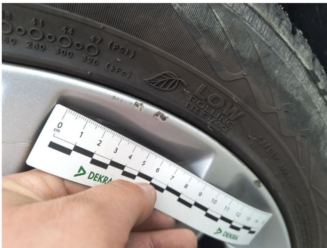
Fot. 49 Felga Aluminiowa przednia L - Rysa/odprysk 2
