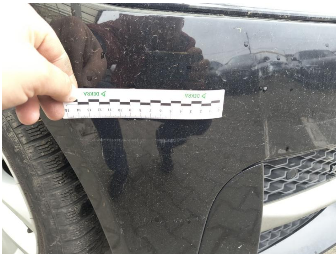
Fot. 37 Zderzak - Rysa/odprysk 1
