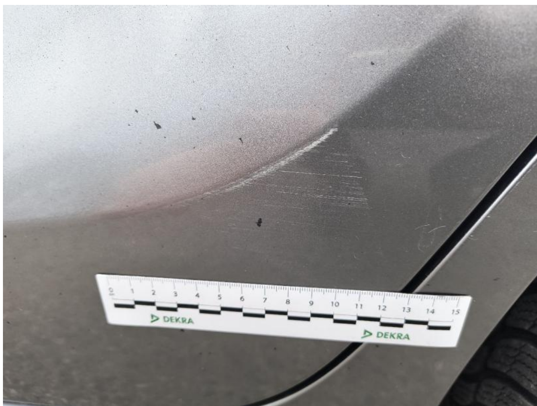
Fot. 60 Drzwi tylne L - Rysa/odprysk 2
