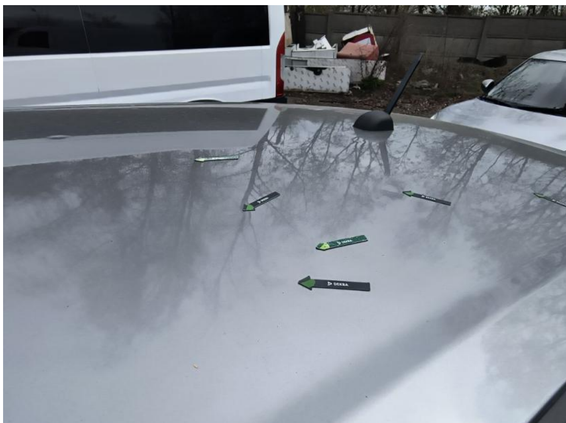
Fot. 52 Dach - Wgniecenie/odkształcenie 1
