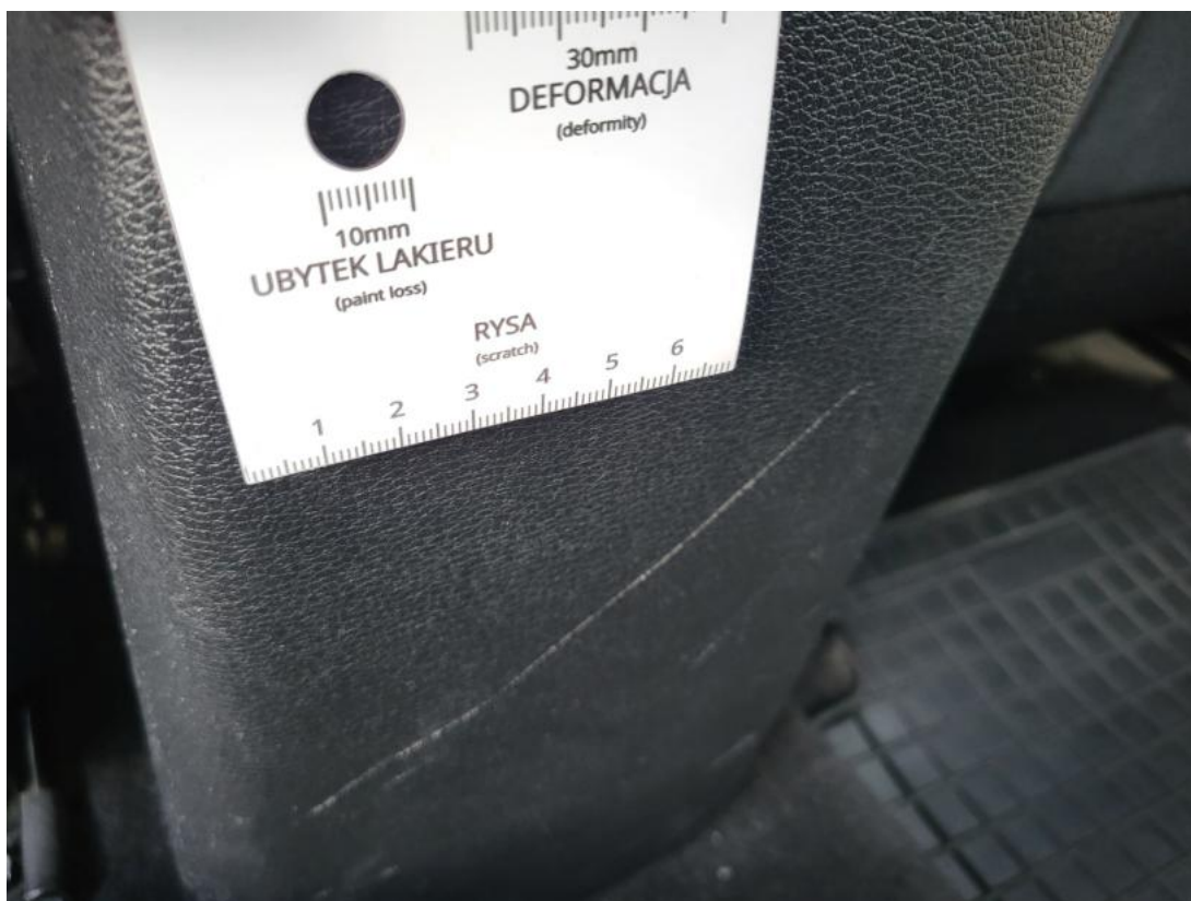
Fot. 46 Konsola środkowa - Rysa/odprysk 1
