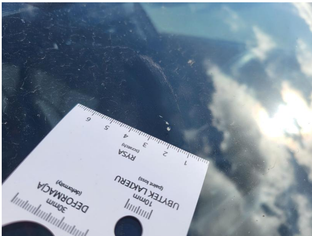
Fot. 37 Szyba czołowa - Rysa/odprysk 2
