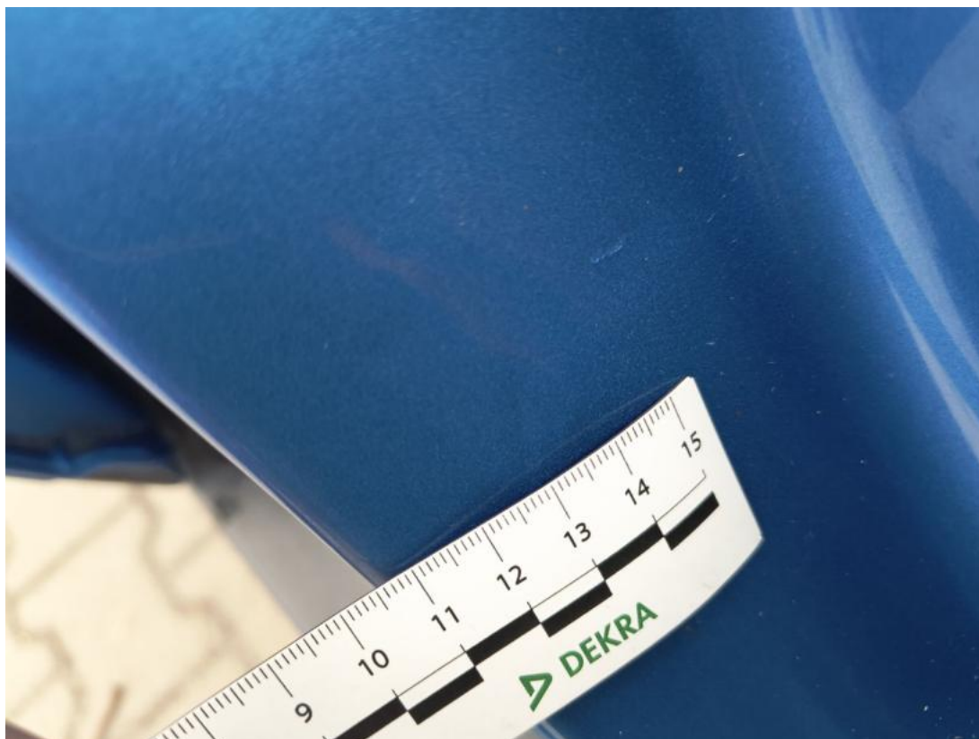
Fot. 43 Słupek środkowy P - Wgniecenie/odkształcenie 2
