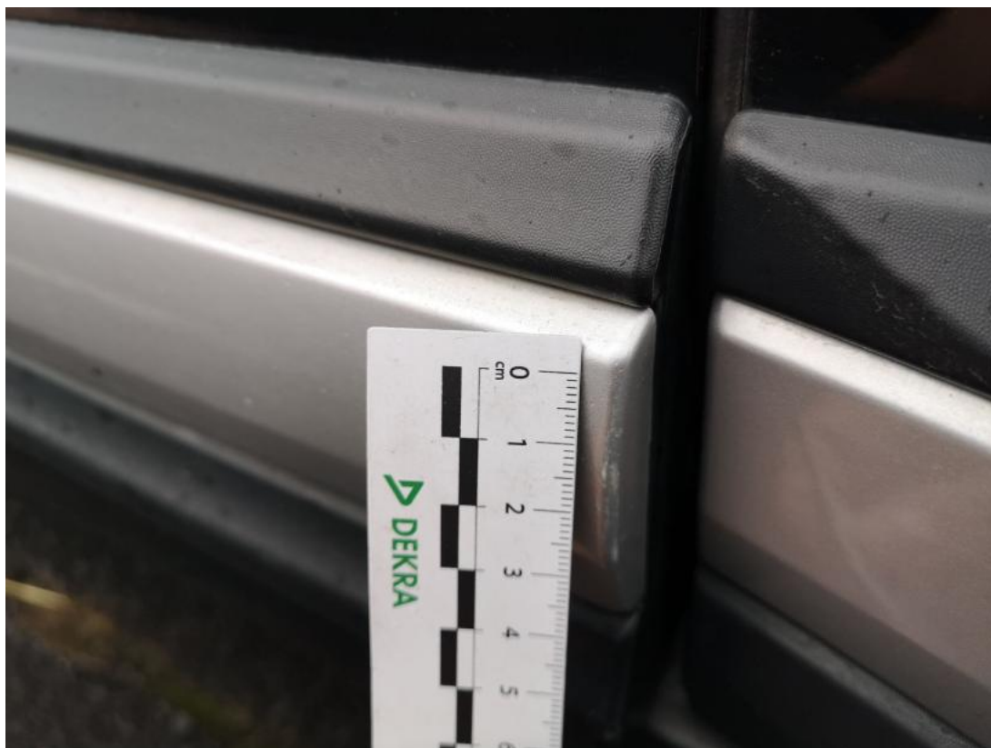
Fot. 75 Drzwi przed L - Wgniecenie/odkształcenie 2
