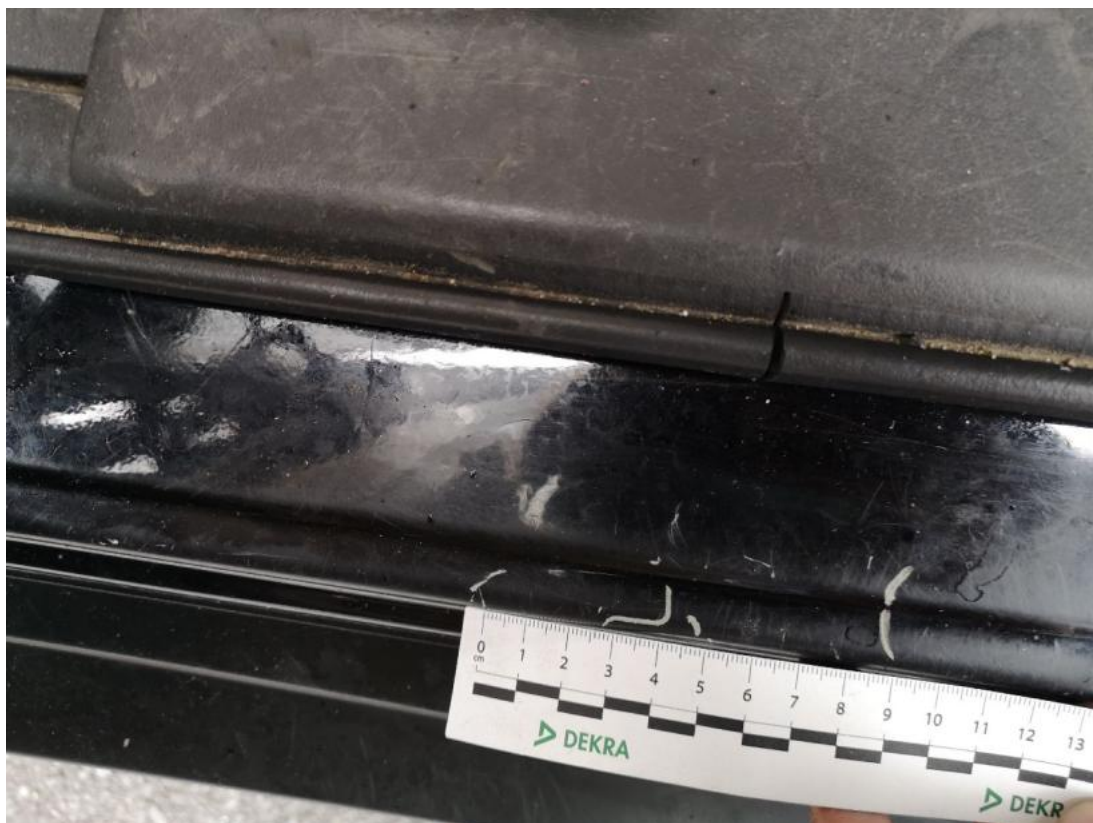
Fot. 83 Próg L - Rysa/odprysk 2
