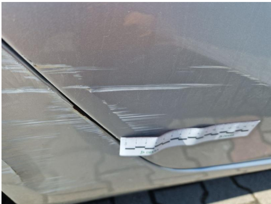
Fot. 49 Drzwi tylne P - Rysa/odprysk 1
