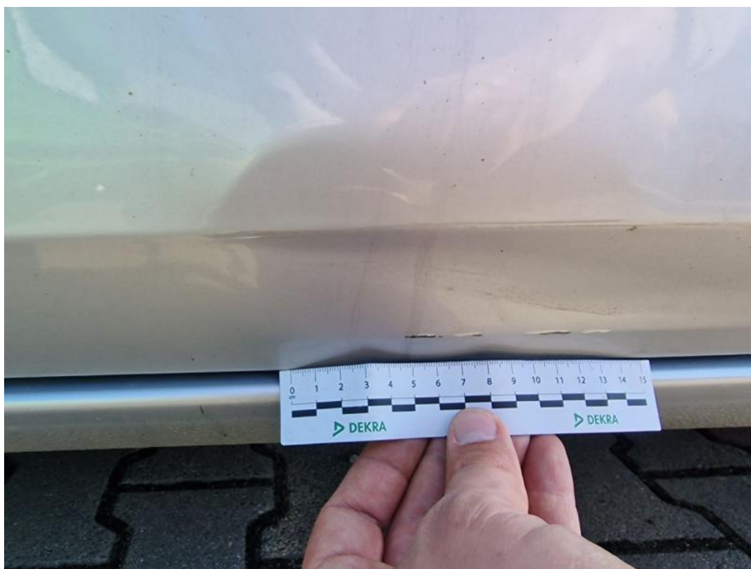
Fot. 68 Drzwi przed L() - Rysa/odprysk 3
