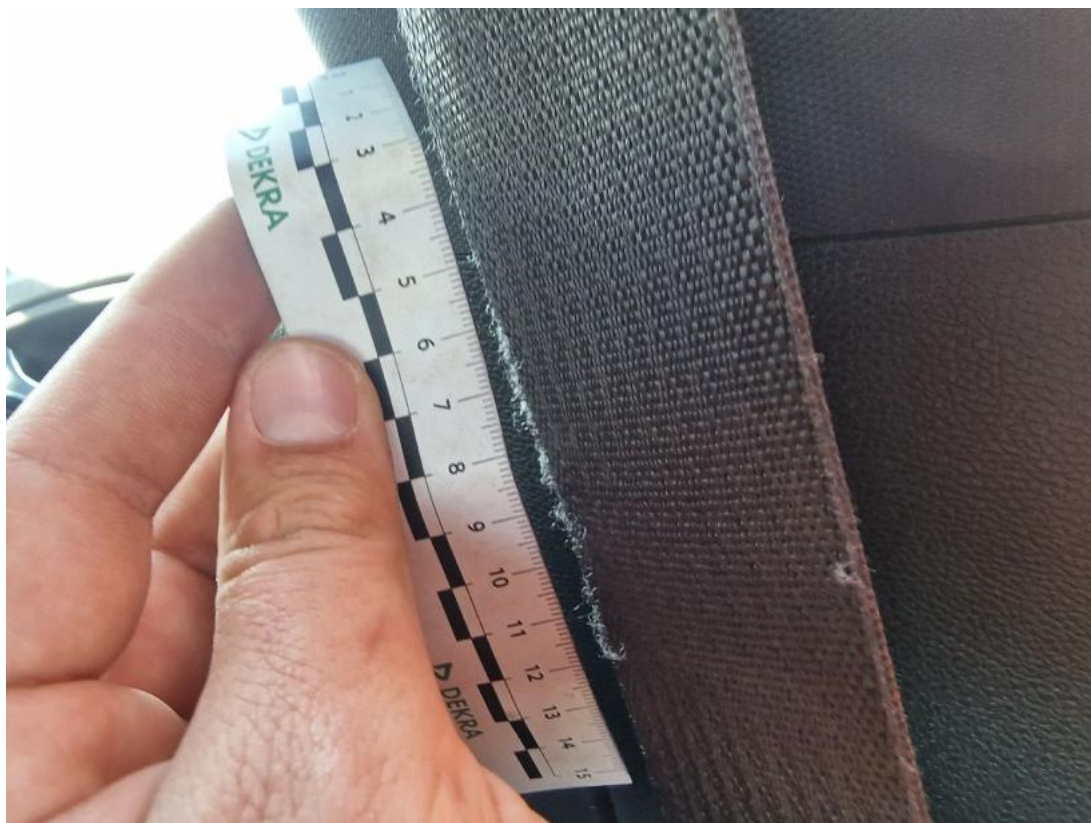
Fot. 83 Pas bezpieczeństwa przedni lewy - Rysa/odprysk 1
