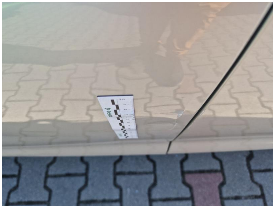
Fot. 69 Drzwi przed L - Wgniecenie/odkształcenie 1
