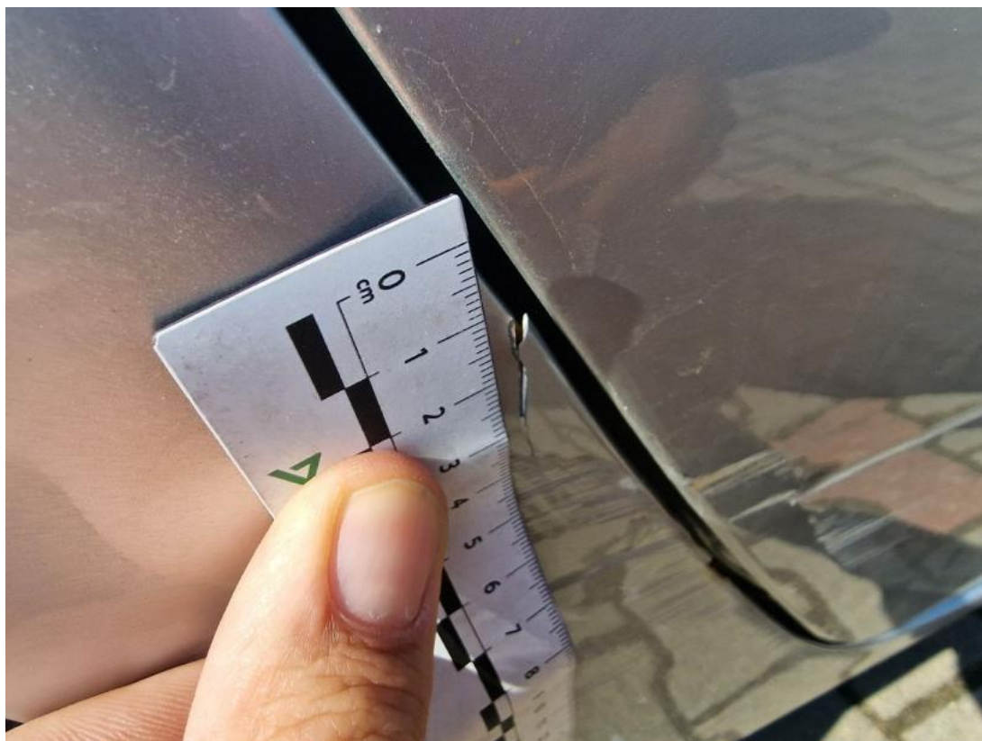
Fot. 55 Błotnik tylny P / Ściana boczna P - Pęknięcie/rozerwanie 1
