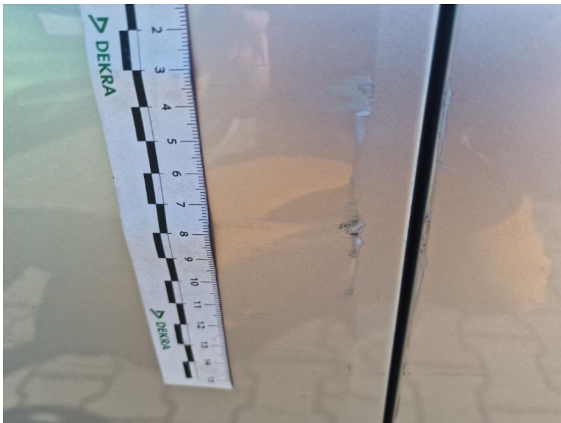
Fot. 67 Drzwi przed L - Rysa/odprysk 1
