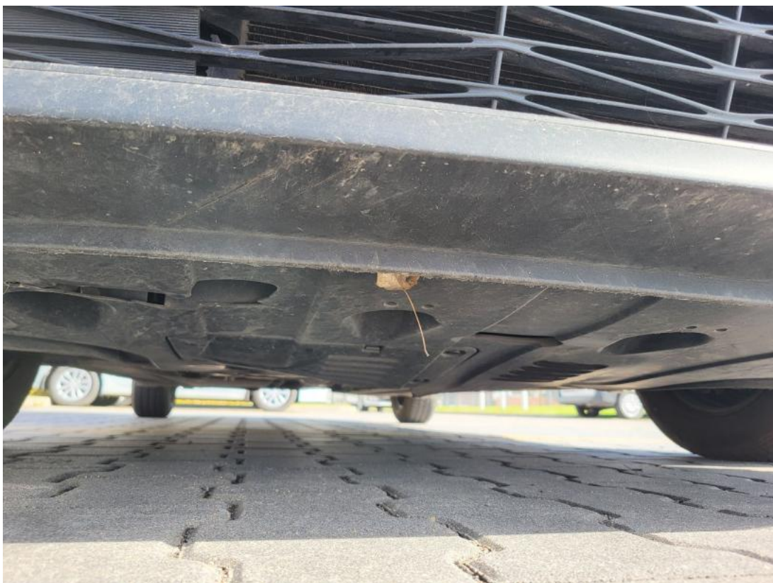
Fot. 35 Spoiler zderzaka przedniego - Rysa/odprysk 1
