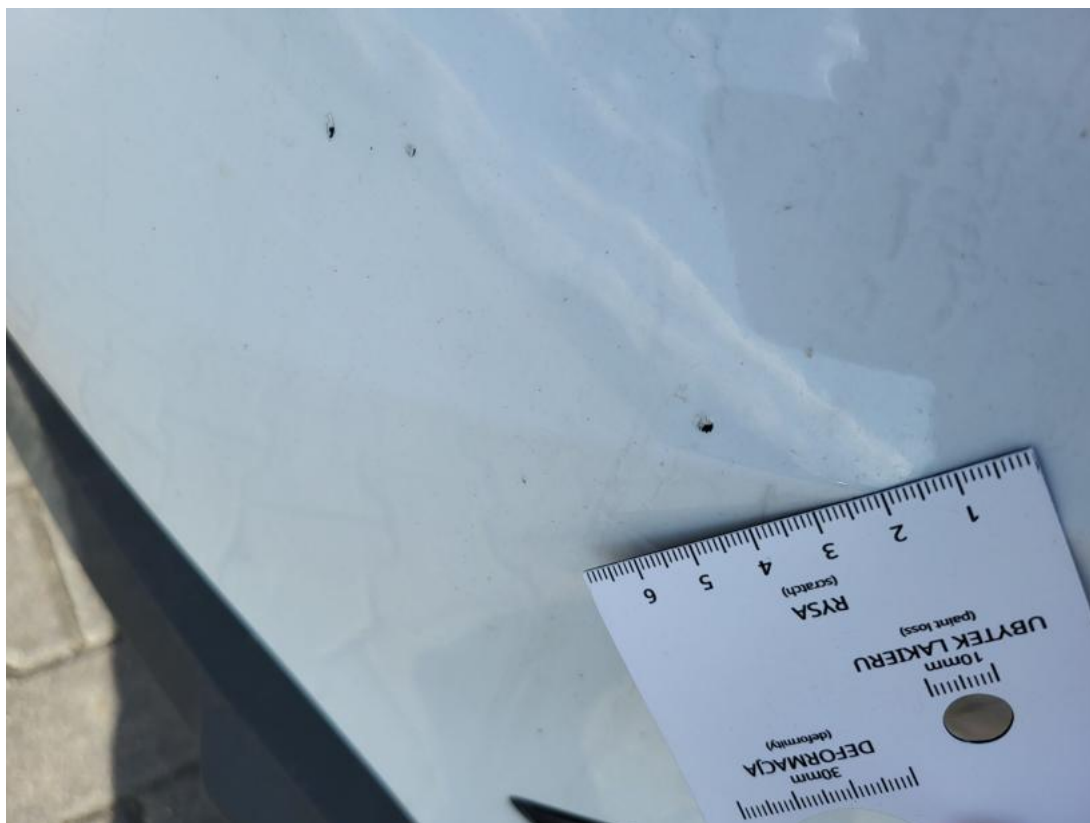
Fot. 37 Zderzak - Rysa/odprysk 1
