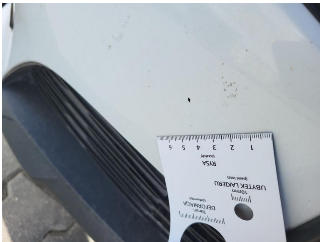
Fot. 38 Zderzak() - Rysa/odprysk 3
