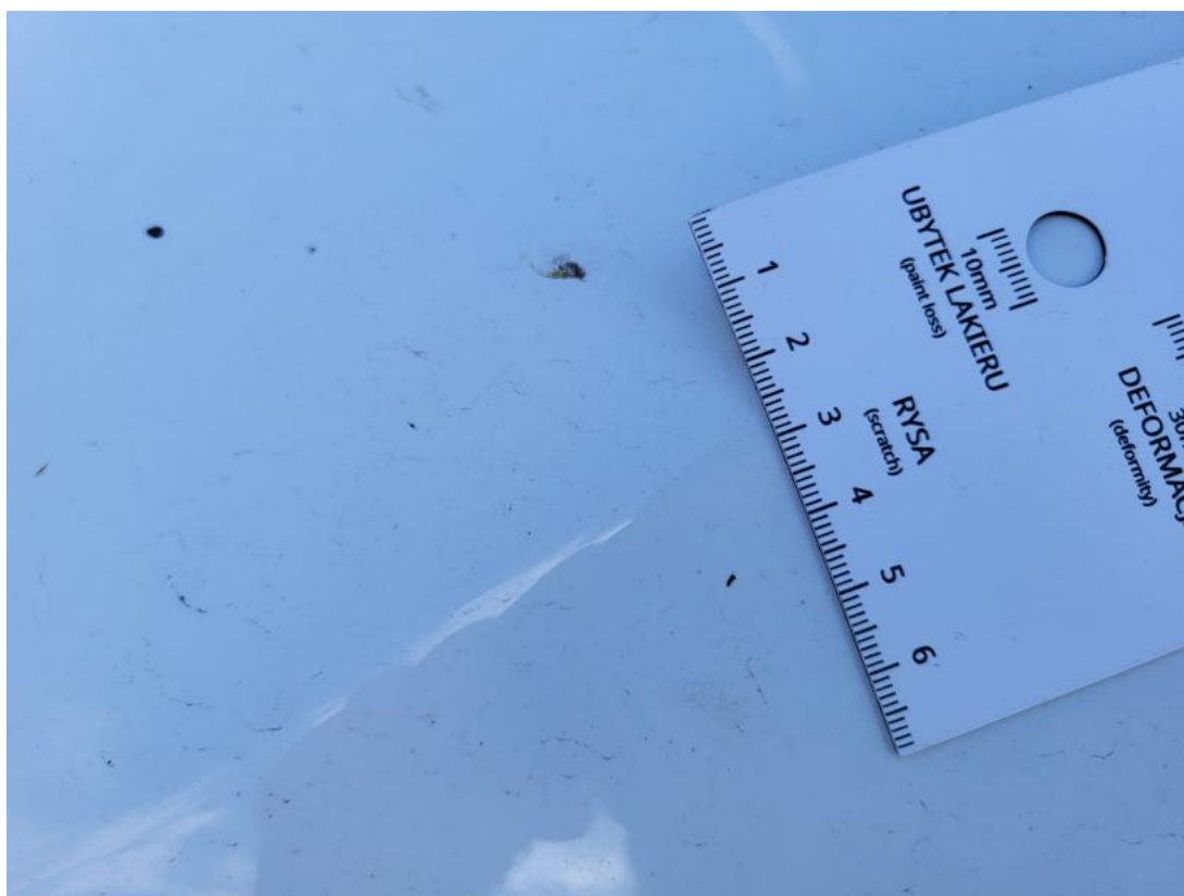
Fot. 34 Pokrywa komory silnika - Rysa/odprysk 1
