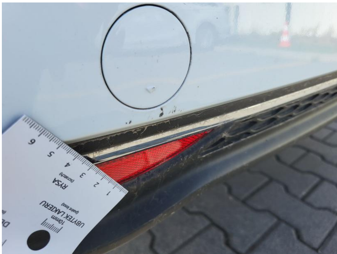
Fot. 41 Zderzak tylny - Rysa/odprysk 2
