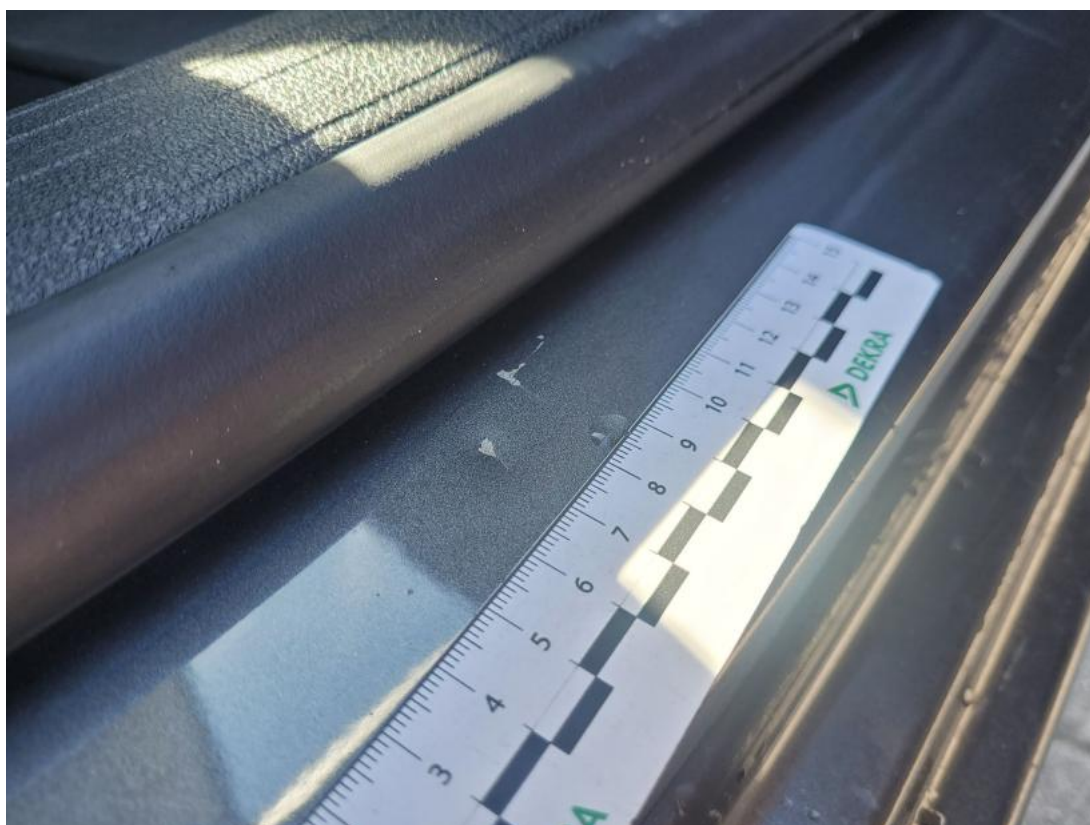
Fot. 42 Próg P - Wgniecenie/odkształcenie 1
