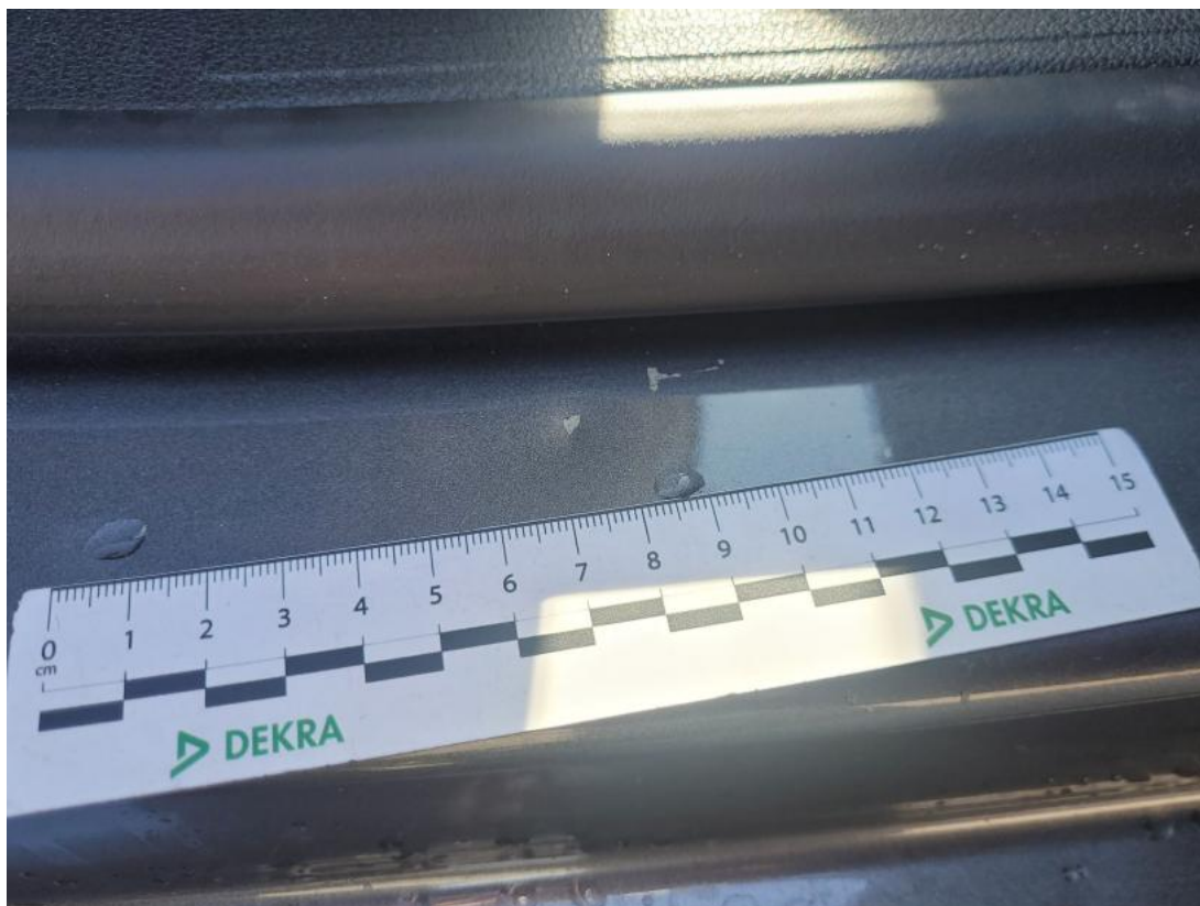
Fot. 41 Próg P - Rysa/odprysk 1
