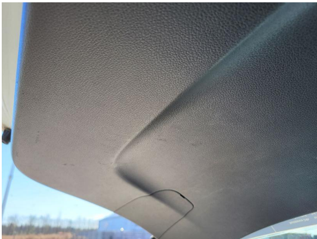
Fot. 43 Wykładzina pokrywy tylnej() - Rysa/odprysk 3
