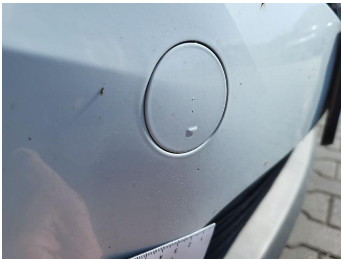
Fot. 36 Zderzak - Rysa/odprysk 2
