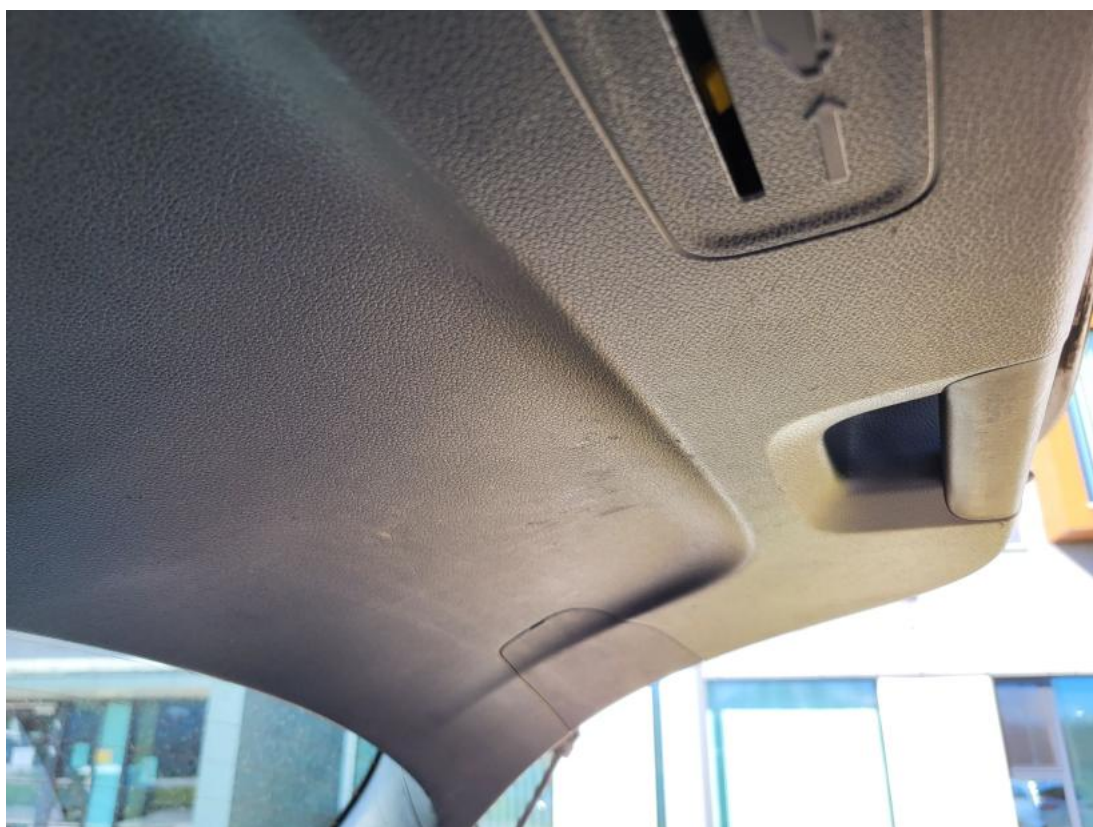
Fot. 42 Wykładzina pokrywy tylnej - Rysa/odprysk 1
