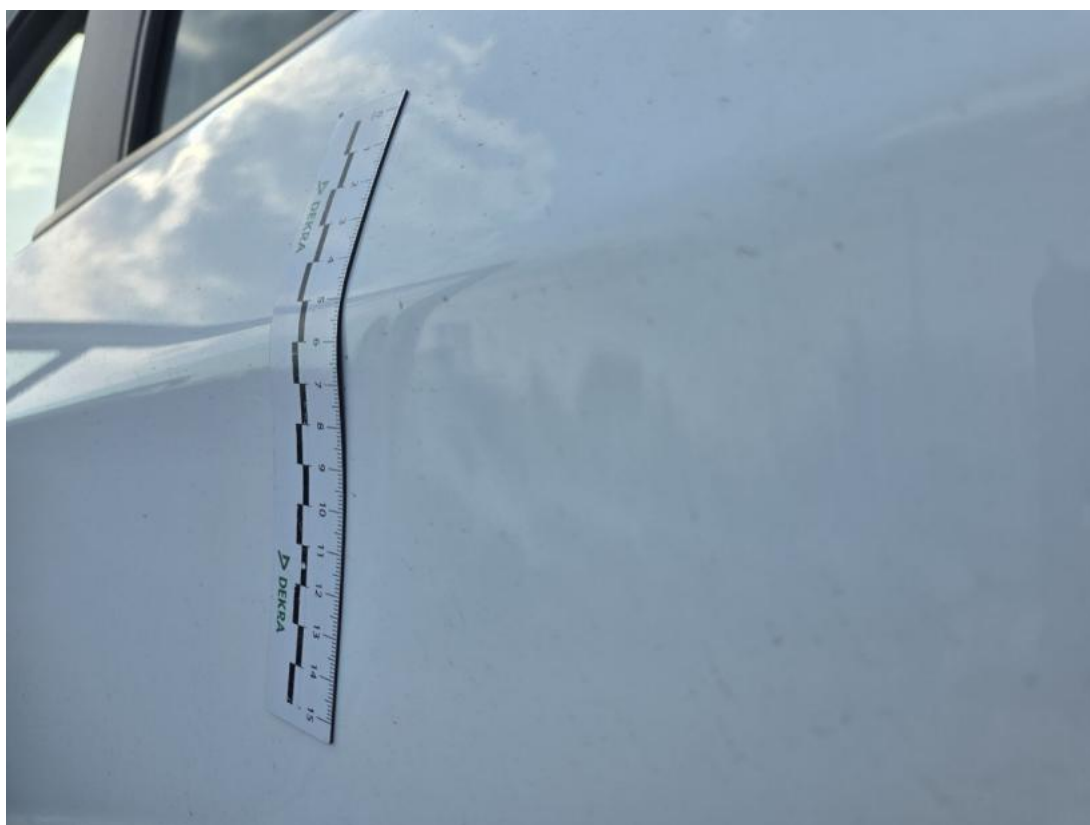
Fot. 48 Drzwi tylne L - Wgniecenie/odkształcenie 1
