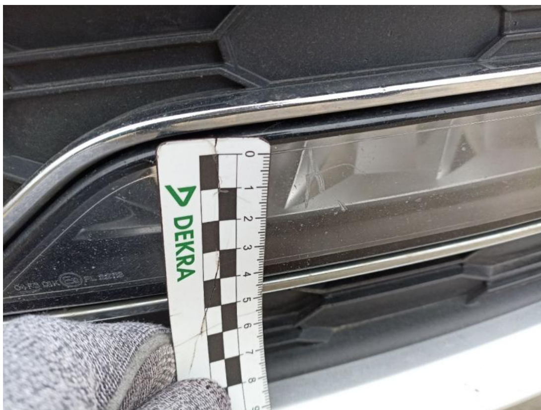
Fot. 42 Reflektor przeciwmgielny L - Rysa/odprysk 1
