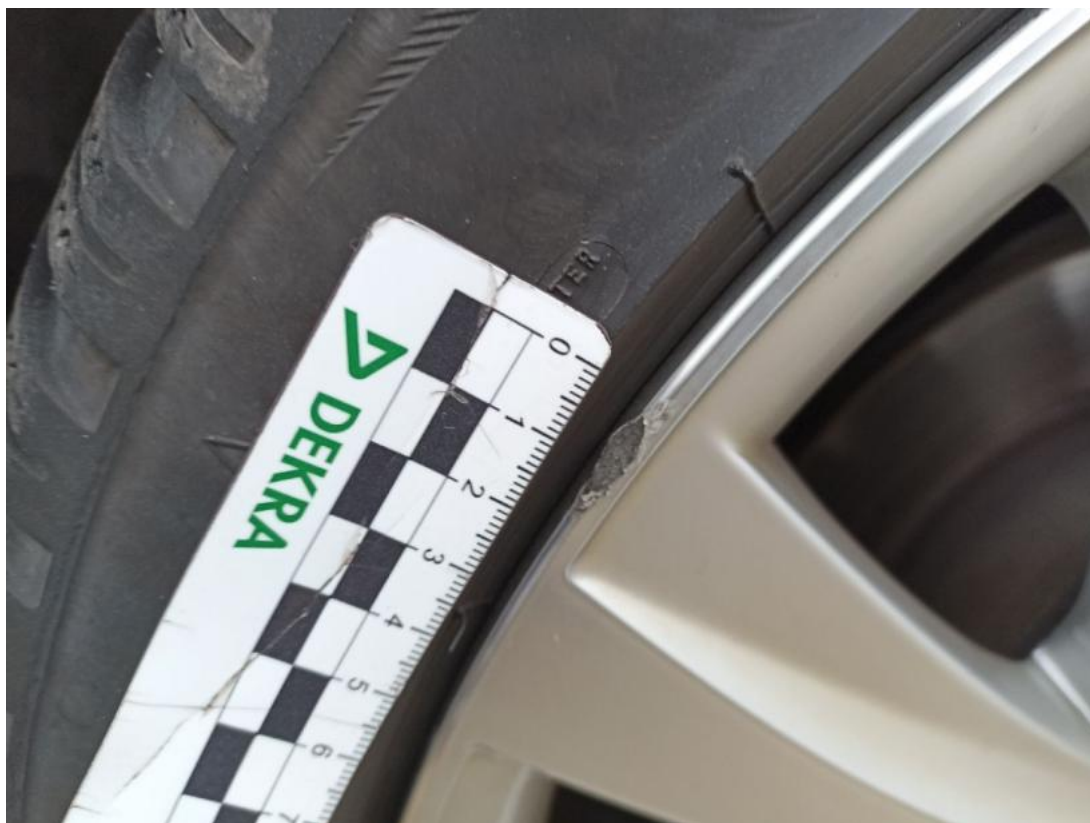
Fot. 37 Felga aluminiowa tylna P - Rysa/odprysk 1
