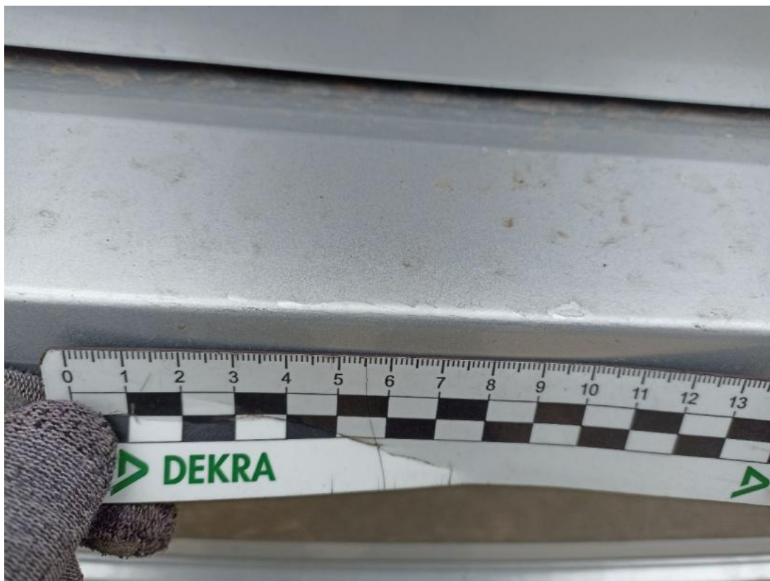
Fot. 39 Zderzak tylny - Rysa/odprysk 2
