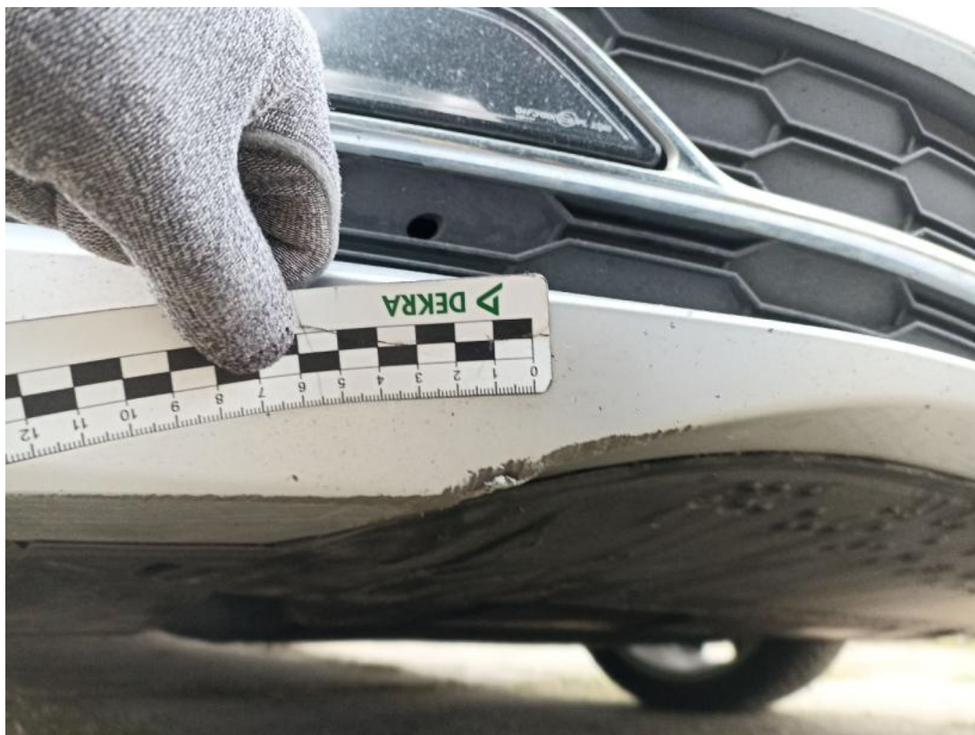
Fot. 33 Zderzak - Rysa/odprysk 1
