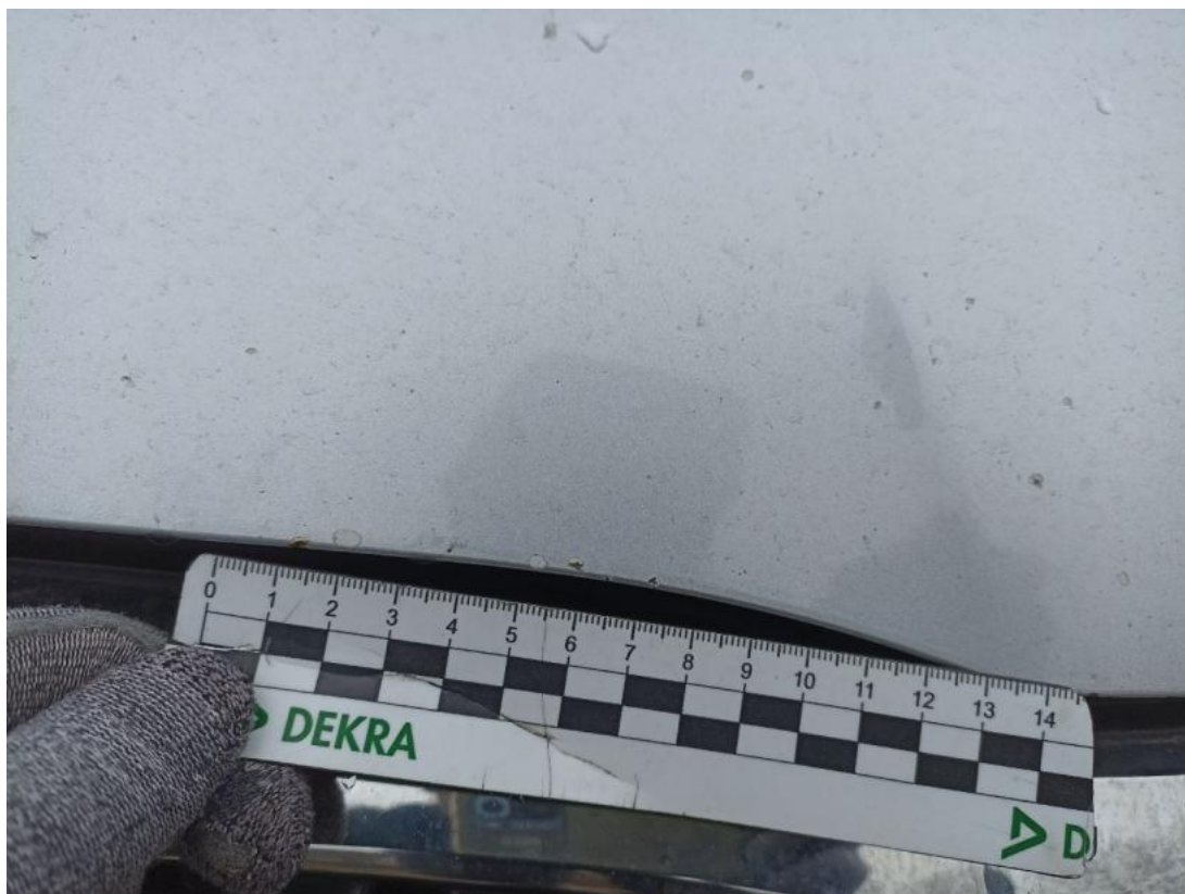
Fot. 31 Pokrywa komory silnika - Rysa/odprysk 1
