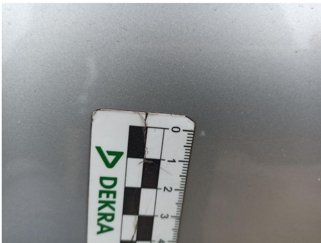
Fot. 34 Drzwi tylne P - Rysa/odprysk 1
