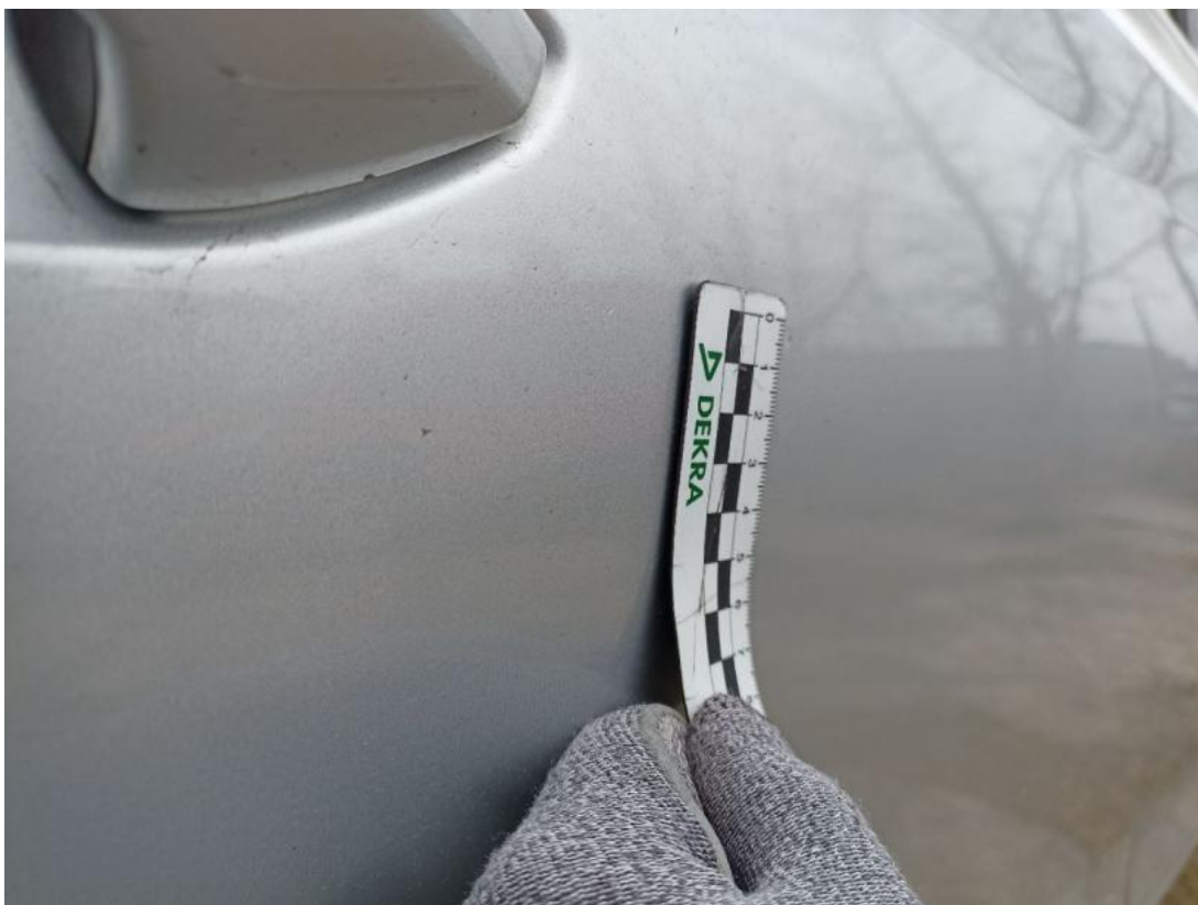
Fot. 35 Drzwi tylne P - Wgniecenie/odkształcenie 1
