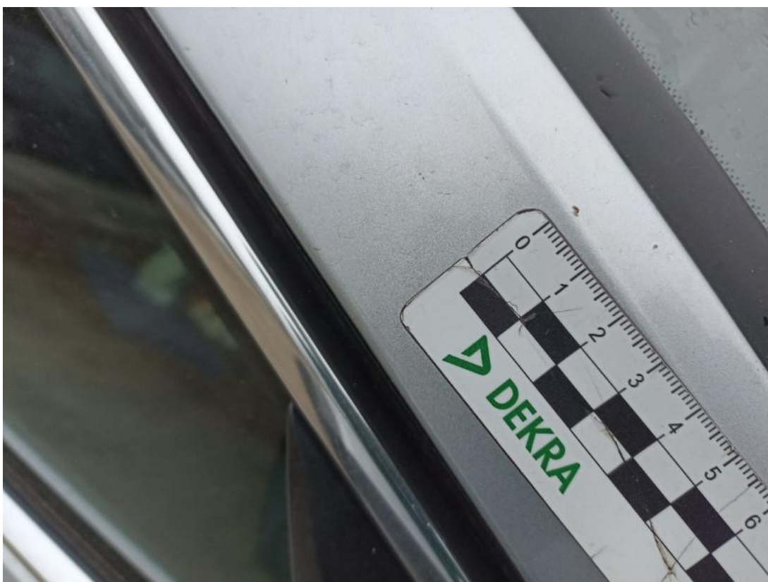
Fot. 36 Słupek przedni P - Rysa/odprysk 1
