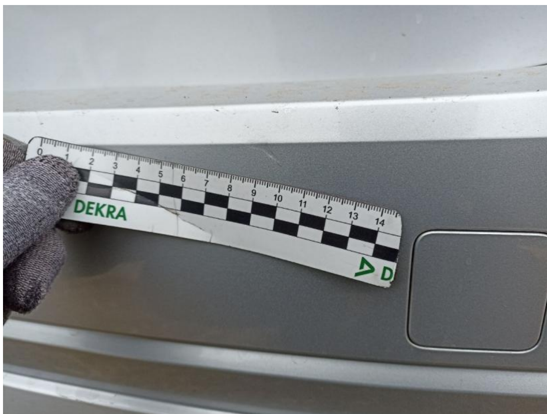
Fot. 40 Zderzak tylny - Wgniecenie/odkształcenie 1
