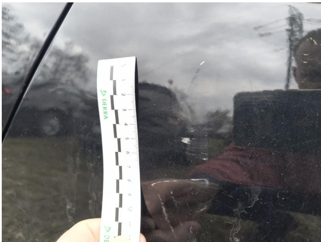
Fot. 48 Błotnik tylny L / Ściana boczna L - Rysa/odprysk 1
