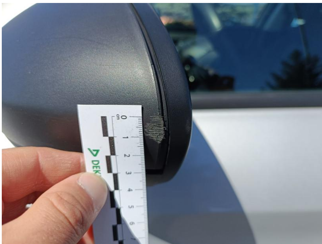
Fot. 56 Obudowa lusterka zew L - Rysa/odprysk 1
