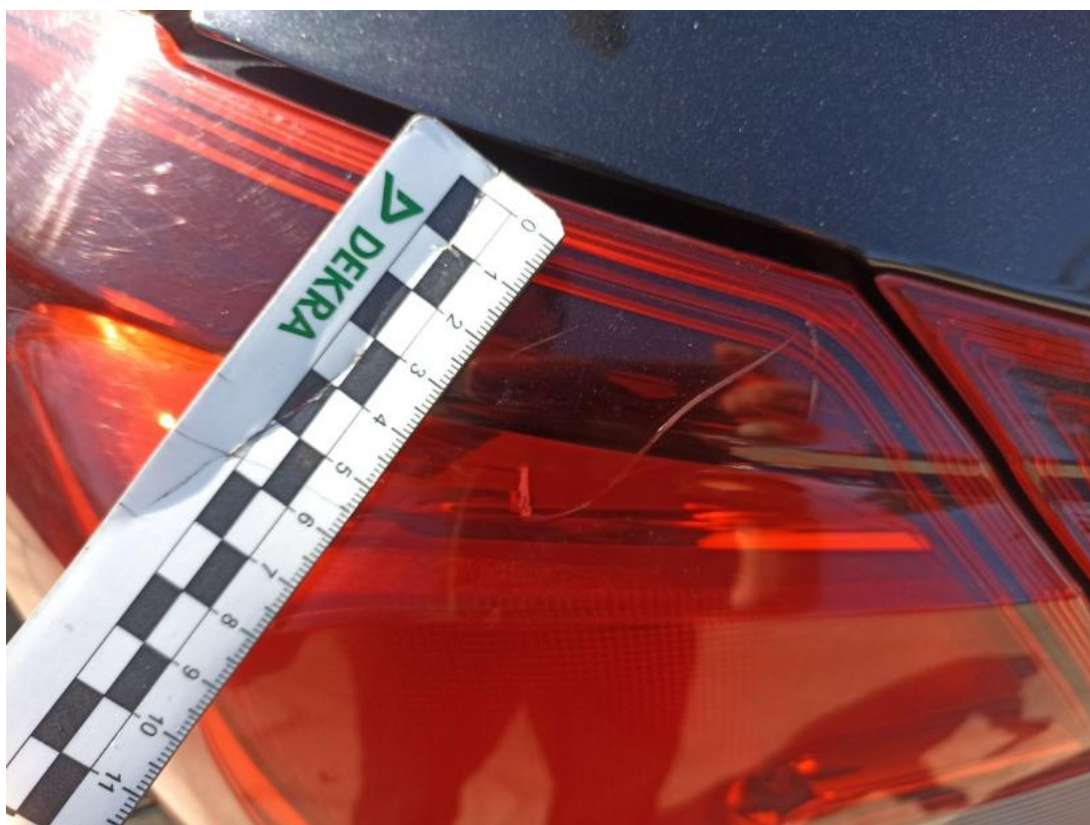
Fot. 48 Lampa tylna zew L - Rysa/odprysk 1
