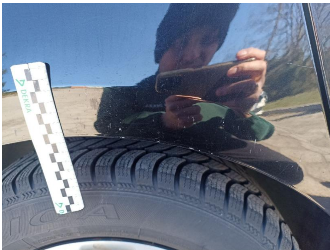
Fot. 40 Błotnik tylny P / Ściana boczna P - Rysa/odprysk 1
