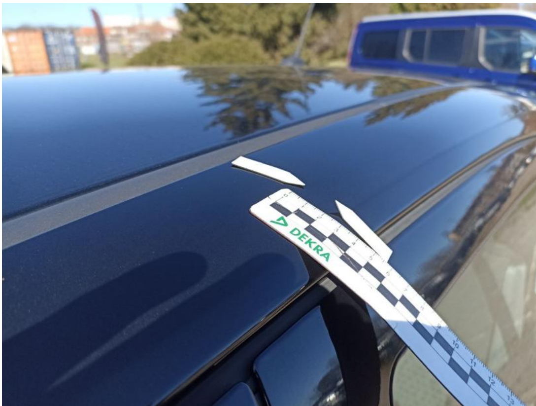
Fot. 45 Rama dachu L - Wgniecenie/odkształcenie 1
