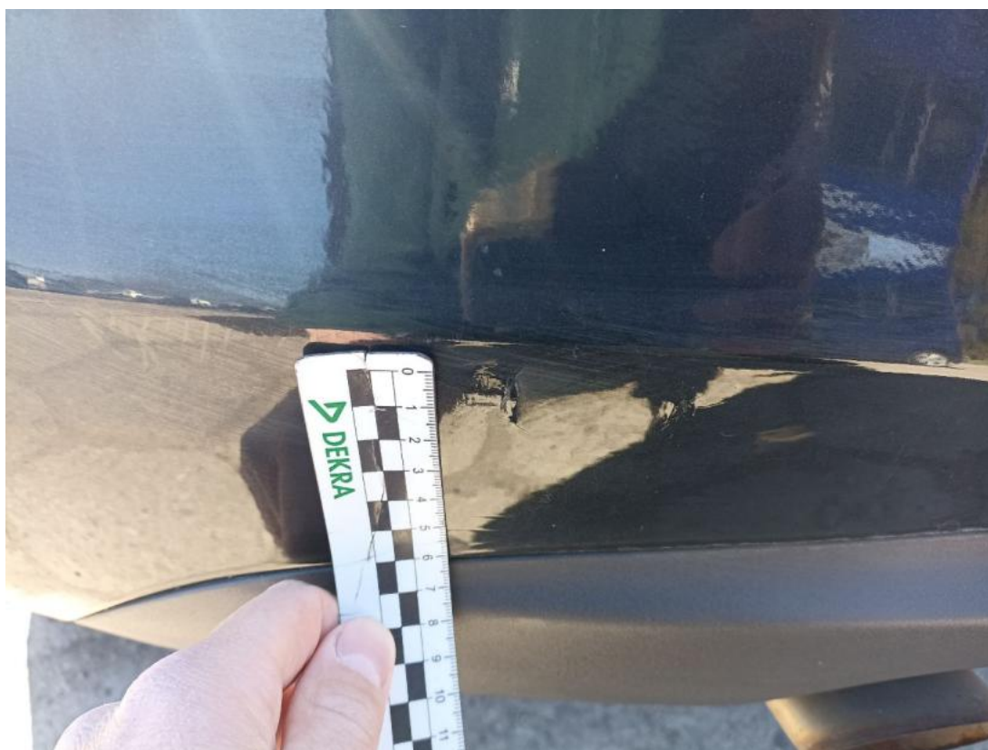
Fot. 44 Zderzak tylny - Wgniecenie/odkształcenie 1
