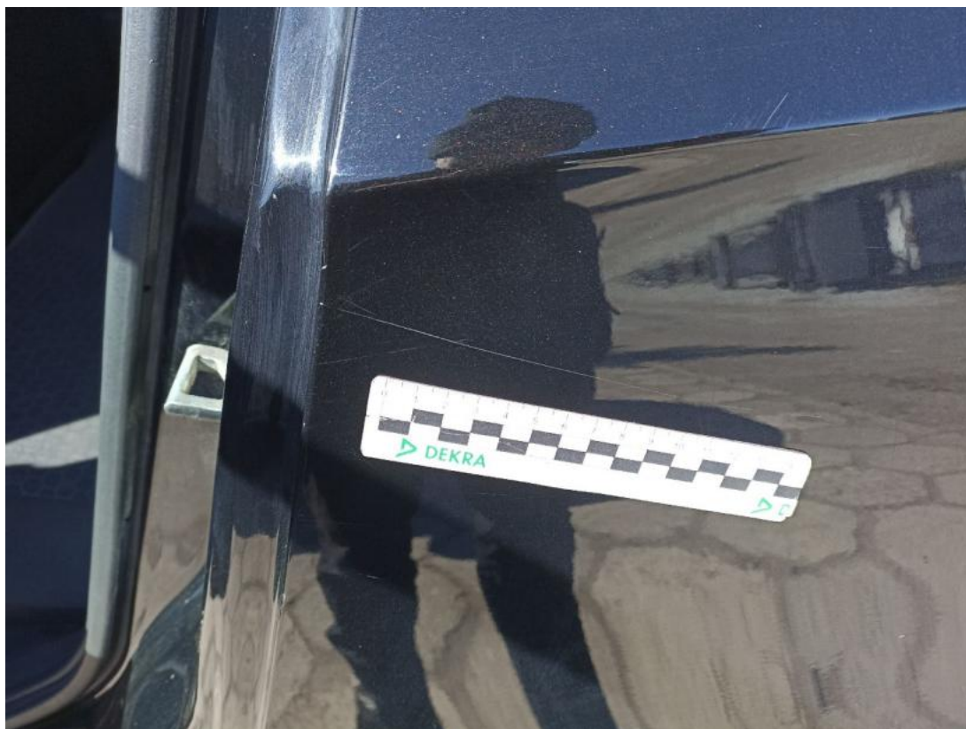
Fot. 47 Błotnik tylny L / Ściana boczna L - Rysa/odprysk 2
