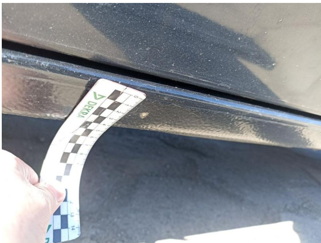
Fot. 54 Próg L - Wgniecenie/odkształcenie 1
