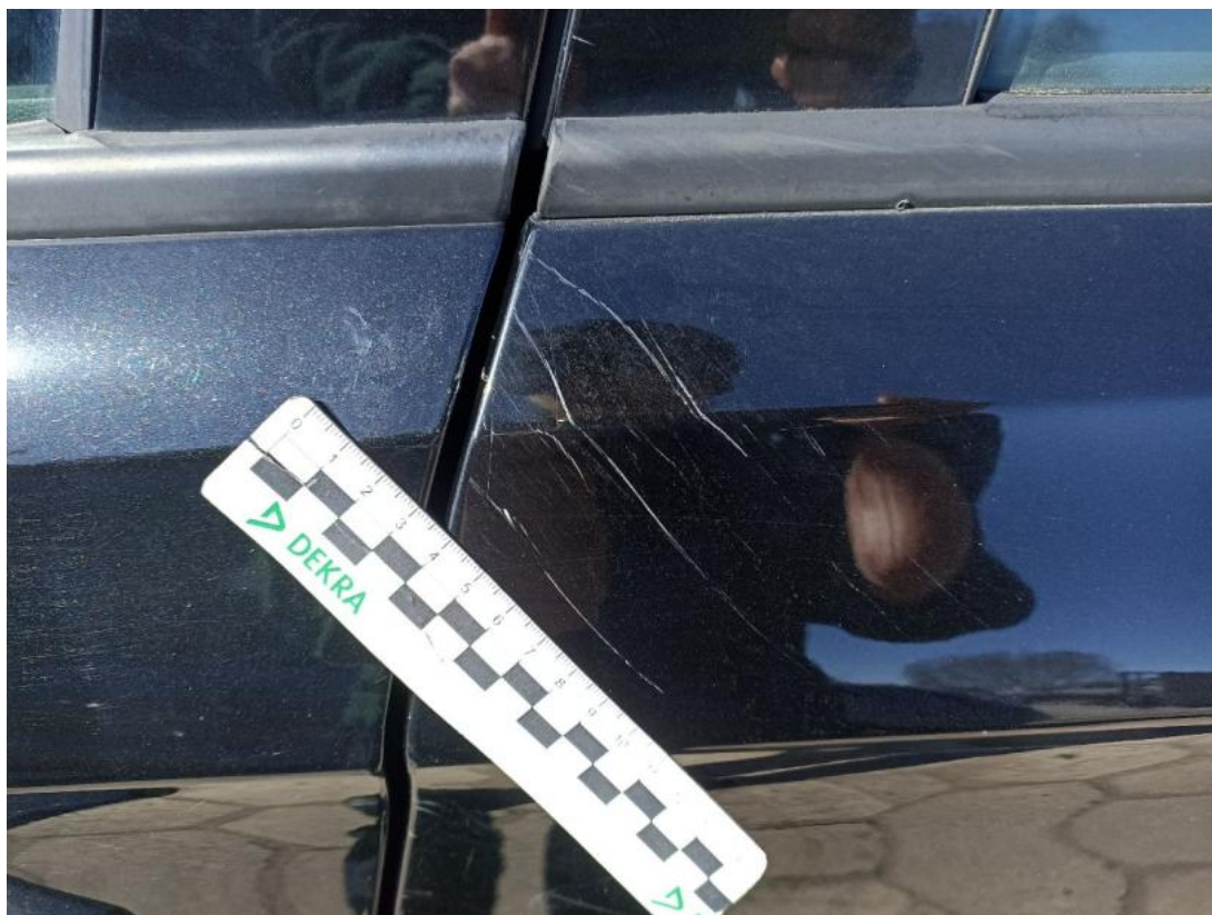
Fot. 51 Drzwi tylne L - Rysa/odprysk 1
