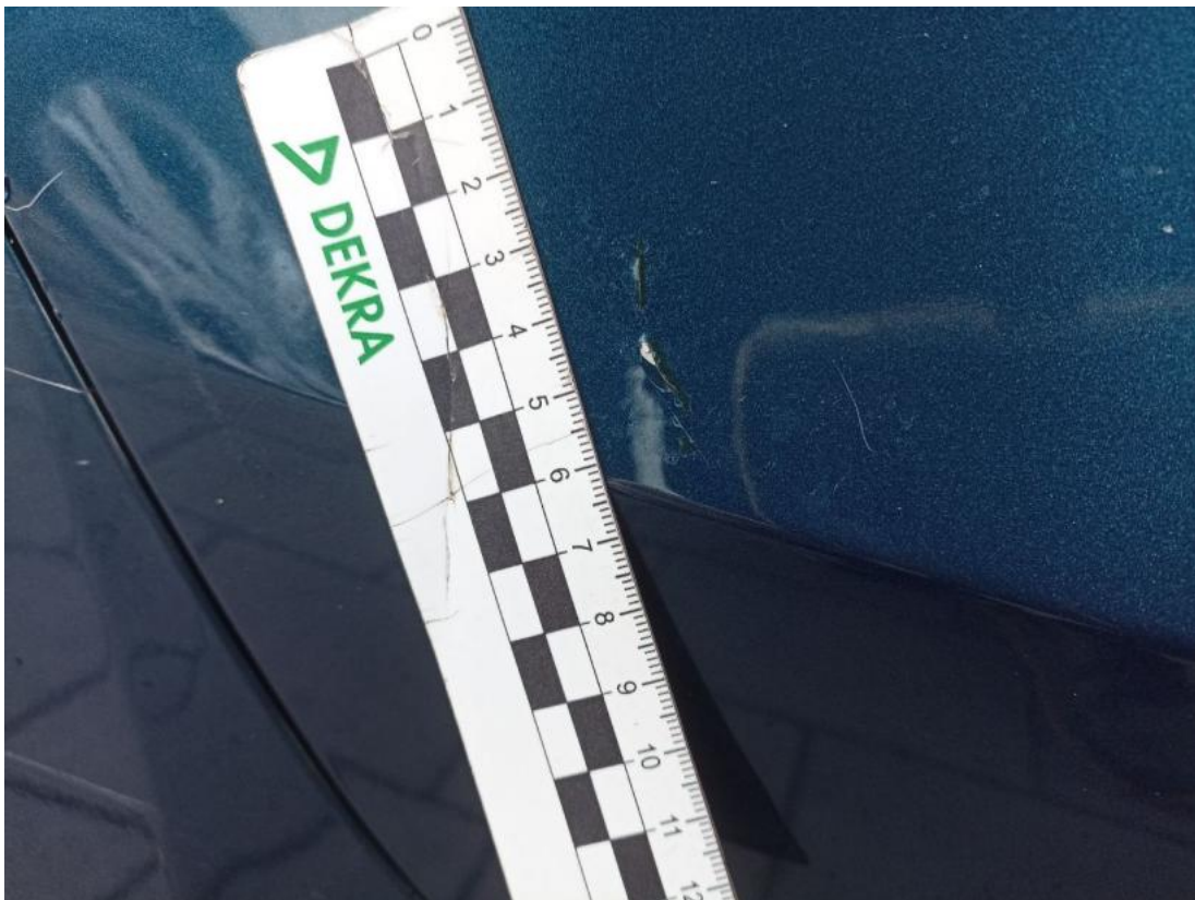
Fot. 43 Drzwi tylne P() - Rysa/odprysk 3
