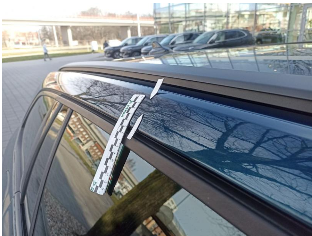
Fot. 48 Rama dachu P - Wgniecenie/odkształcenie 1
