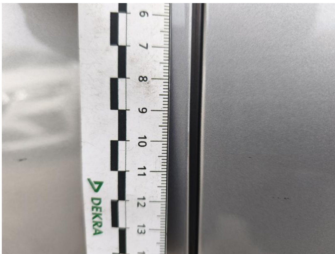
Fot. 46 Drzwi przed L - Rysa/odprysk 1
