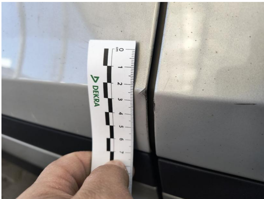
Fot. 65 Drzwi przed L - Rysa/odprysk 1
