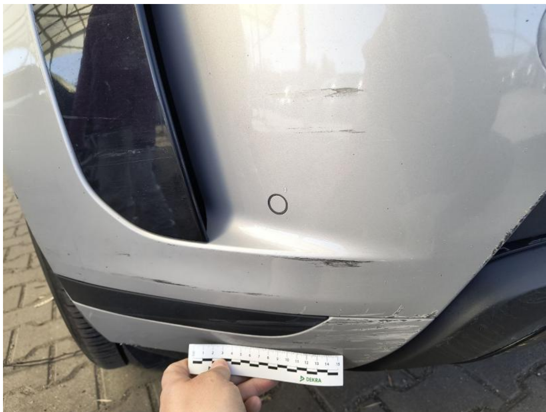
Fot. 41 Zderzak() - Rysa/odprysk 3
