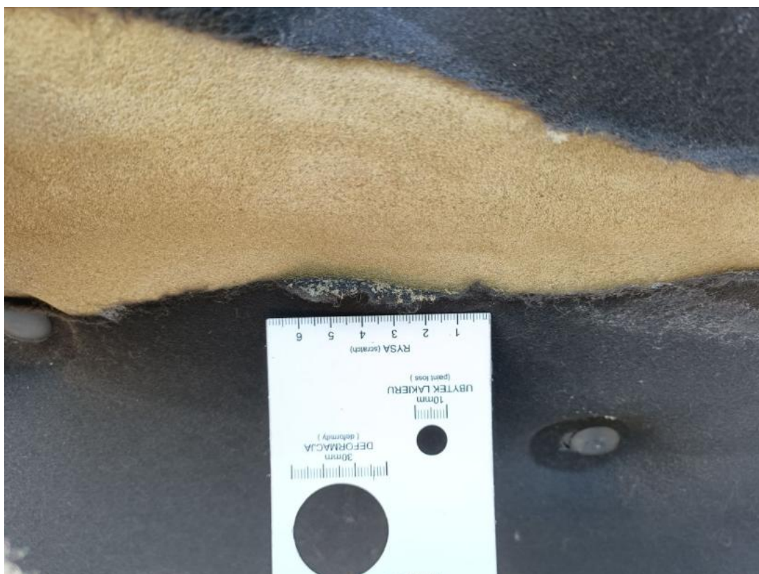
Fot. 50 Wykładzina pokrywy komory silnika - Pęknięcie/rozerwanie 1
