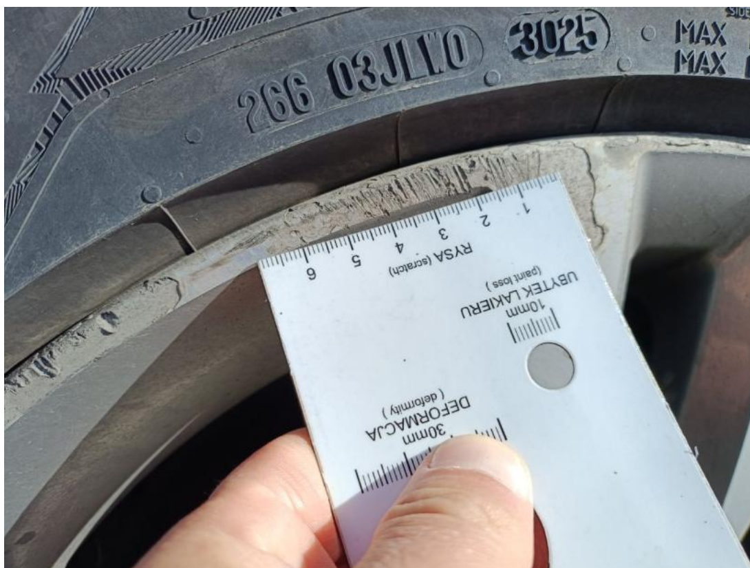
Fot. 59 Felga aluminiowa tylna P - Rysa/odprysk 2
