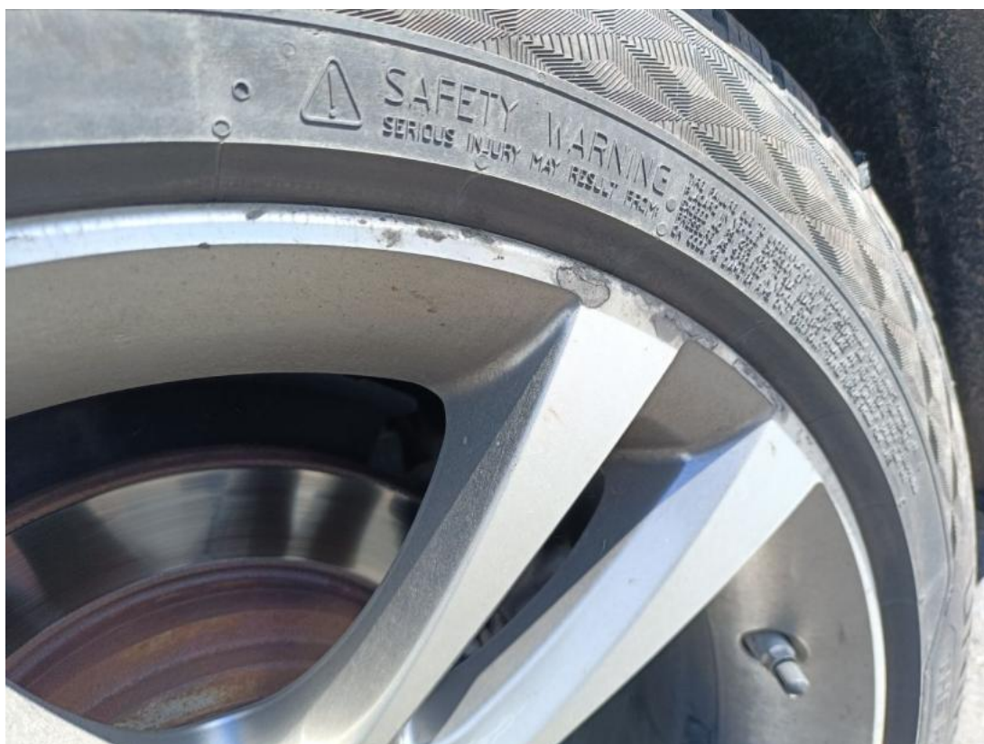
Fot. 60 Felga aluminiowa tylna P() - Rysa/odprysk 3
