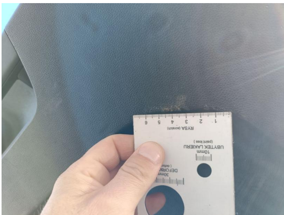
Fot. 82 Wykładzina pokrywy tylnej - Rysa/odprysk 2
