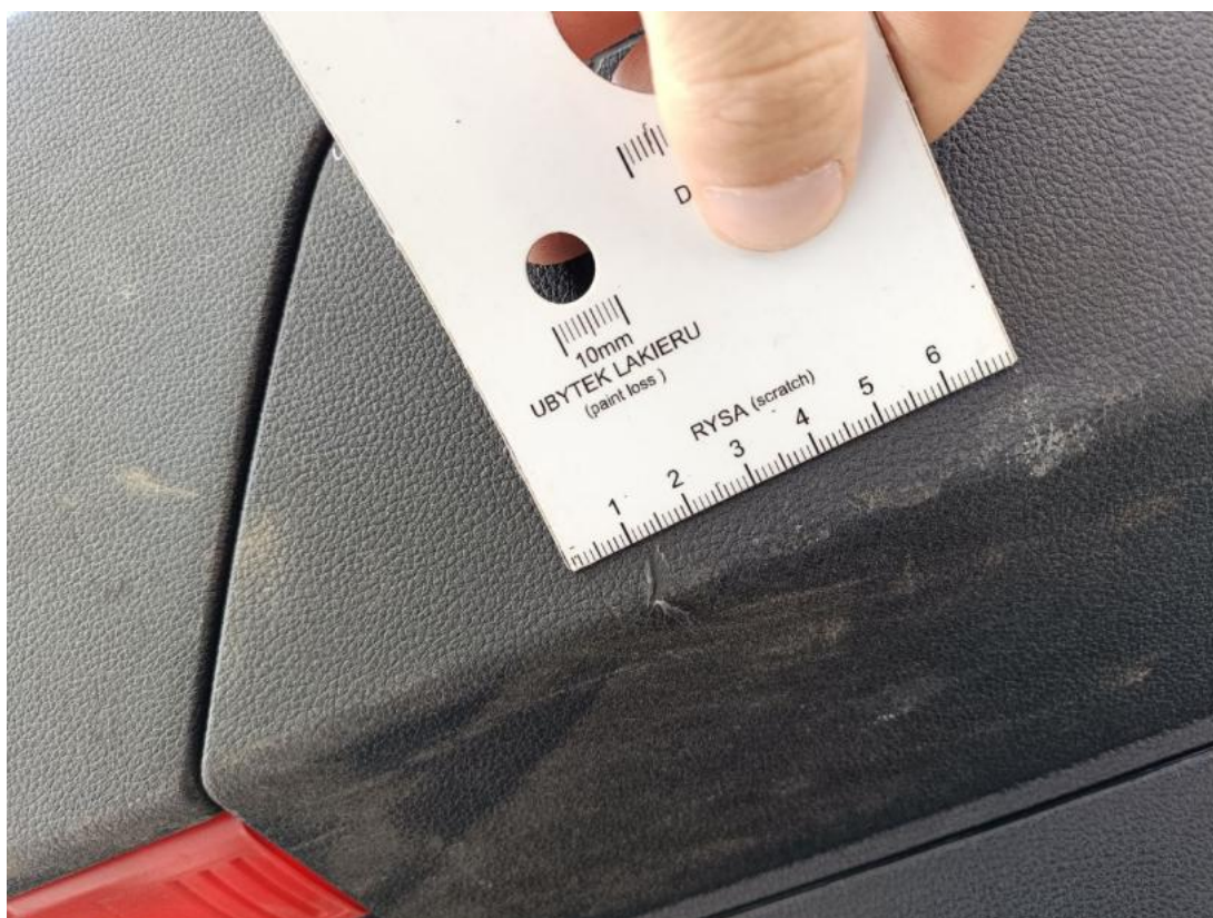
Fot. 81 Wykładzina pokrywy tylnej - Rysa/odprysk 1
