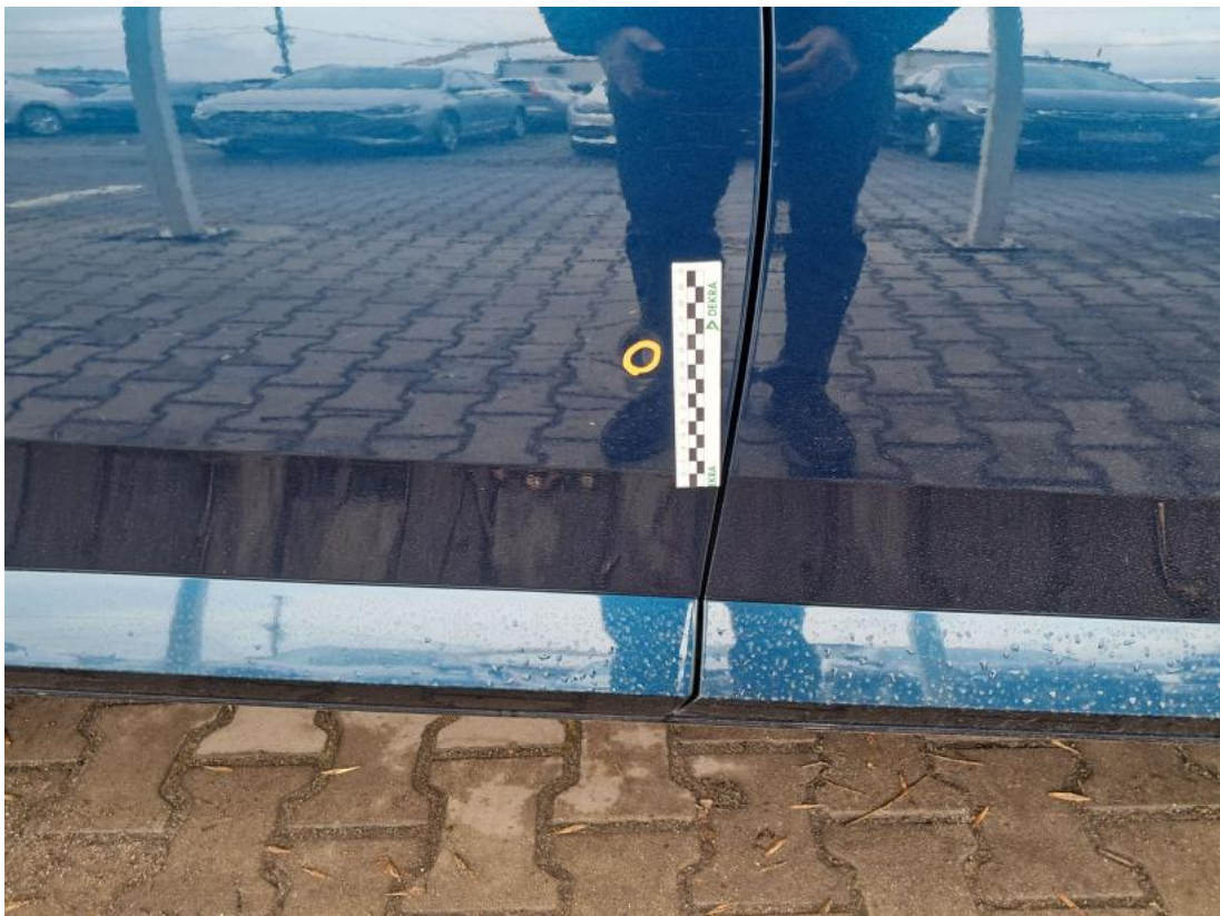
Fot. 44 Drzwi tylne P - Wgniecenie/odkształcenie 1
