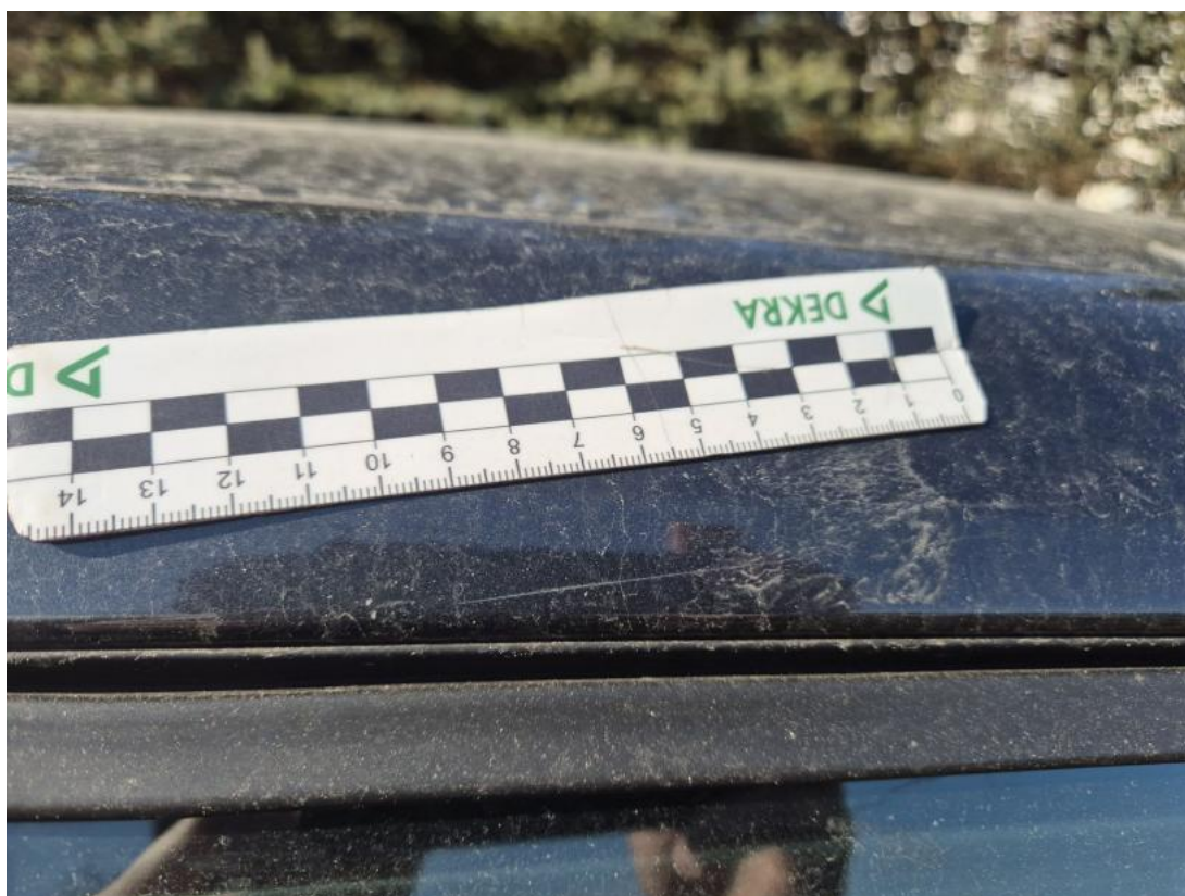
Fot. 42 Rama dachu L - Rysa/odprysk 1
