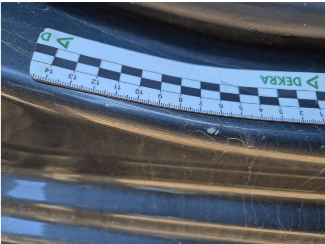
Fot. 38 Próg P - Rysa/odprysk 1
