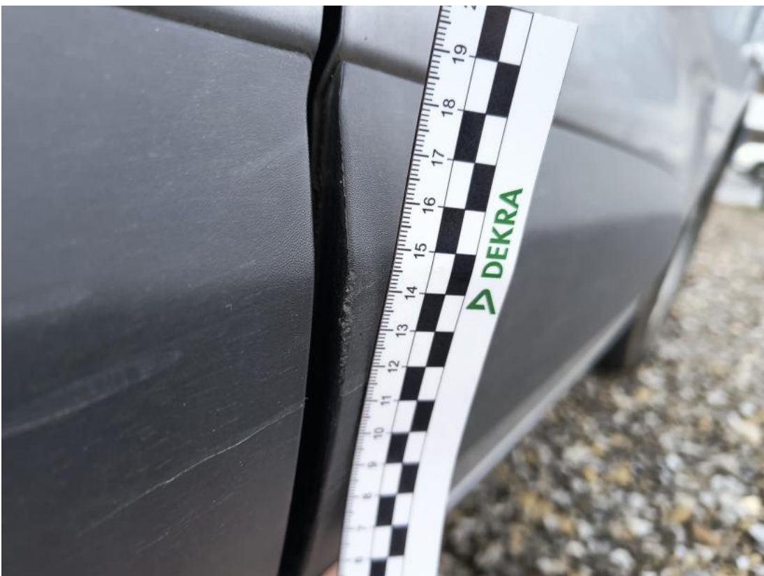
Fot. 48 Listwa drzwi przednich P - Rysa/odprysk 1
