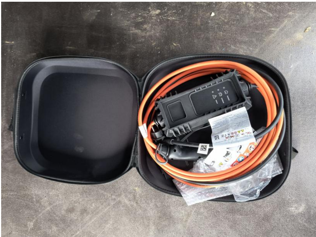
Fot. 28 Przewód ładowania baterii trakcyjnej
