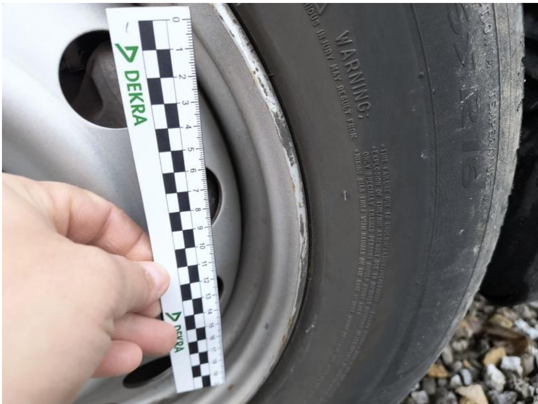
Fot. 43 Felga przednia P - Rysa/odprysk 2
