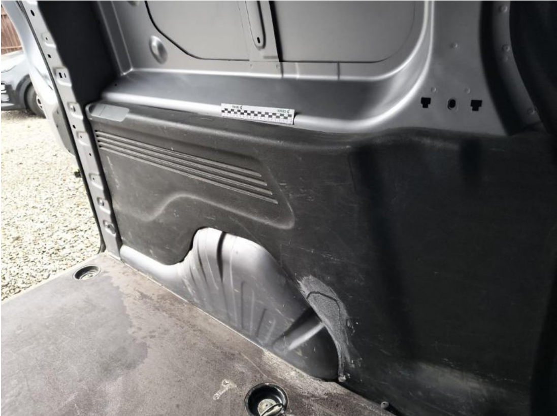
Fot. 107 Ściana lewa - Rysa/odprysk 2
