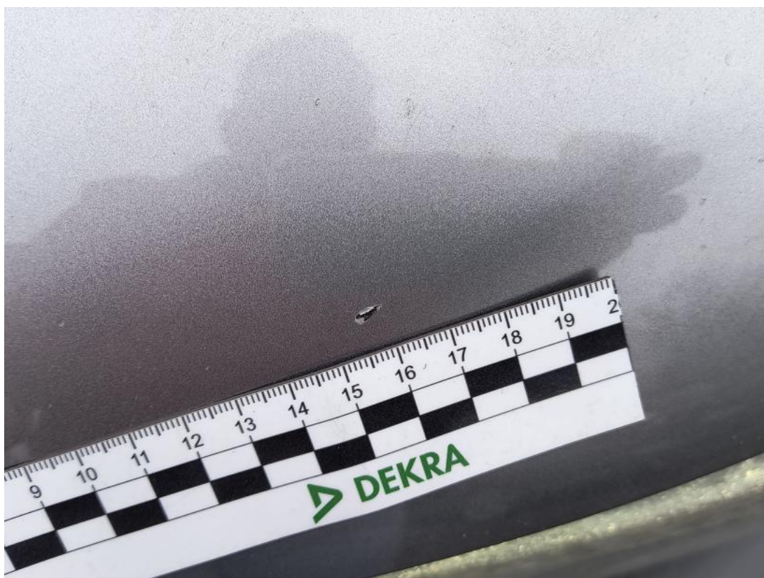
Fot. 39 Zderzak - Rysa/odprysk 1
