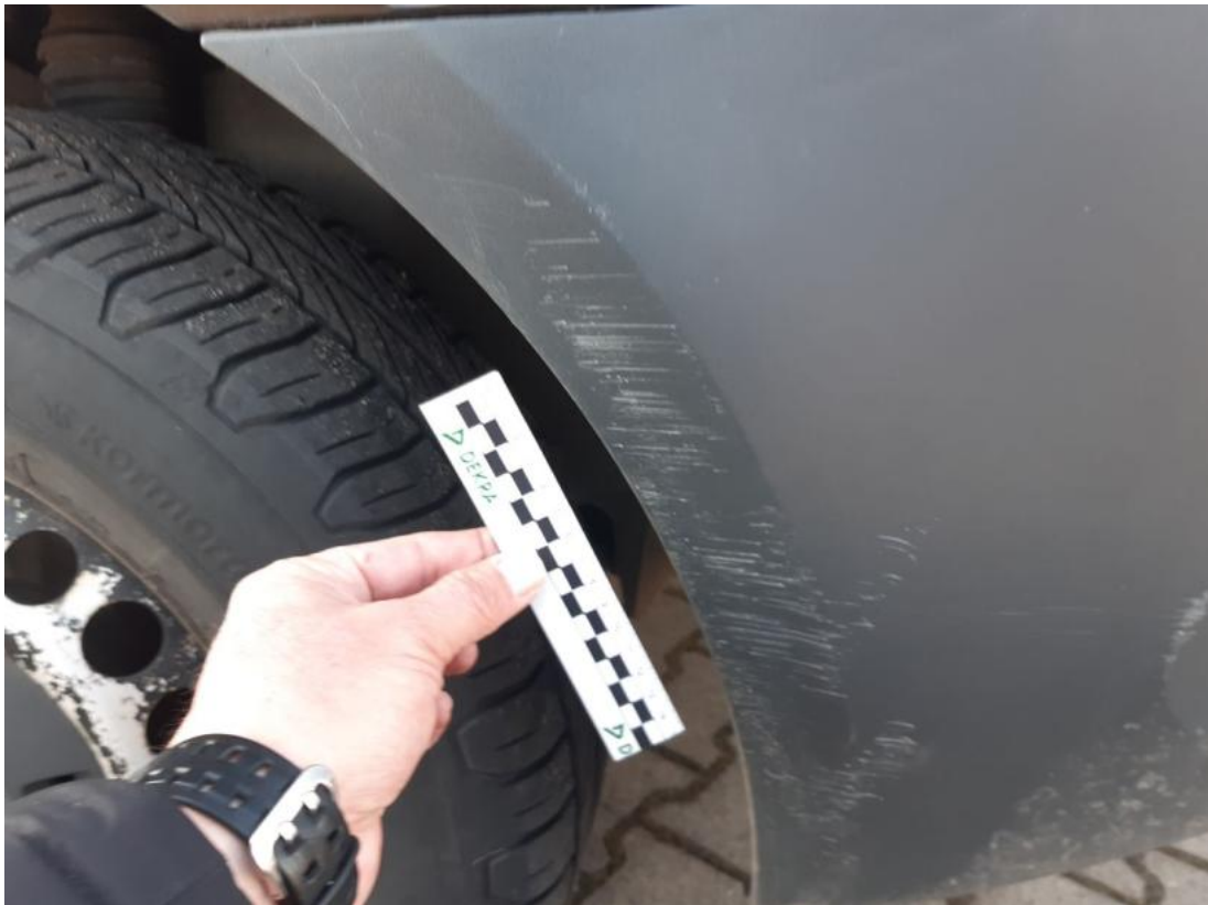
Fot. 47 Zderzak - Rysa/odprysk 1
