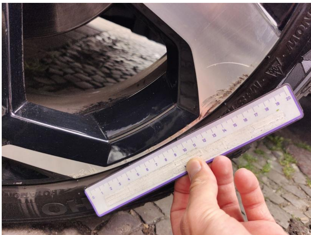
Fot. 71 Felga Aluminiowa przednia L - Rysa/odprysk 2
