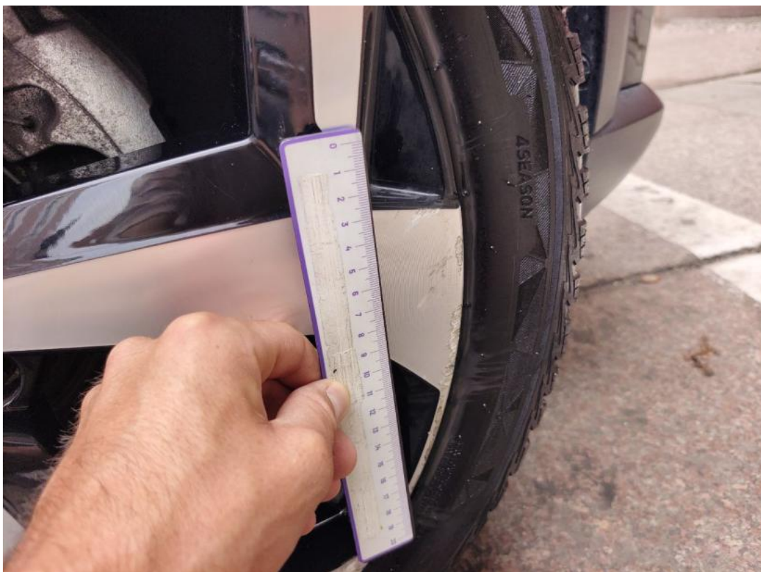
Fot. 42 Felga aluminiowa przednia P() - Rysa/odprysk 3
