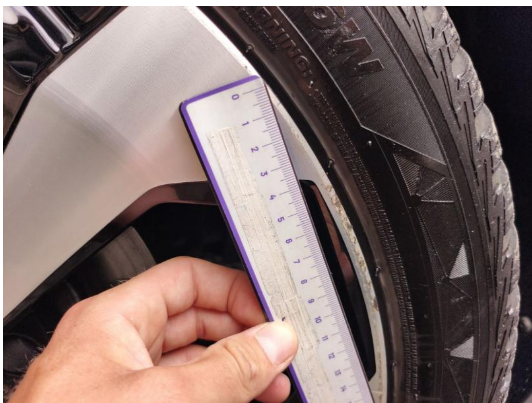
Fot. 72 Felga Aluminiowa przednia L() - Rysa/odprysk 3
