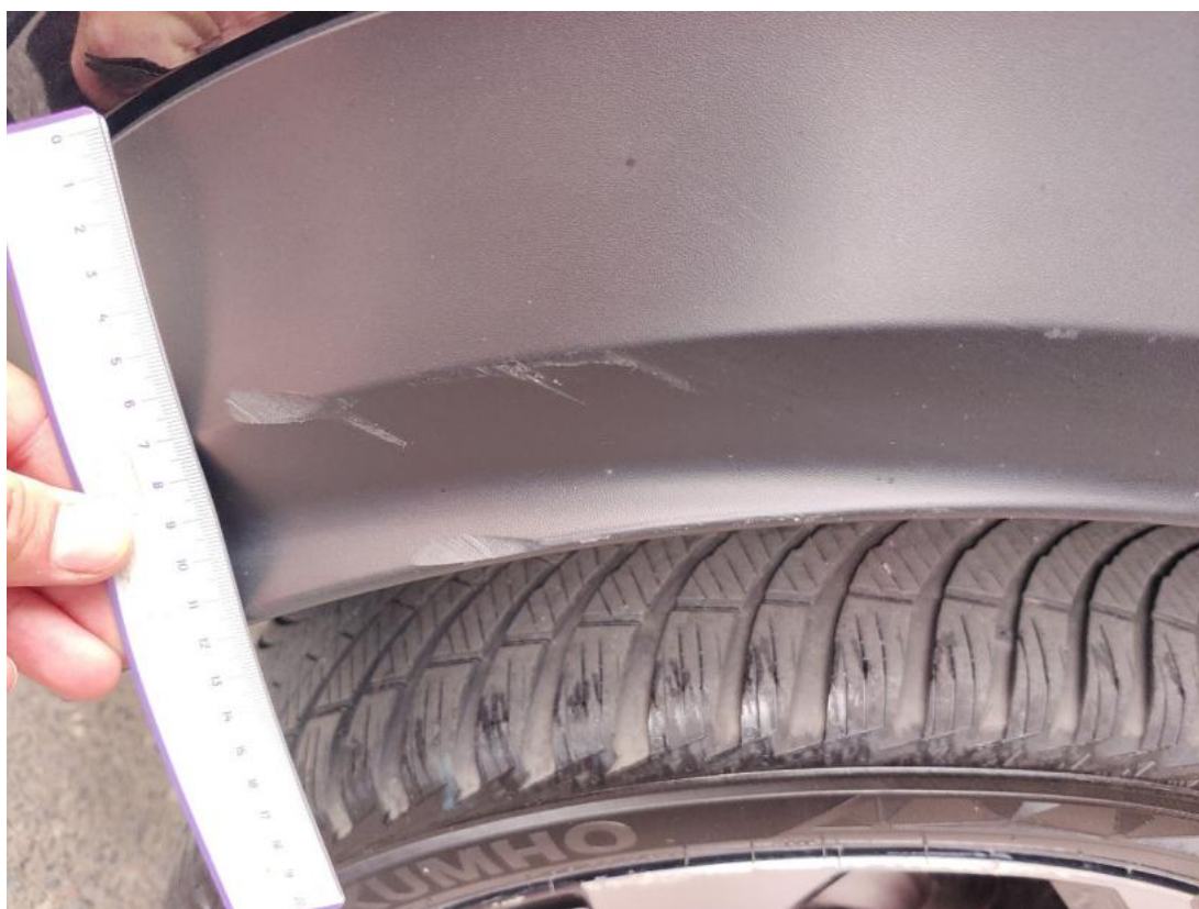
Fot. 58 Zderzak tylny cz P - Rysa/odprysk 2
