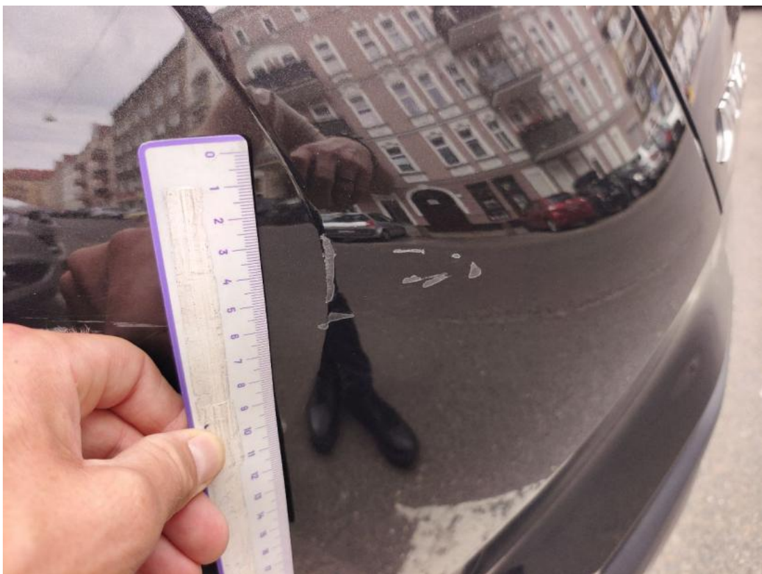
Fot. 54 Zderzak tylny cz L - Rysa/odprysk 2
