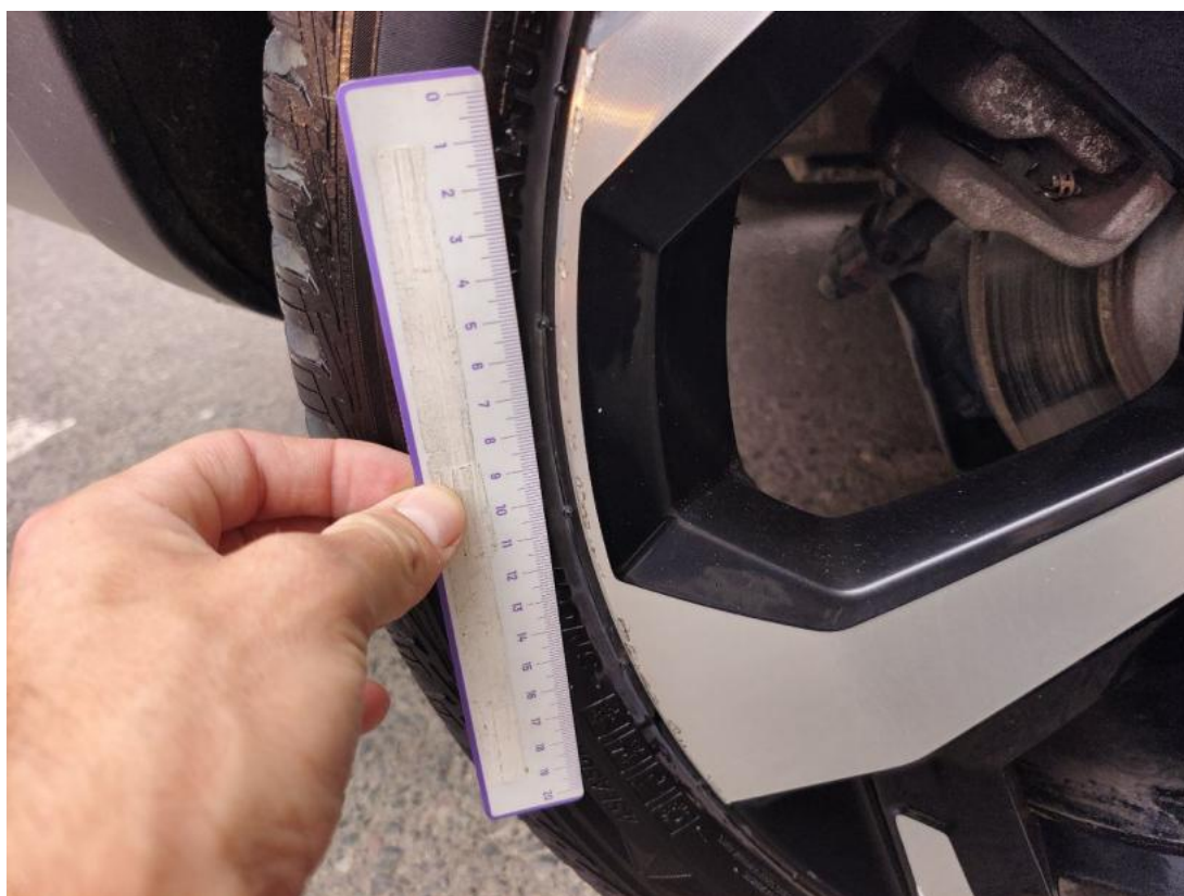
Fot. 50 Felga aluminiowa tylna P() - Rysa/odprysk 3
