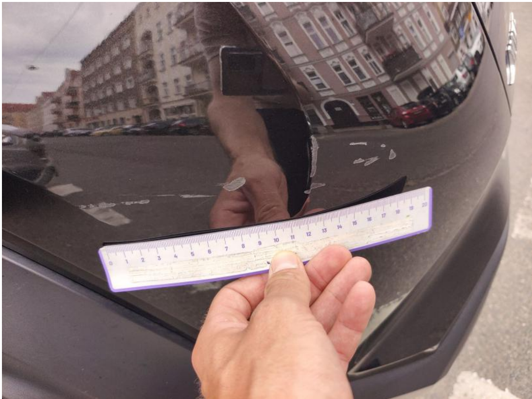
Fot. 53 Zderzak tylny cz L - Rysa/odprysk 1
