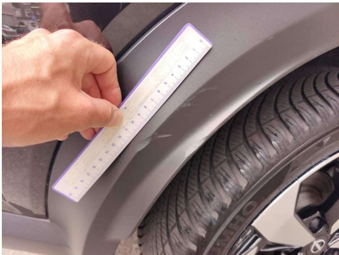
Fot. 57 Zderzak tylny cz P - Rysa/odprysk 1
