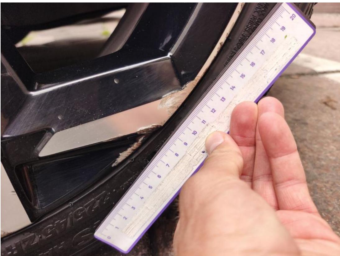
Fot. 40 Felga aluminiowa przednia P - Rysa/odprysk 1
