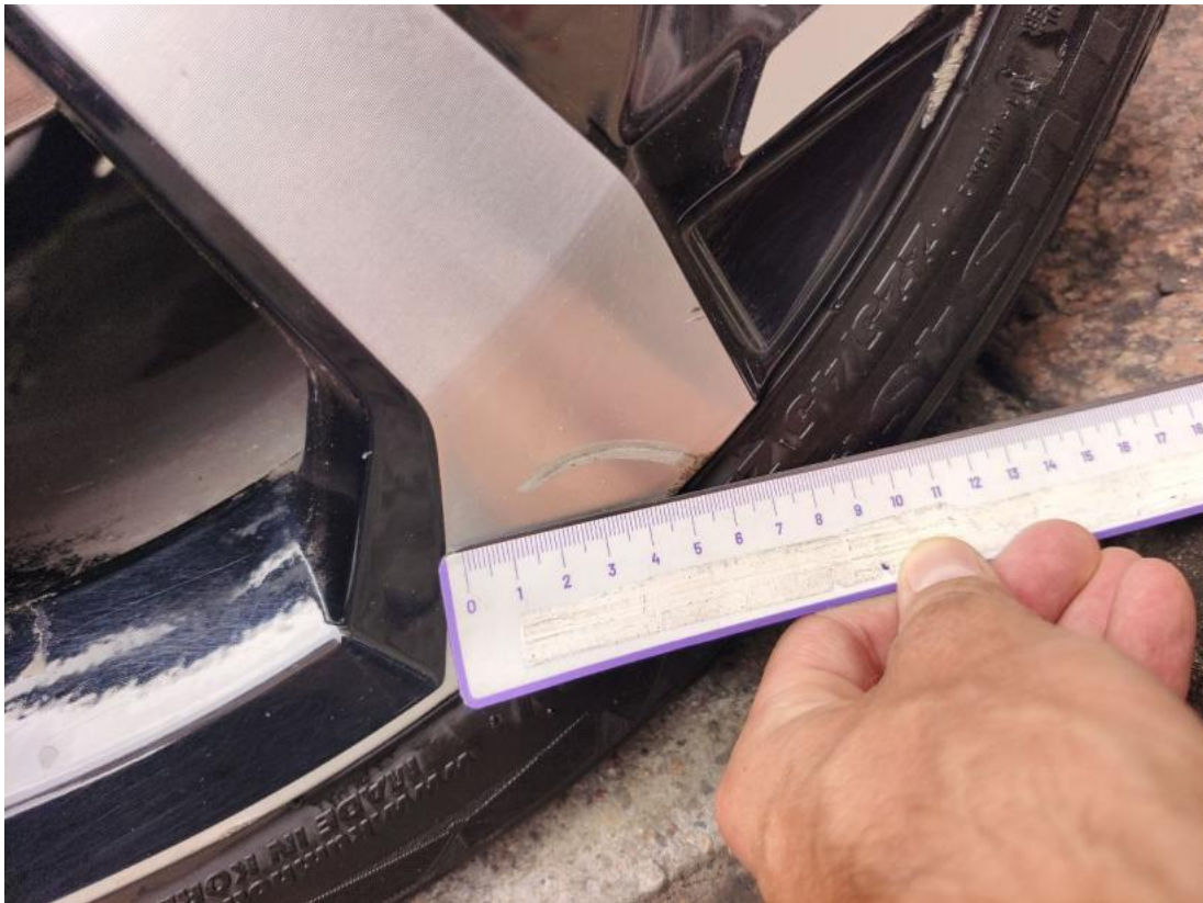
Fot. 41 Felga aluminiowa przednia P - Rysa/odprysk 2
