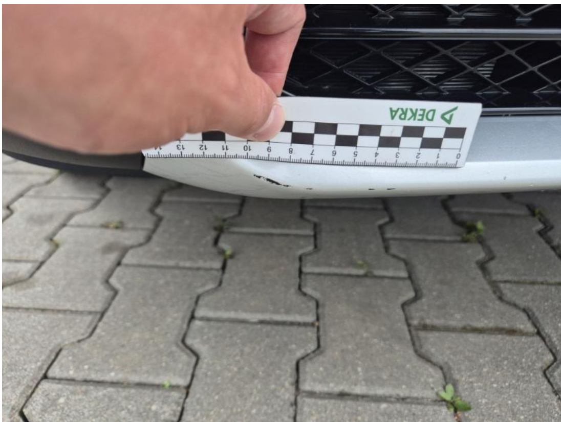
Fot. 34 Zderzak - Rysa/odprysk 1
