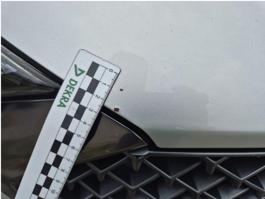
Fot. 33 Pokrywa komory silnika - Rysa/odprysk 1
