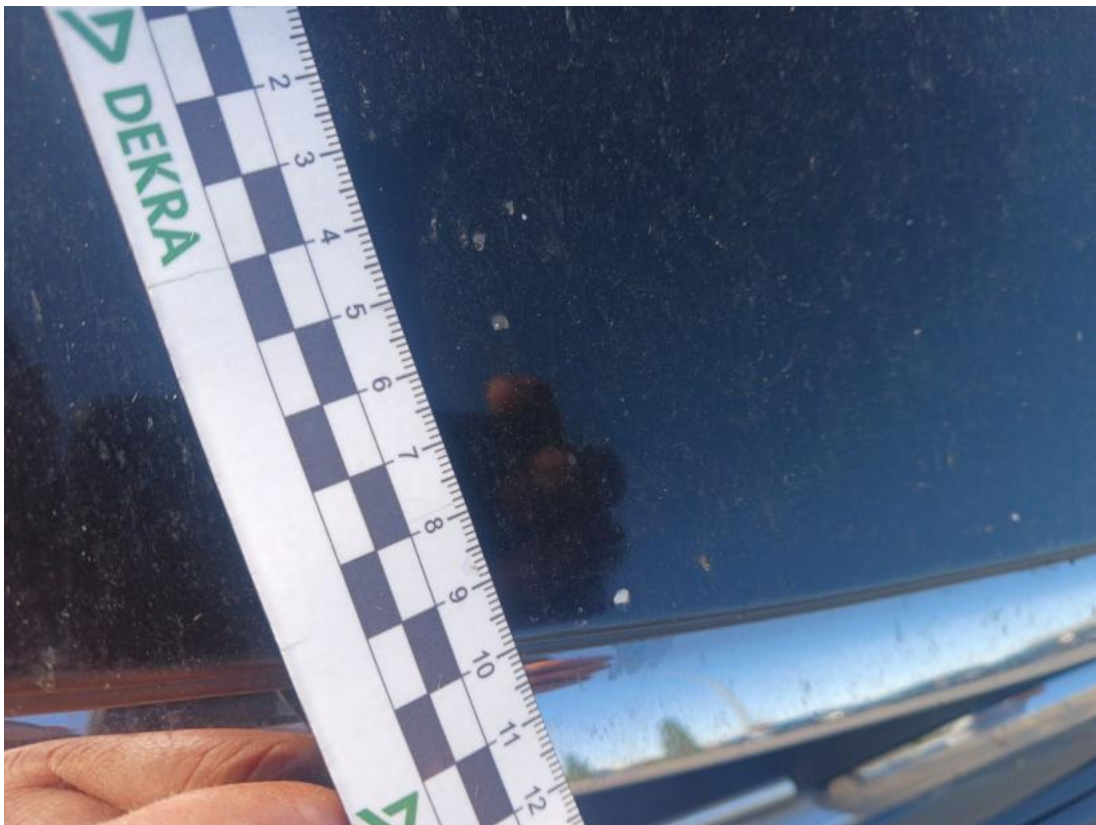
Fot. 41 Pokrywa komory silnika() - Rysa/odprysk 3
