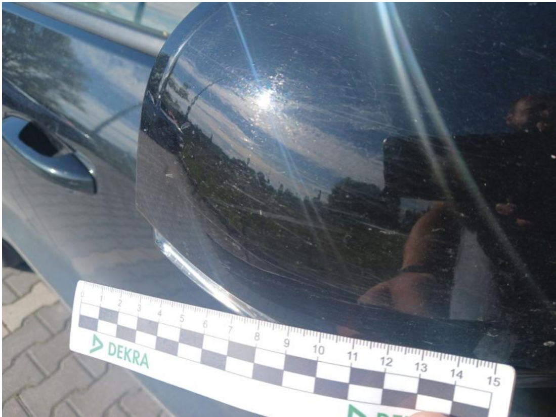
Fot. 45 Obudowa lusterka zew P - Rysa/odprysk 1
