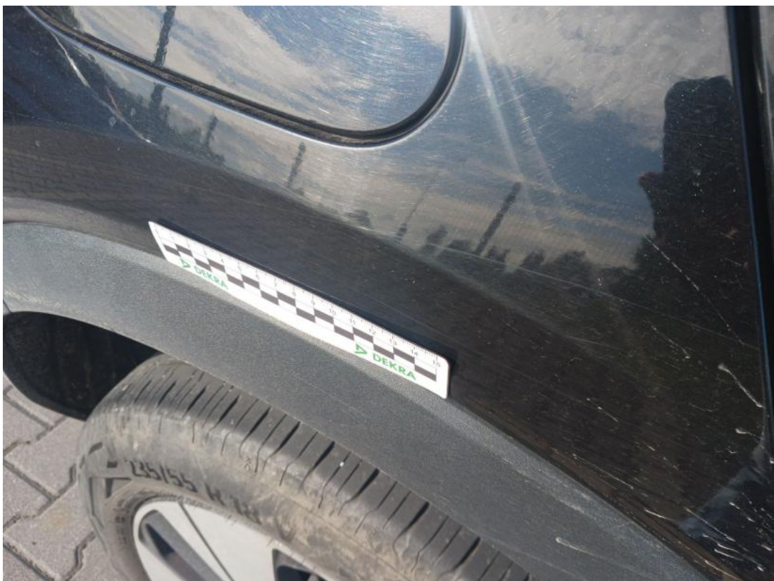
Fot. 46 Błotnik tylny L / Ściana boczna L - Rysa/odprysk 1
