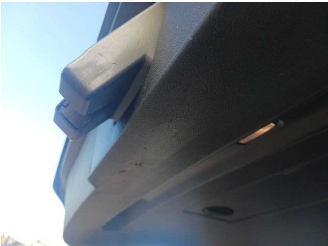
Fot. 52 Wykładzina pokrywy tylnej - Rysa/odprysk 1
