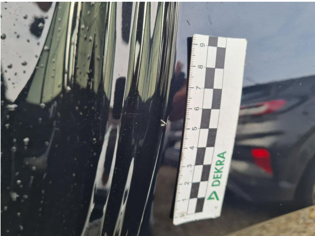
Fot. 44 Błotnik tylny L / Ściana boczna L - Rysa/odprysk 1
