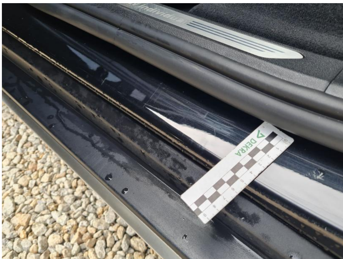
Fot. 46 Próg L - Rysa/odprysk 1
