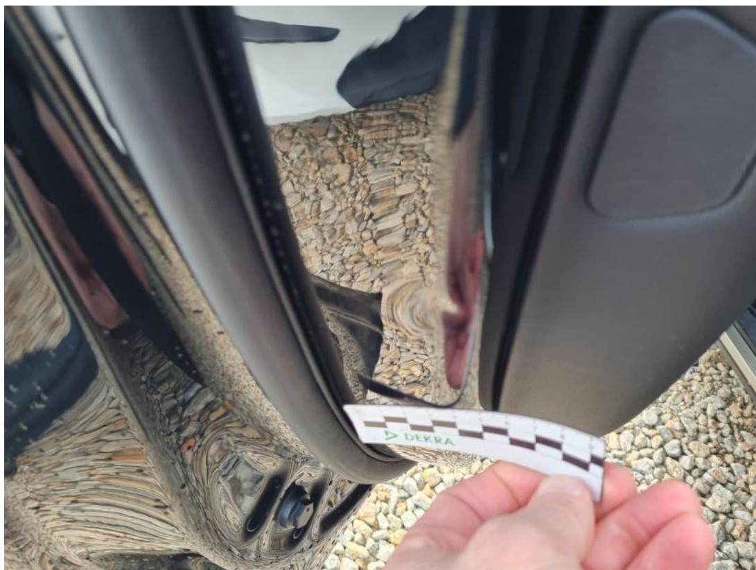
Fot. 45 Drzwi przed L - Wgniecenie/odkształcenie 1
