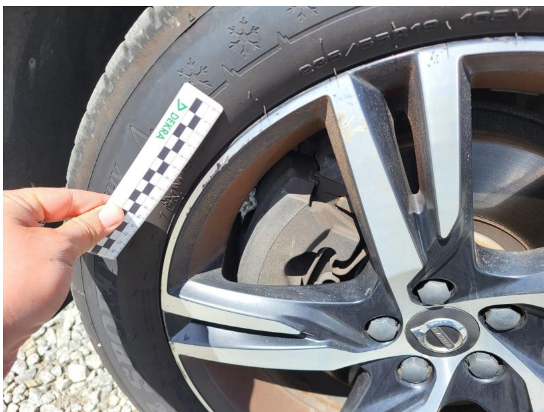
Fot. 50 Felga Aluminiowa przednia L - Rysa/odprysk 2
