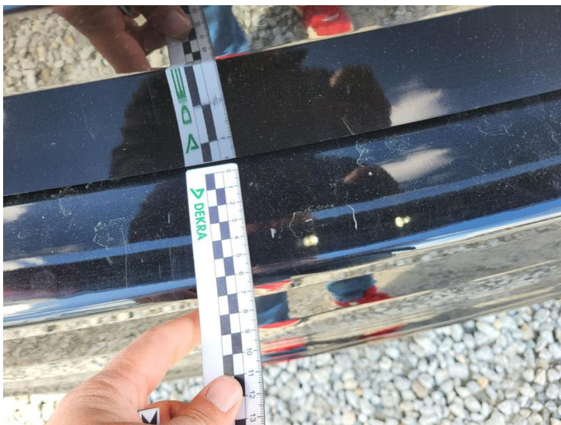
Fot. 44 Zderzak tylny - Rysa/odprysk 1
