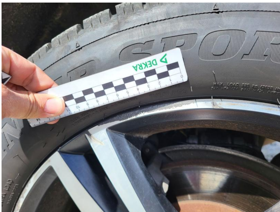
Fot. 45 Felga aluminiowa tylna L - Rysa/odprysk 1
