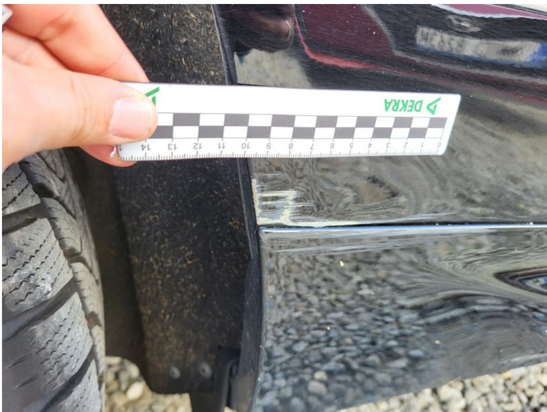
Fot. 40 Drzwi tylne P - Wgniecenie/odkształcenie 1
