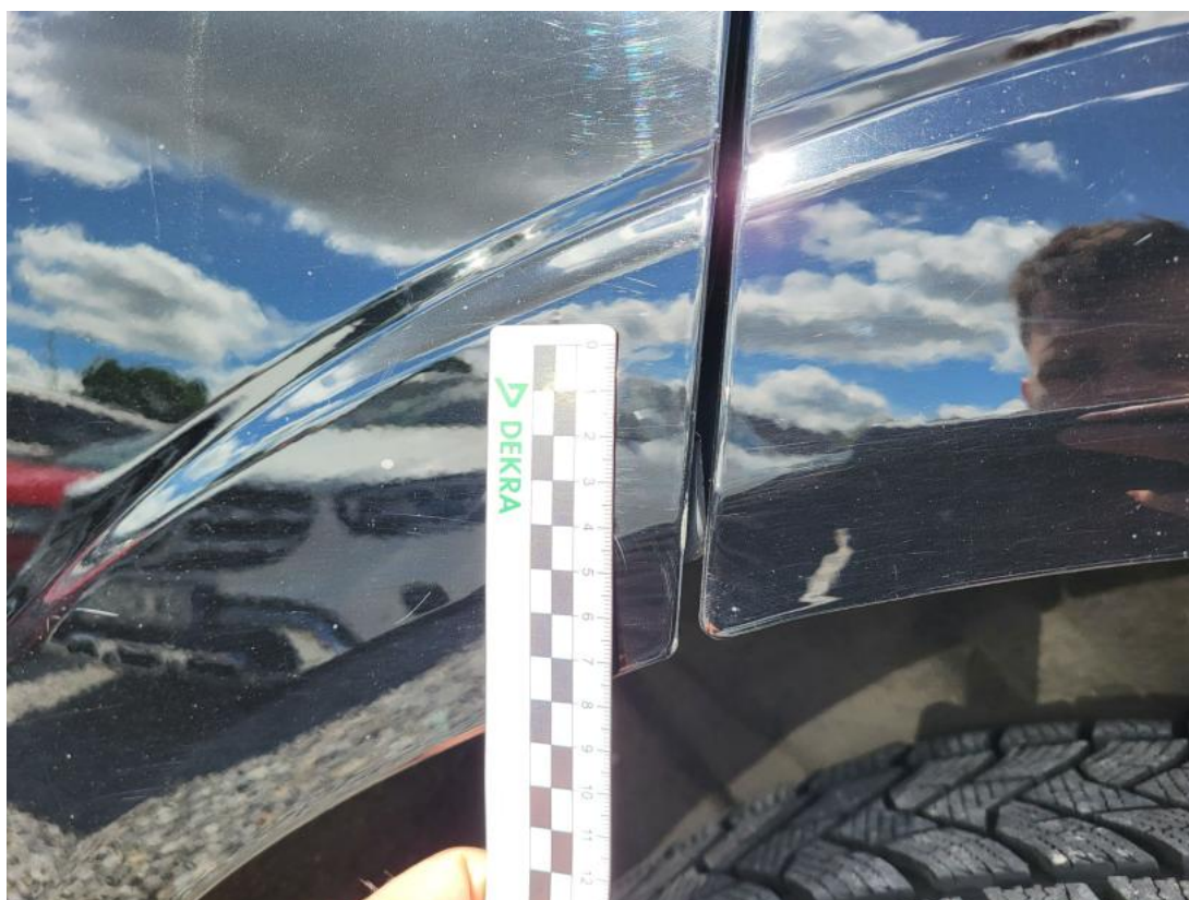
Fot. 47 Drzwi tylne L - Rysa/odprysk 1
