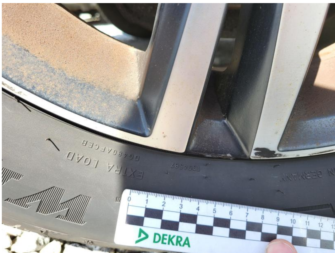
Fot. 49 Felga Aluminiowa przednia L - Rysa/odprysk 1
