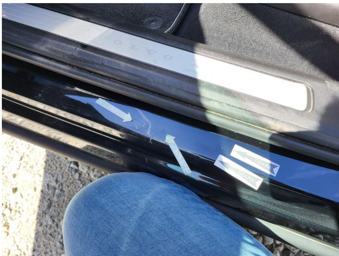
Fot. 48 Próg L - Wgniecenie/odkształcenie 1
