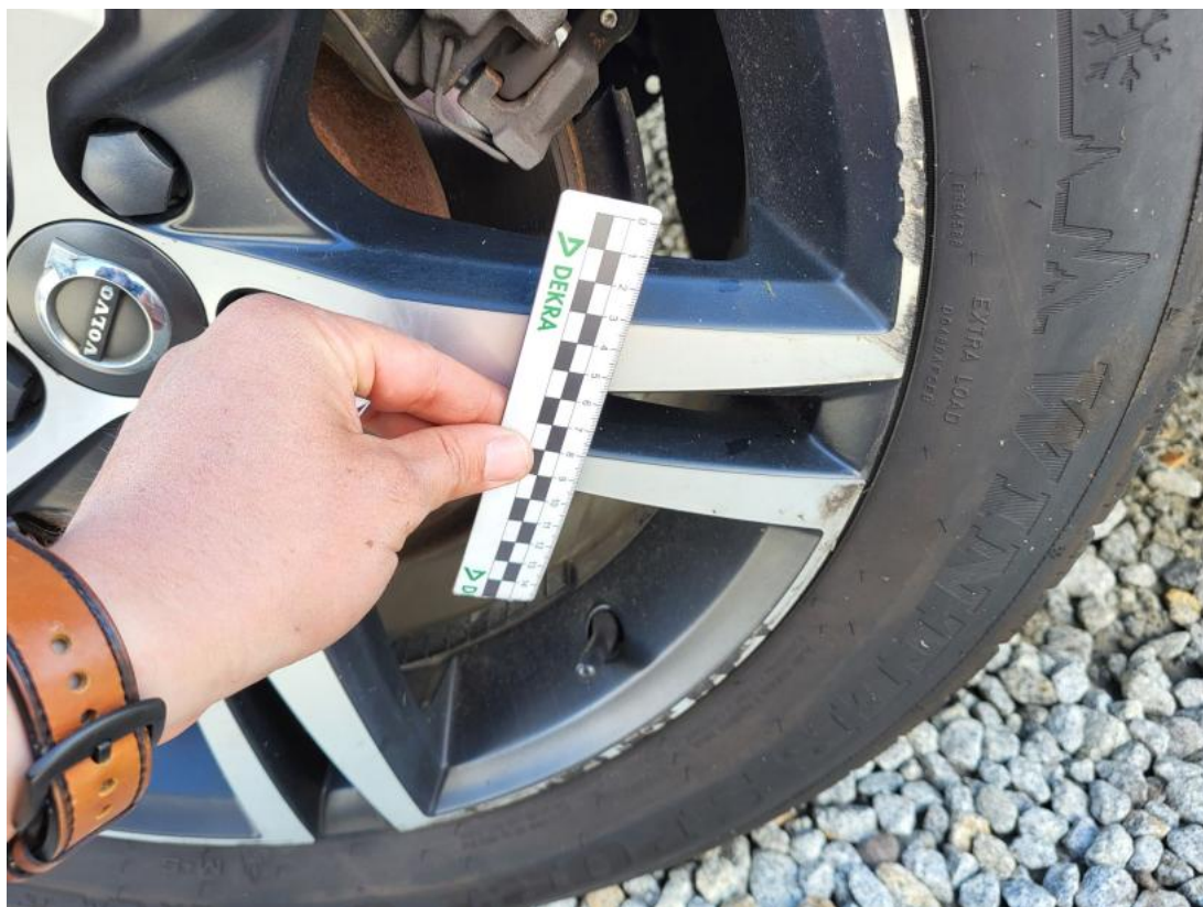
Fot. 43 Felga aluminiowa tylna P - Rysa/odprysk 1
