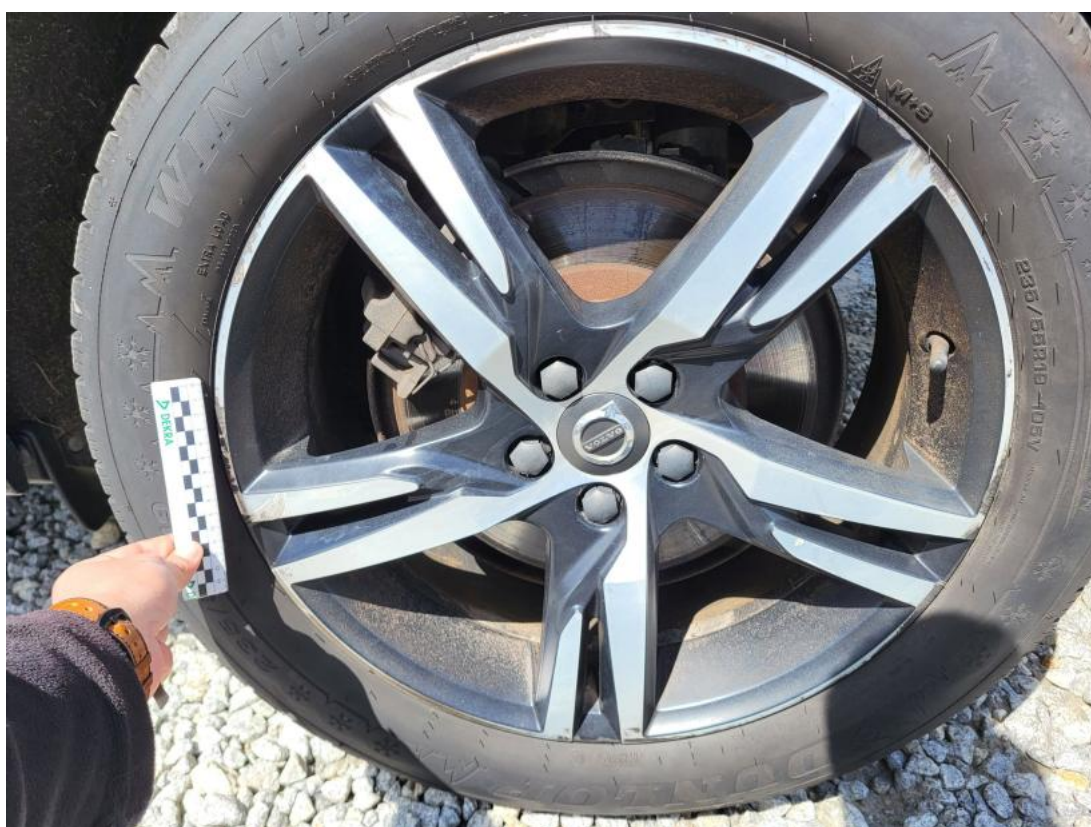
Fot. 46 Felga aluminiowa tylna L - Rysa/odprysk 2
