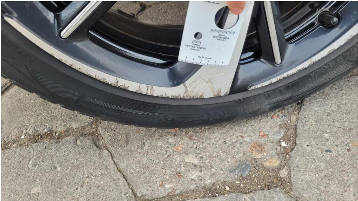
Fot. 41 Felga aluminiowa tylna P - Rysa/odprysk 1
