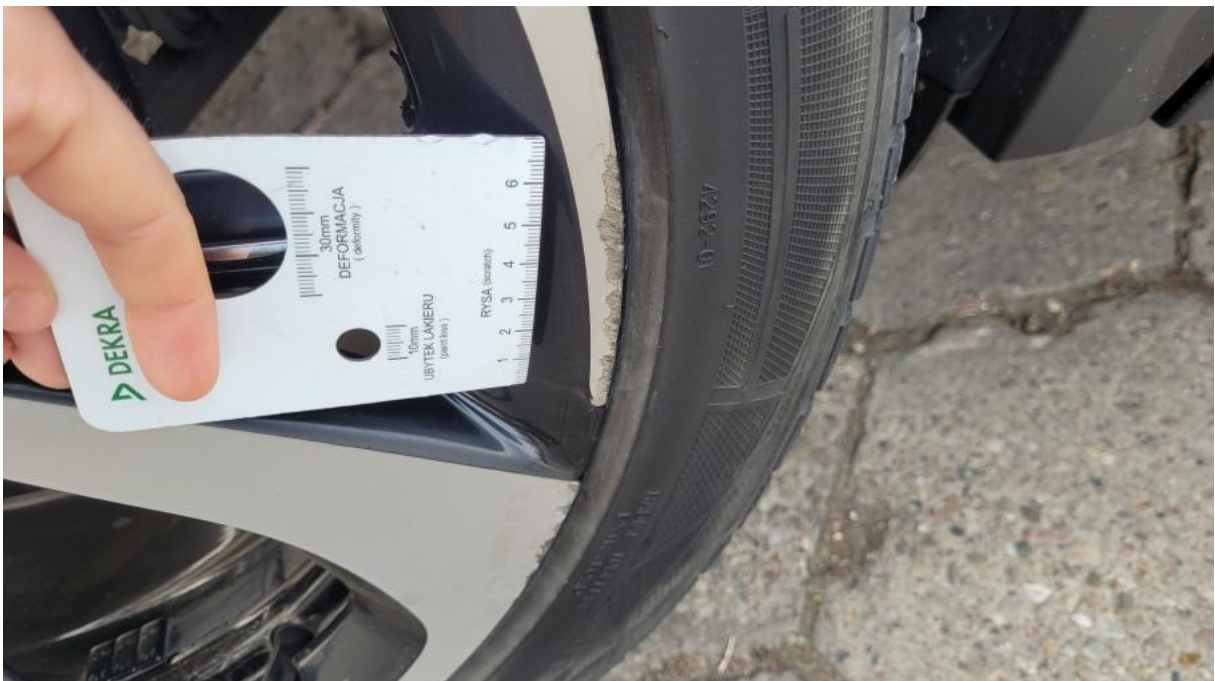
Fot. 42 Felga aluminiowa tylna P - Rysa/odprysk 2
