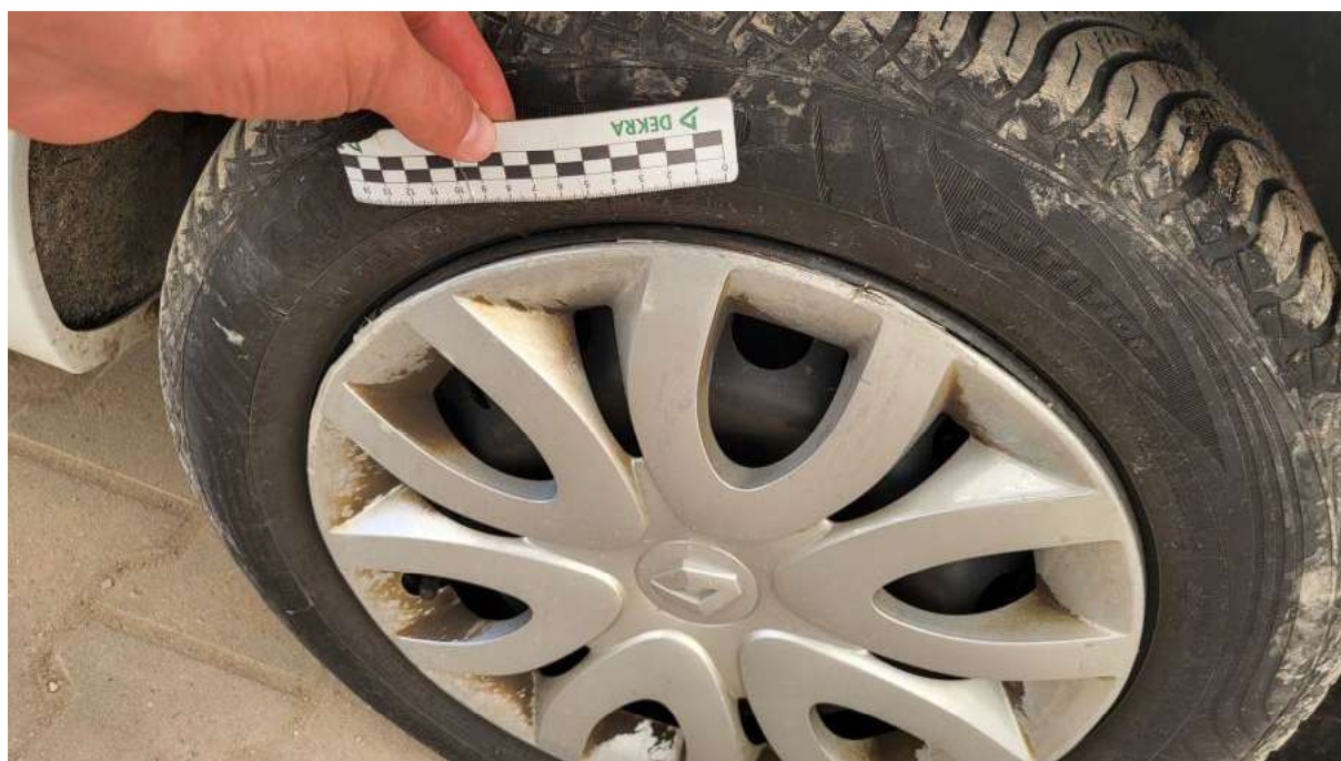
Fot. 32 Kołpak przedni P - Wgniecenie/odkształcenie 1
