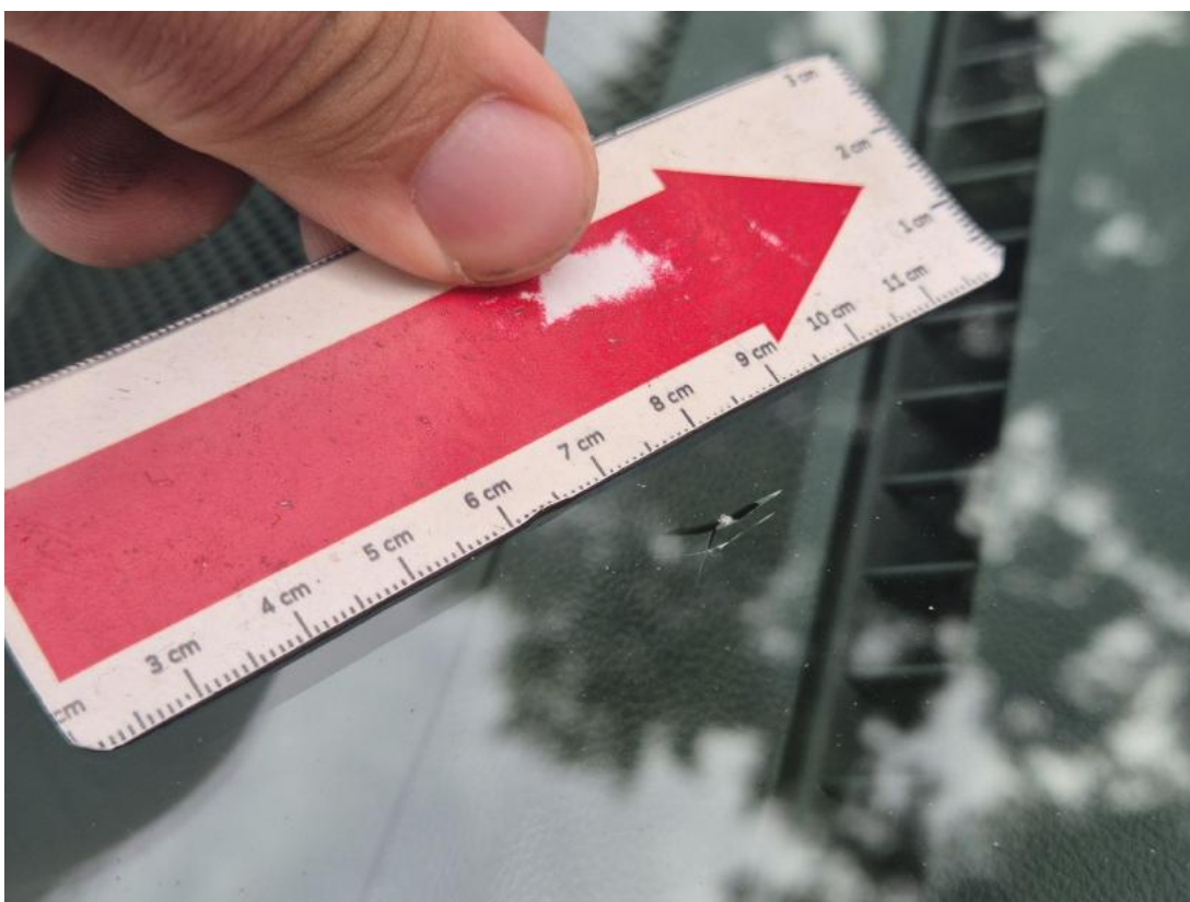
Fot. 38 Szyba czołowa - Pęknięcie/rozerwanie 1
