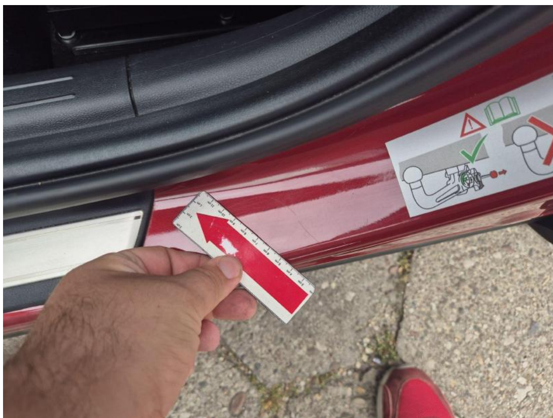
Fot. 61 Próg L - Rysa/odprysk 2
