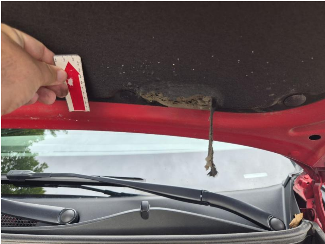
Fot. 39 Wykładzina pokrywy komory silnika - Pęknięcie/rozerwanie 1
