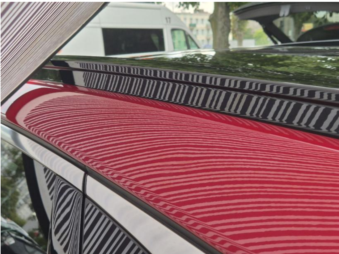
Fot. 50 Rama dachu L - Wgniecenie/odkształcenie 1
