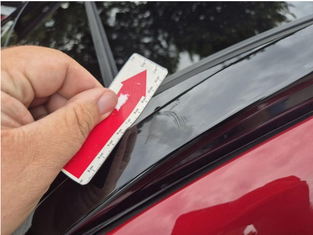
Fot. 49 Rama dachu L - Rysa/odprysk 1
