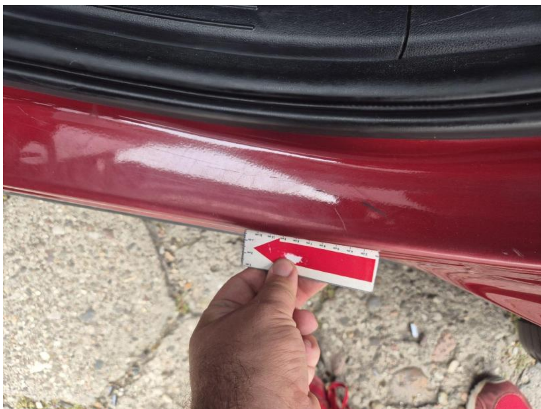
Fot. 60 Próg L - Rysa/odprysk 1
