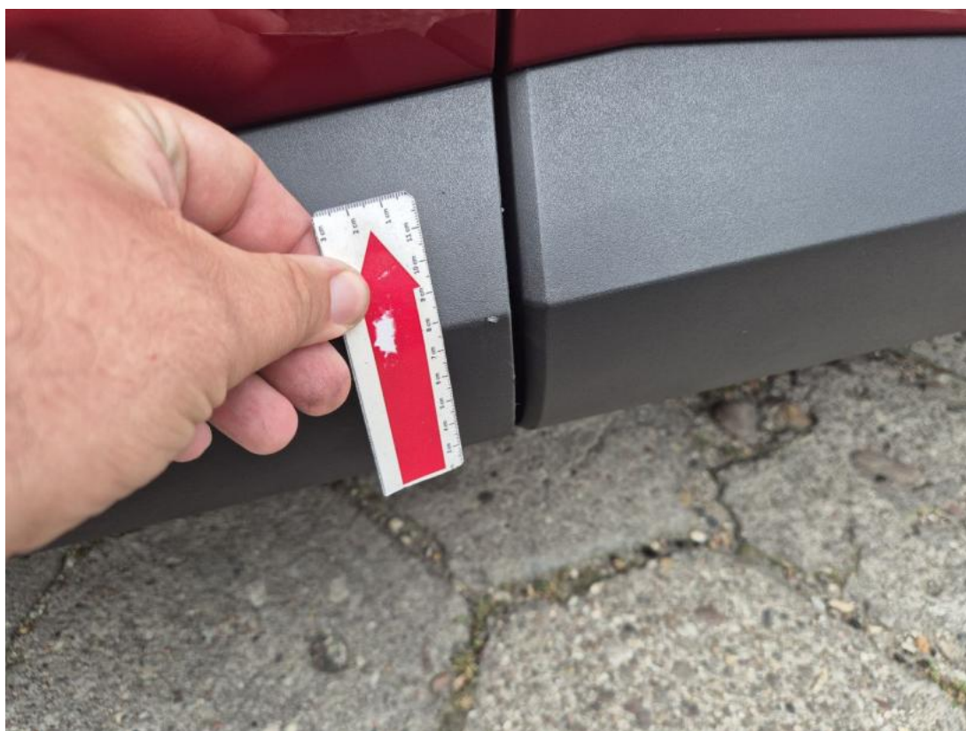
Fot. 52 Drzwi przed L - Rysa/odprysk 1
