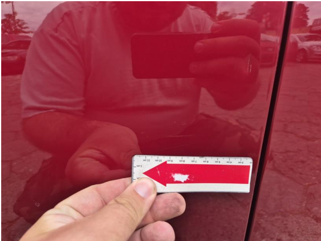
Fot. 53 Drzwi przed L - Rysa/odprysk 2
