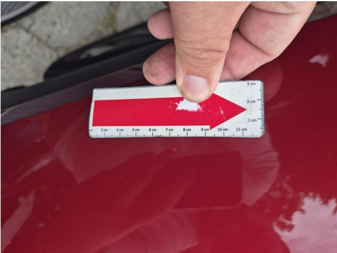
Fot. 41 Błotnik przedni P - Rysa/odprysk 1
