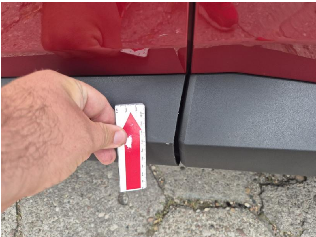
Fot. 54 Drzwi przed L() - Rysa/odprysk 3
