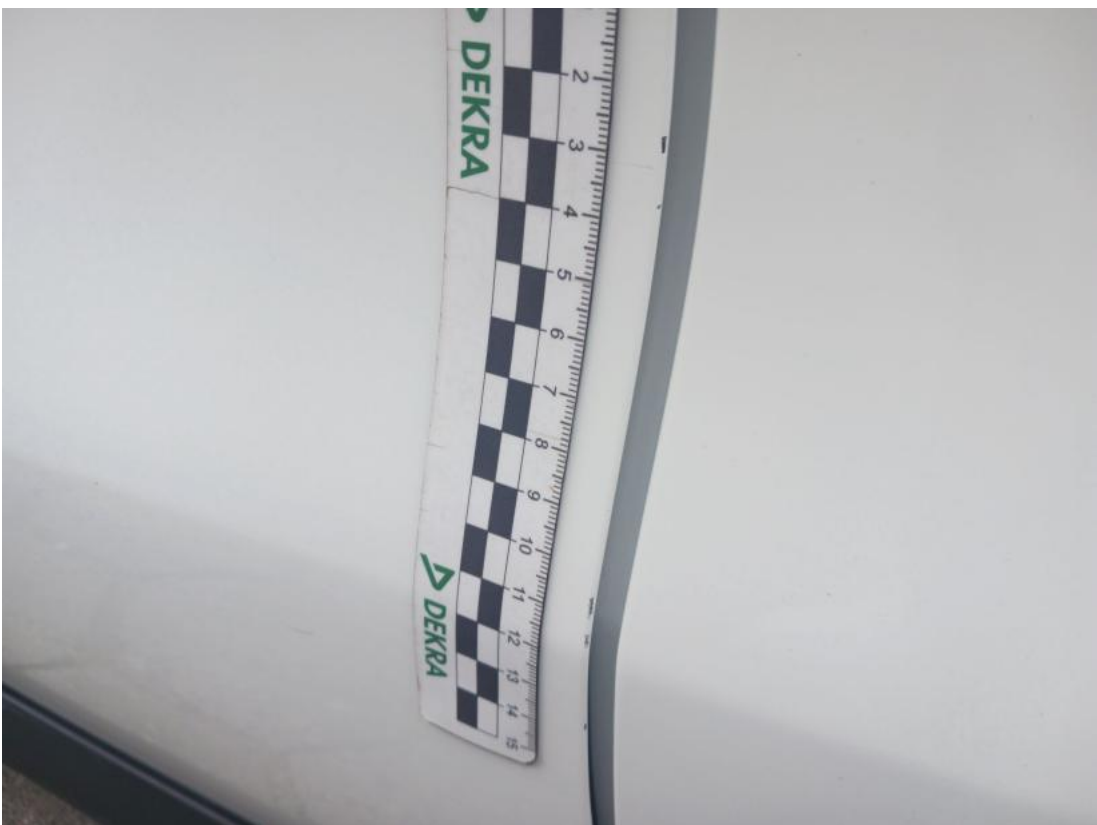
Fot. 38 Drzwi przed L - Rysa/odprysk 1
