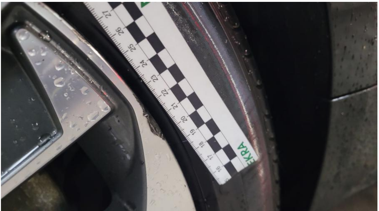
Fot. 38 Felga aluminiowa tylna P - Rysa/odprysk 2
