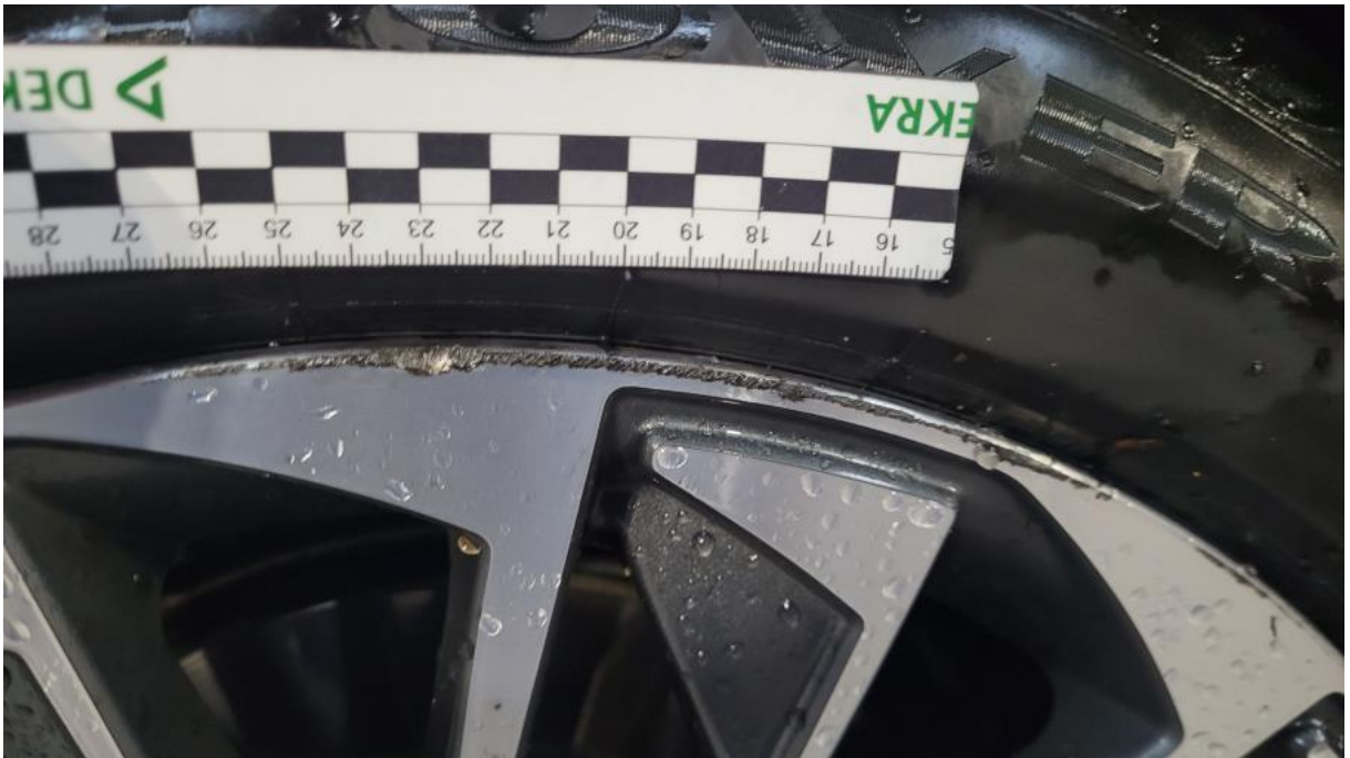
Fot. 37 Felga aluminiowa tylna P - Rysa/odprysk 1
