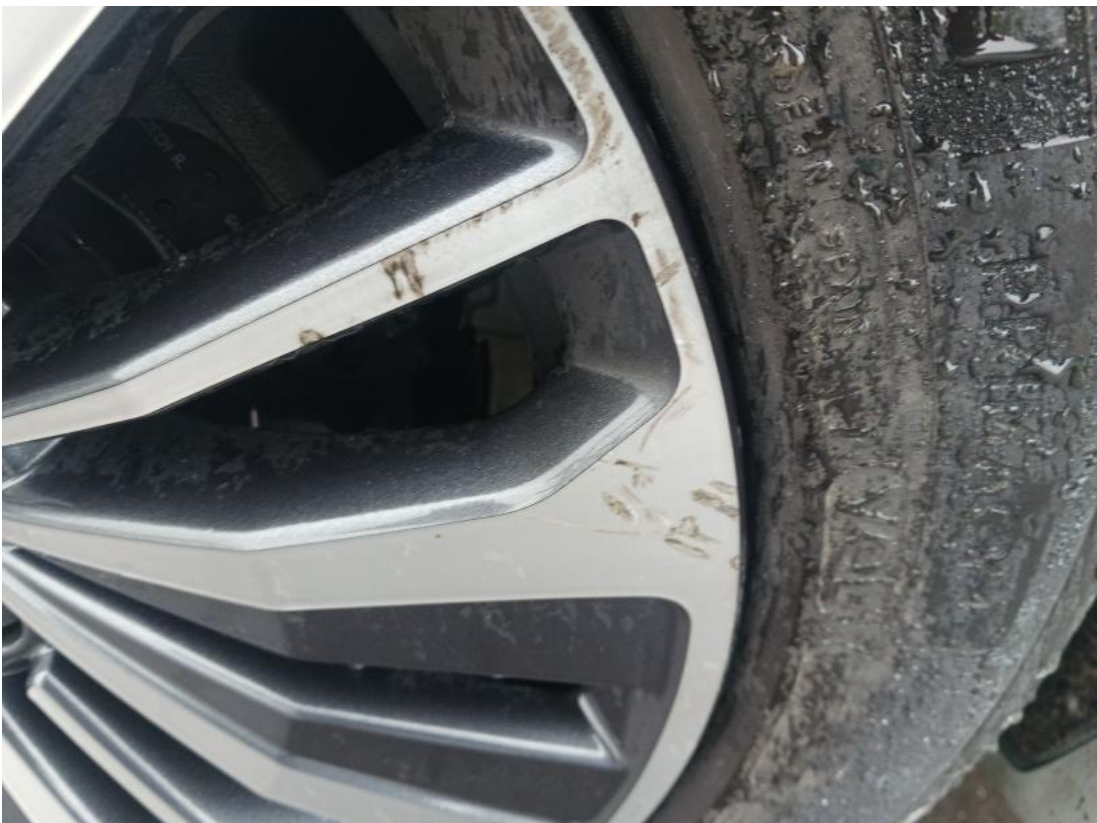
Fot. 42 Felga aluminiowa tylna P - Rysa/odprysk 1
