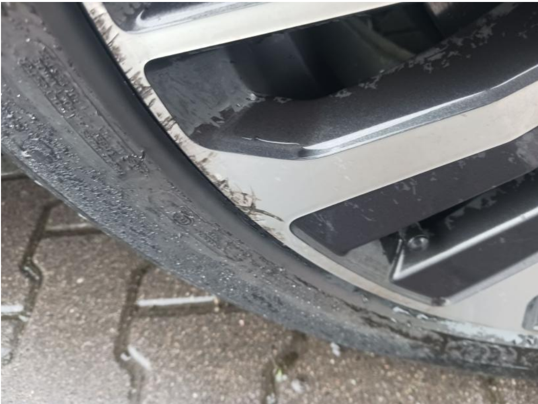
Fot. 41 Felga aluminiowa przednia P - Rysa/odprysk 2
