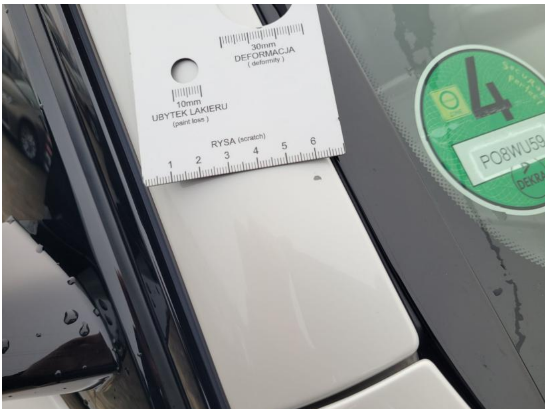
Fot. 40 Słupek przedni P - Rysa/odprysk 1
