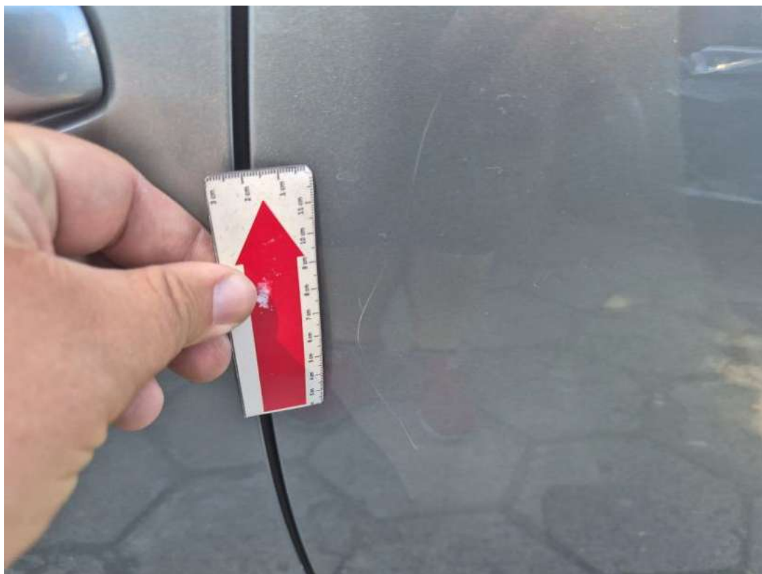
Fot. 51 Drzwi tylne L - Rysa/odprysk 2
