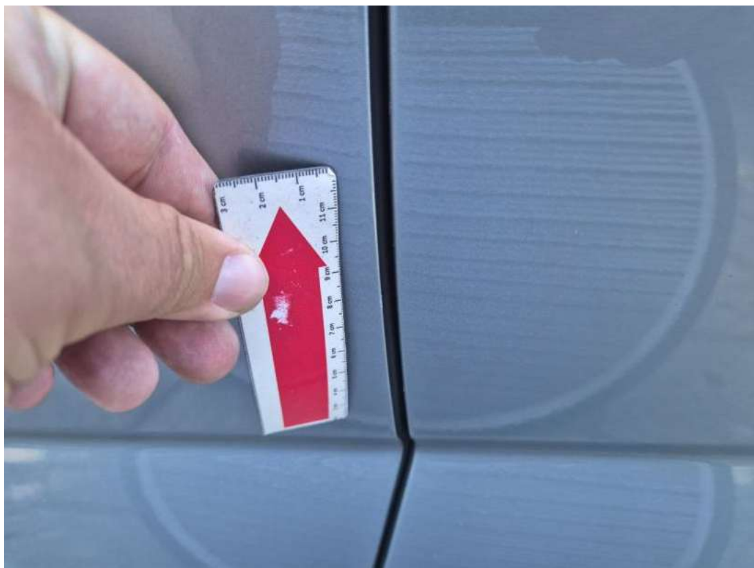
Fot. 49 Drzwi przed L - Rysa/odprysk 1
