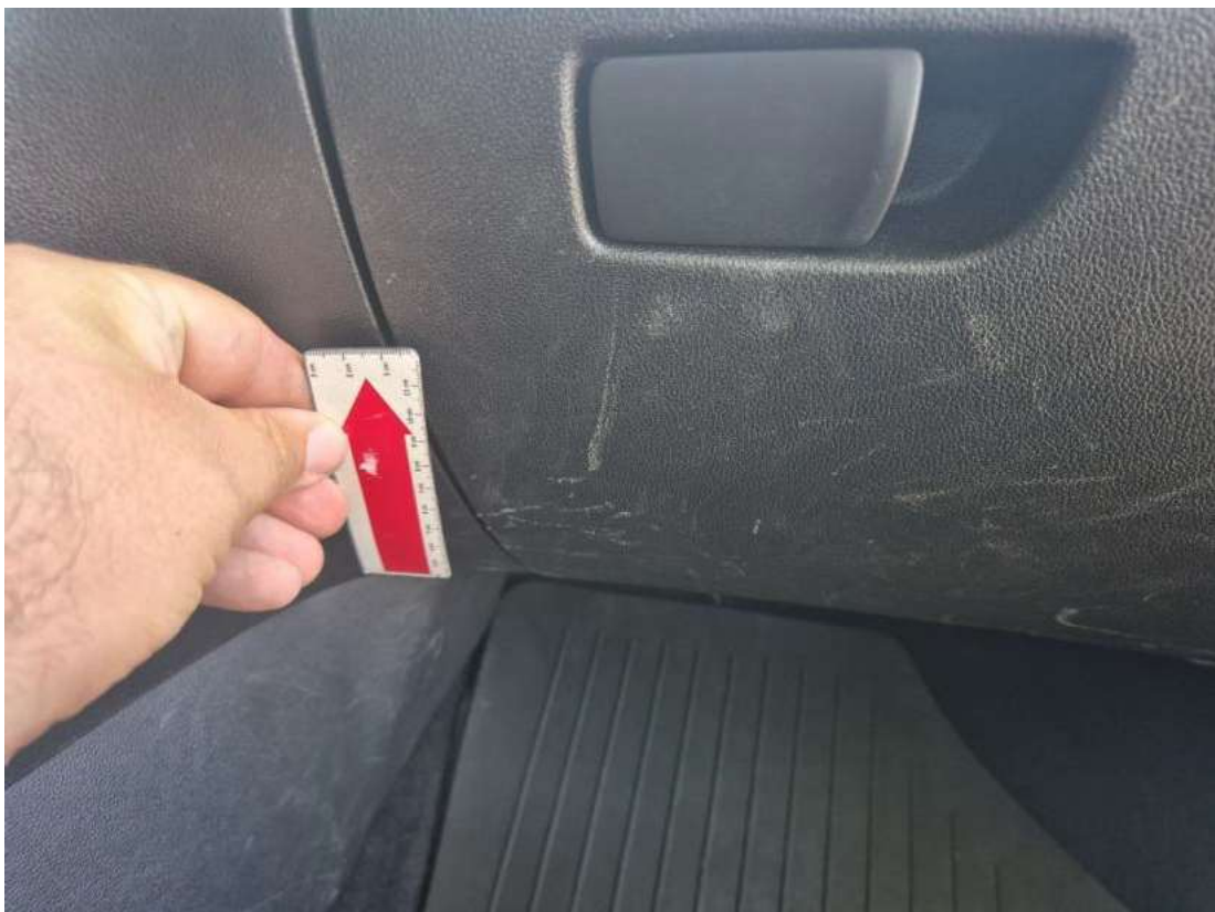
Fot. 54 Pokrywa schowka deski rozdź - Rysa/odprysk 1
