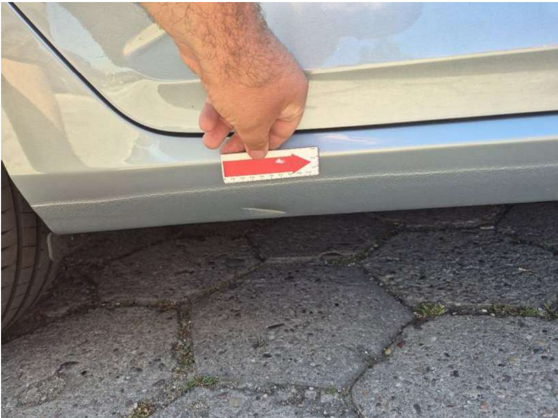
Fot. 39 Próg P - Rysa/odprysk 1
