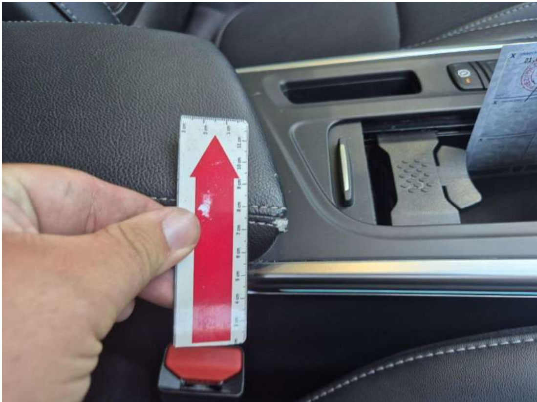
Fot. 53 Konsola tunelu śr. - Pęknięcie/rozerwanie 1
