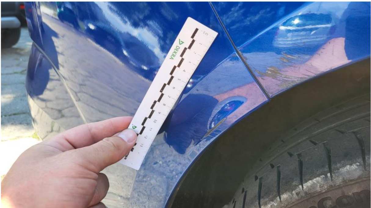
Fot. 40 Zderzak tylny - Rysa/odprysk 1
