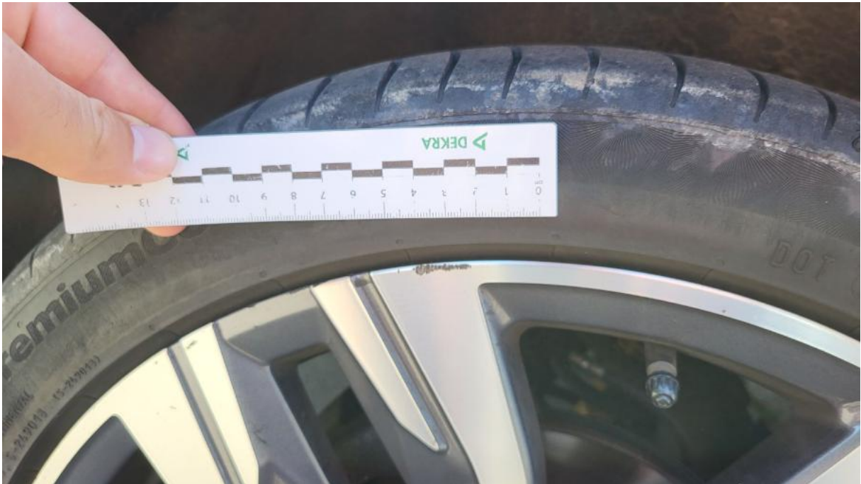
Fot. 39 Felga aluminiowa tylna P - Rysa/odprysk 1
