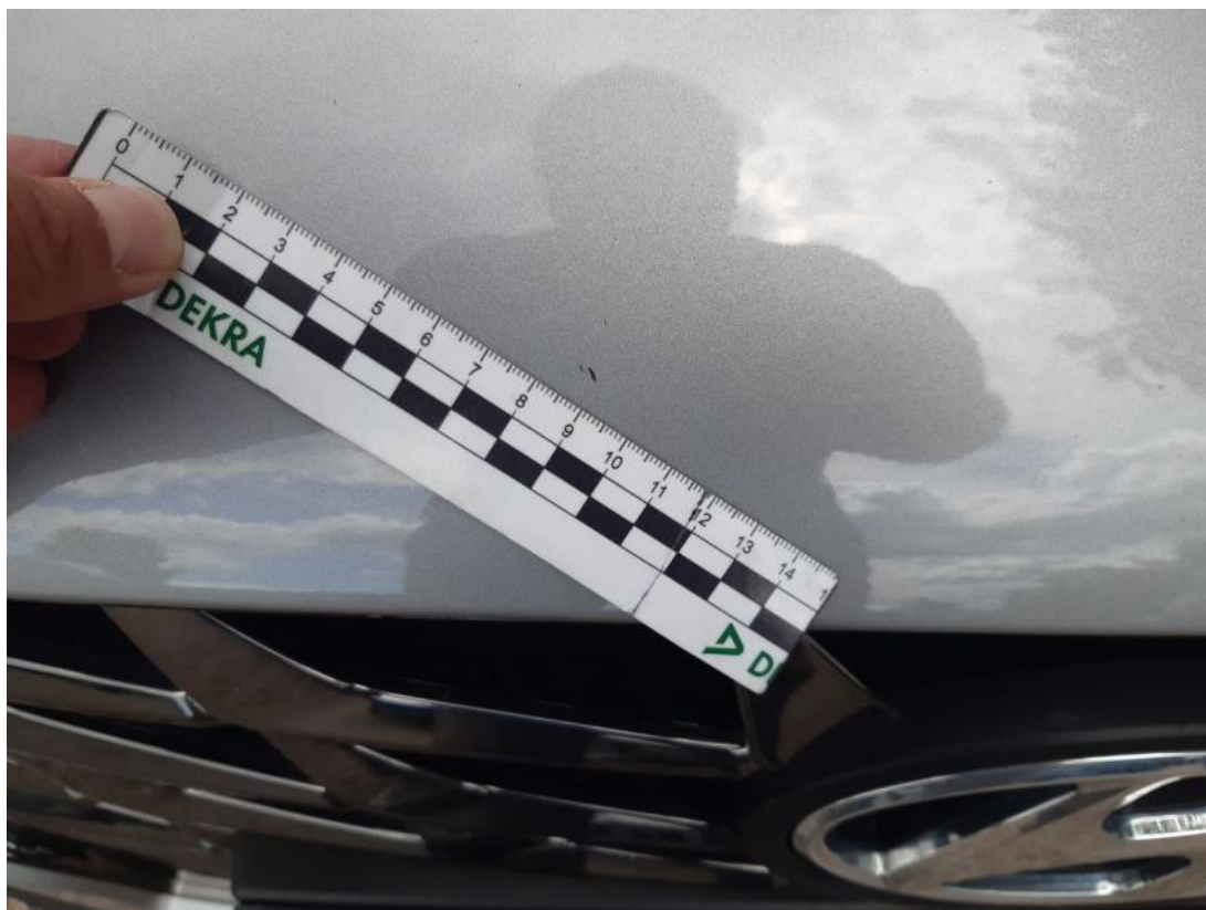
Fot. 41 Zderzak - Rysa/odprysk 2
