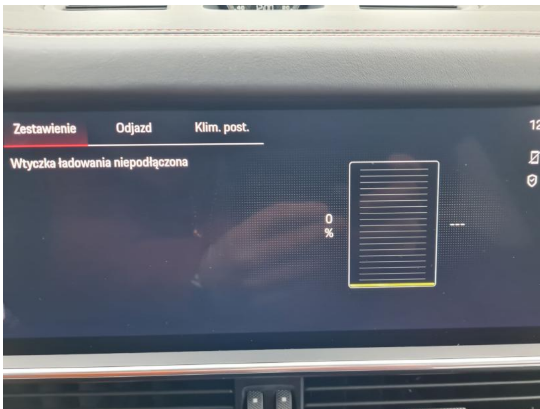
Fot. 16 Wskaźnik naładowania baterii trakcyjnej
