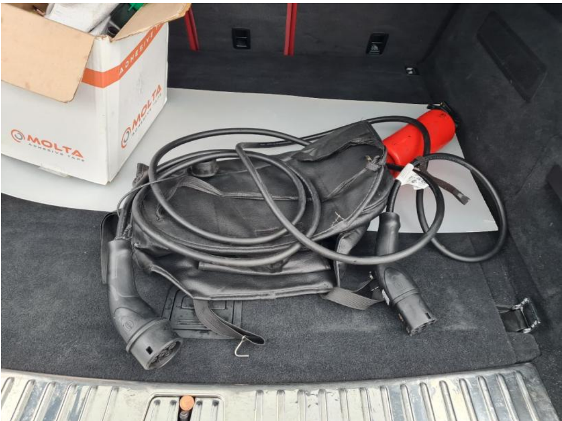
Fot. 28 Przewód ładowania baterii trakcyjnej
