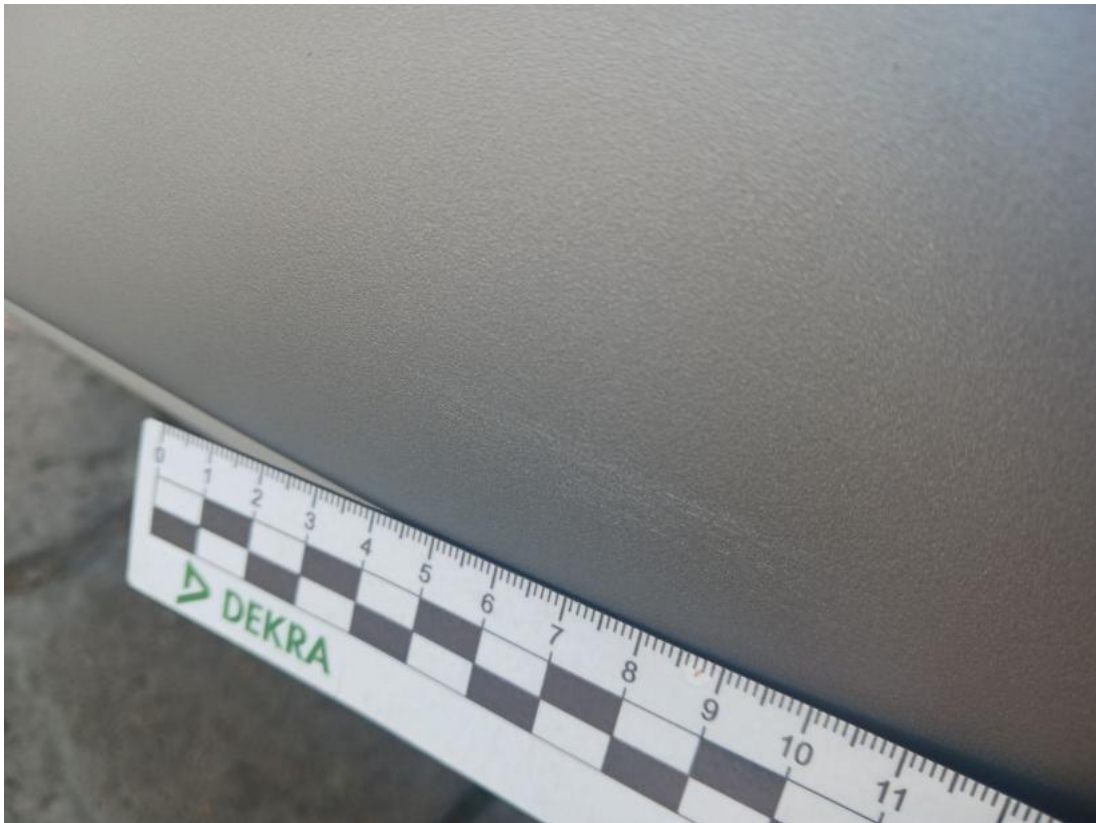
Fot. 47 Zderzak tylny cz śr - Rysa/odprysk 1
