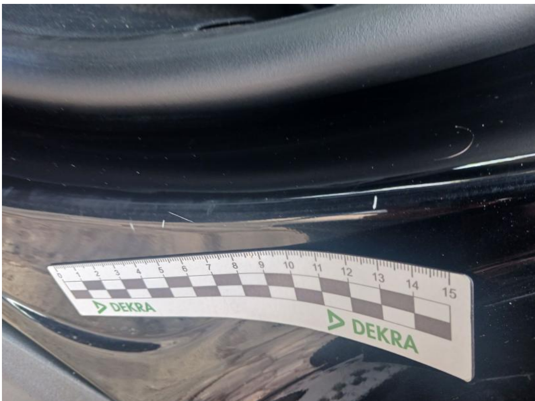
Fot. 50 Próg L - Rysa/odprysk 1
