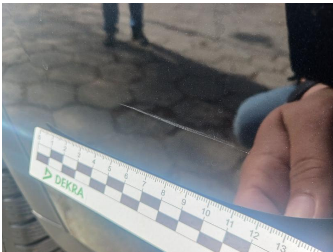
Fot. 45 Zderzak tylny cz L - Rysa/odprysk 1
