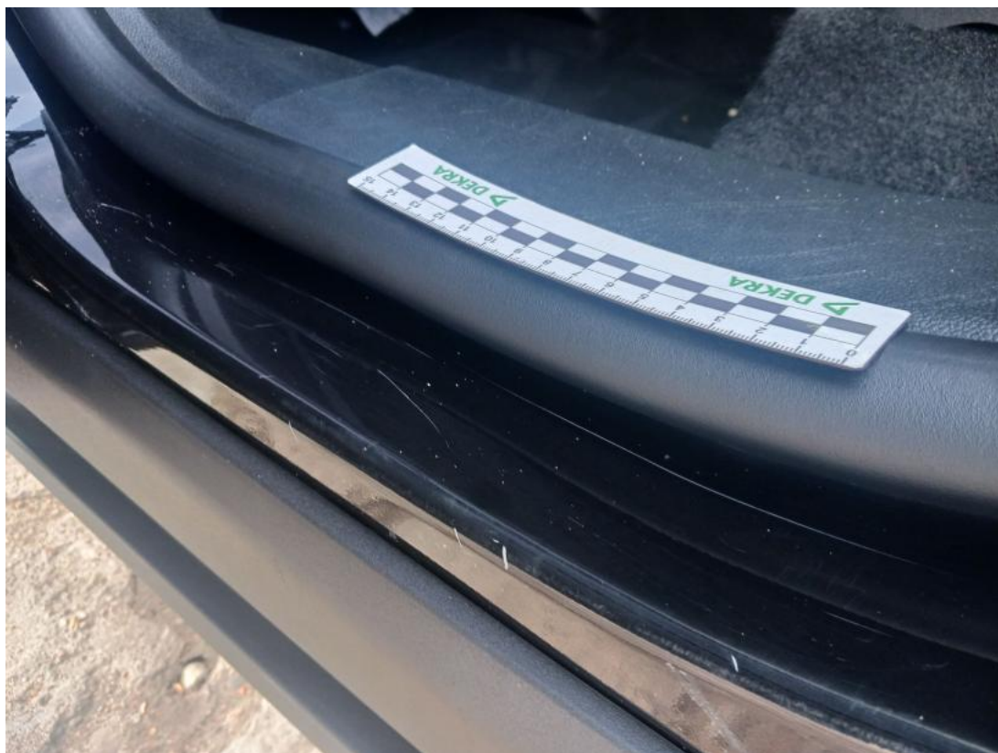
Fot. 51 Próg L - Rysa/odprysk 2
