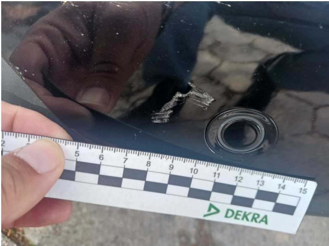
Fot. 41 Zderzak przedni cz L - Rysa/odprysk 1
