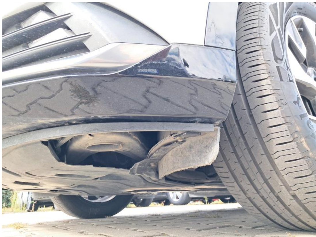
Fot. 40 Osłona dolna silnika - Pęknięcie/rozerwanie 1
