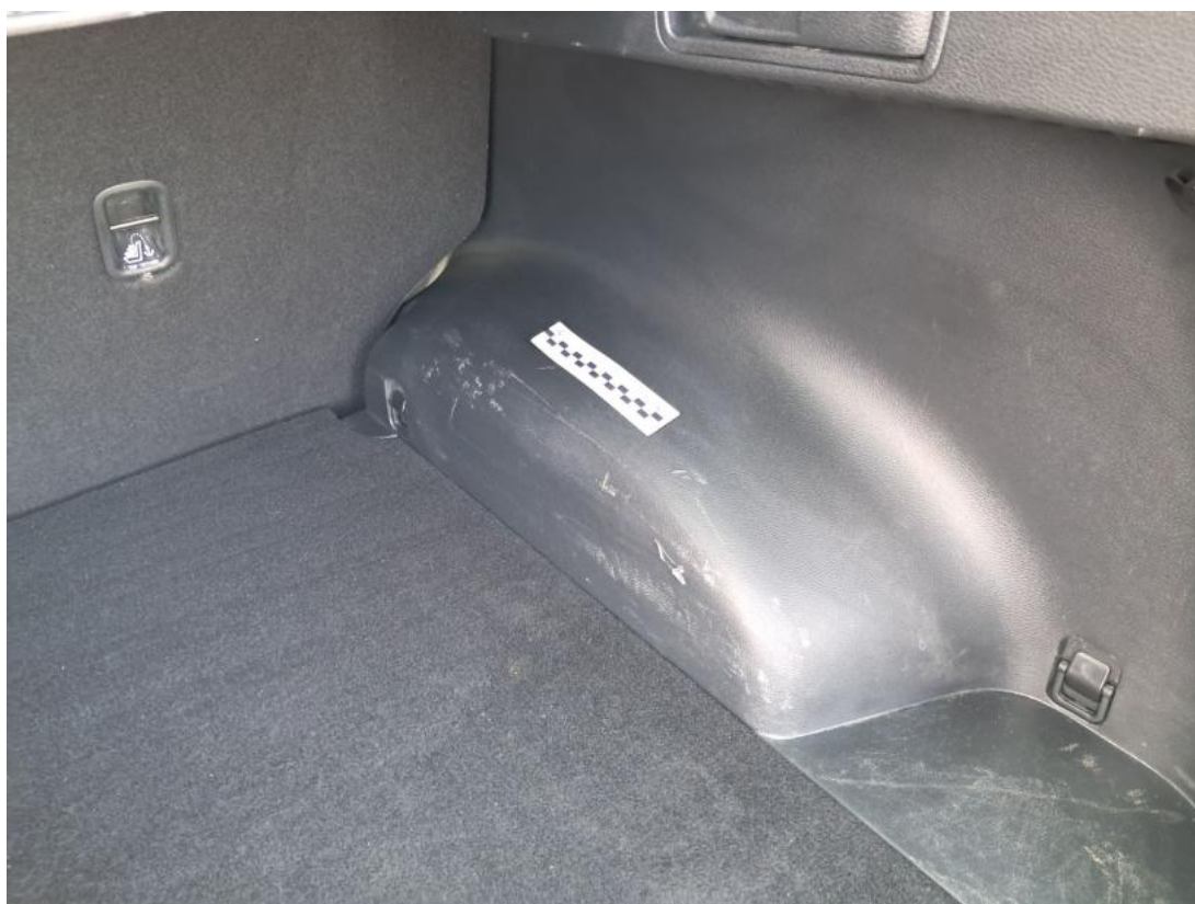
Fot. 43 Wykładzina przestrzeni bagażowej - Rysa/odprysk 1
