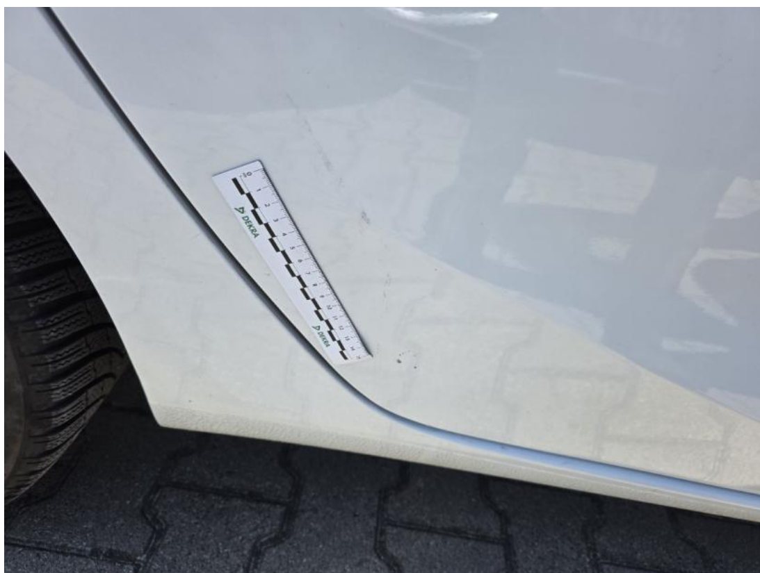
Fot. 44 Drzwi tylne P - Rysa/odprysk 2
