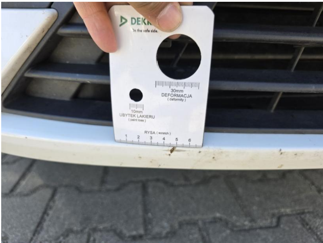
Fot. 39 Zderzak - Rysa/odprysk 1
