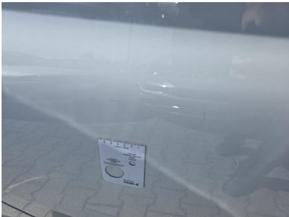
Fot. 43 Drzwi tylne P - Rysa/odprysk 1
