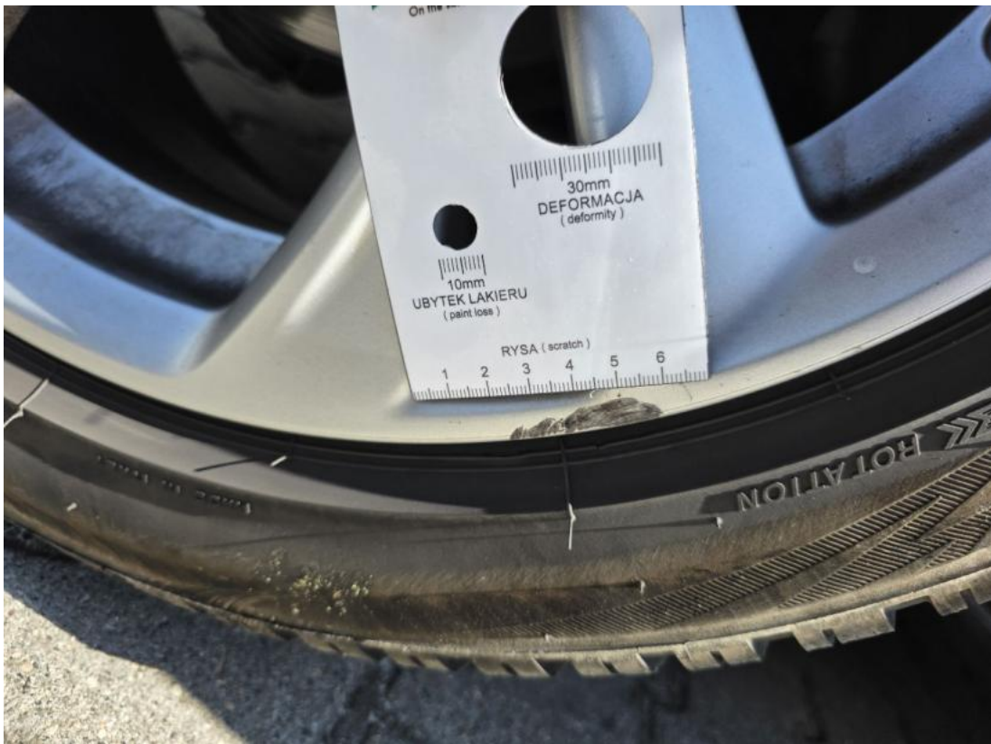
Fot. 51 Felga Aluminiowa przednia L() - Rysa/odprysk 3
