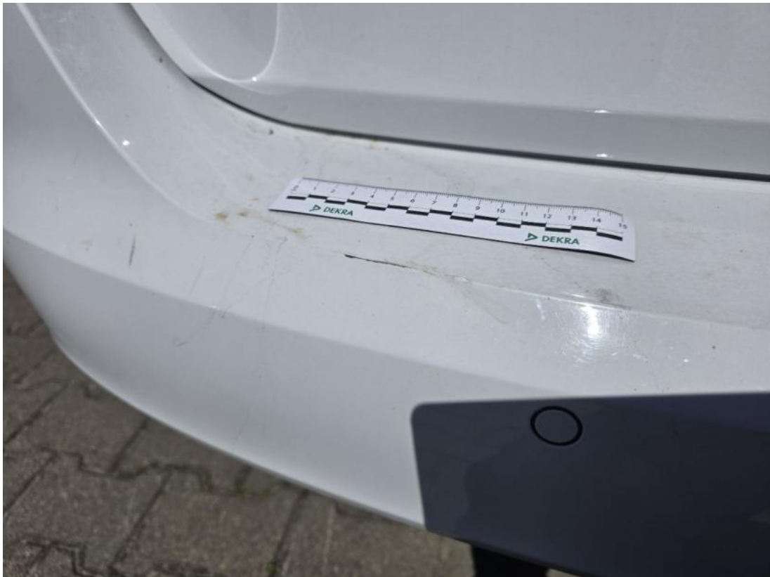
Fot. 47 Zderzak tylny - Pęknięcie/rozerwanie 1
