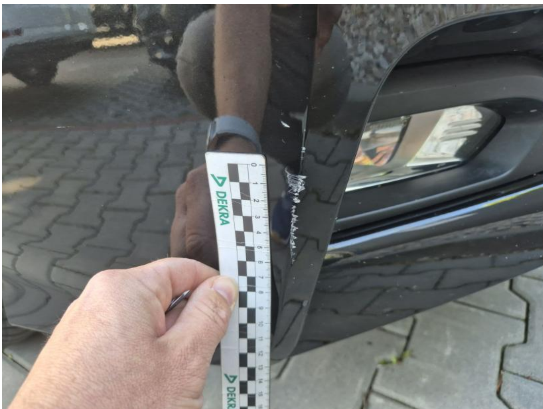
Fot. 36 Zderzak - Rysa/odprysk 1
