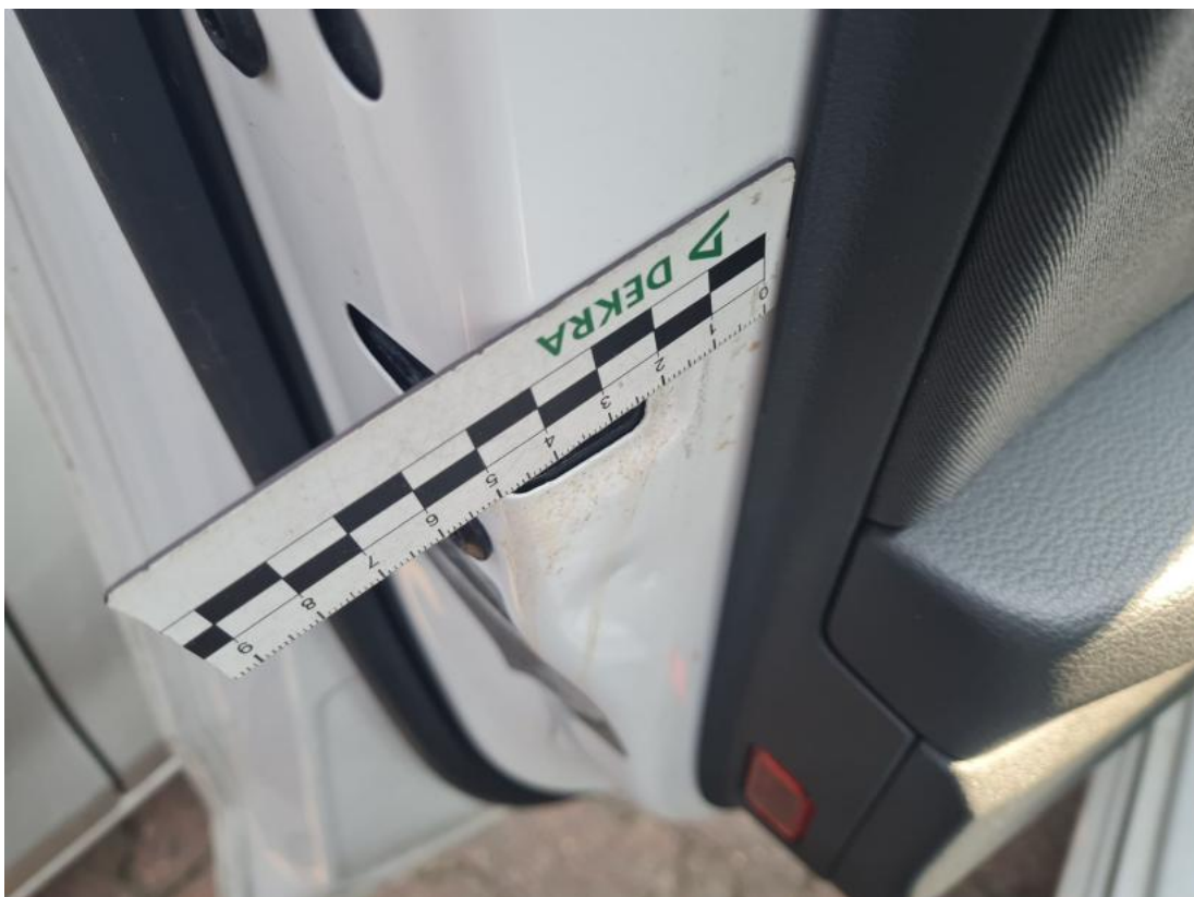
Fot. 60 Drzwi przed L - Wgniecenie/odkształcenie 1
