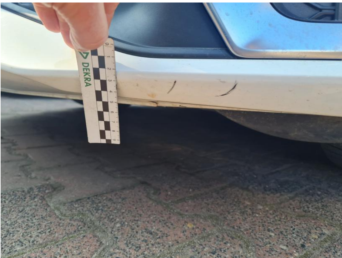
Fot. 44 Zderzak() - Rysa/odprysk 3
