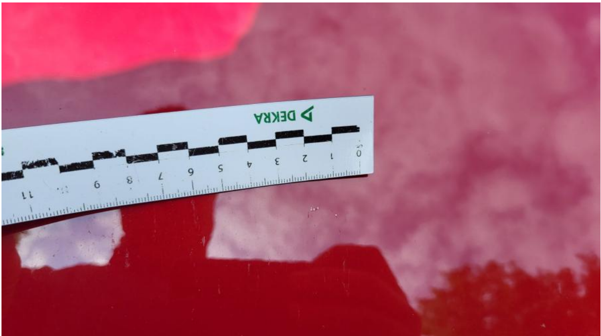
Fot. 32 Pokrywa komory silnika - Rysa/odprysk 1
